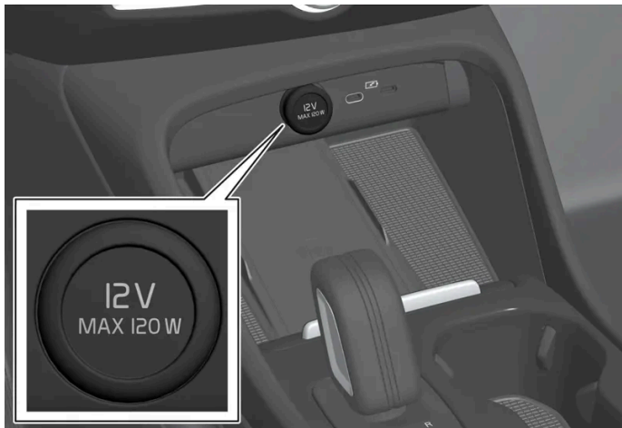
12-V-Steckdose in der Tunnelkonsole, vorn.
