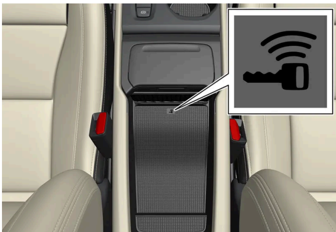
Lage des Schlüssellesegeräts an der Tunnelkonsole.
