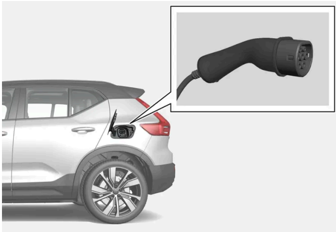
Ladestutzen und Ladebuchse.
