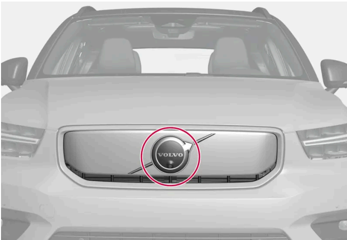
Lage des vorderen Radarmoduls
