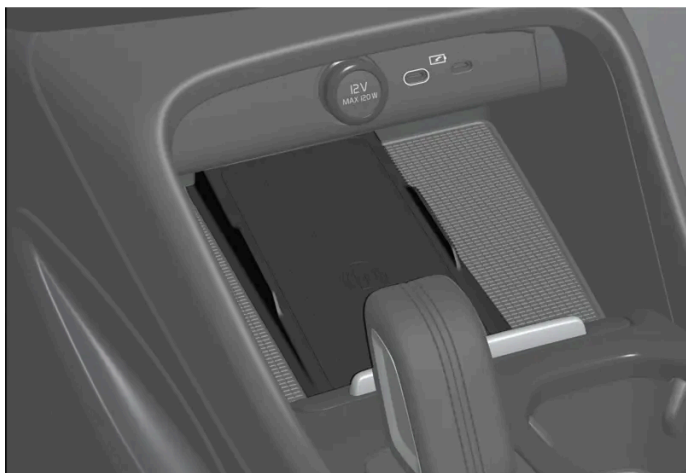
Induktives Ladesystem vor dem Schalt-/Wählhebel
