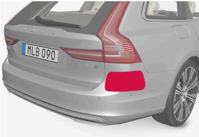
Lage der hinteren Radarmodule
