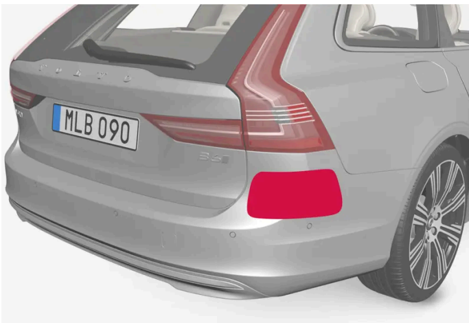
Lage der hinteren Radarmodule
