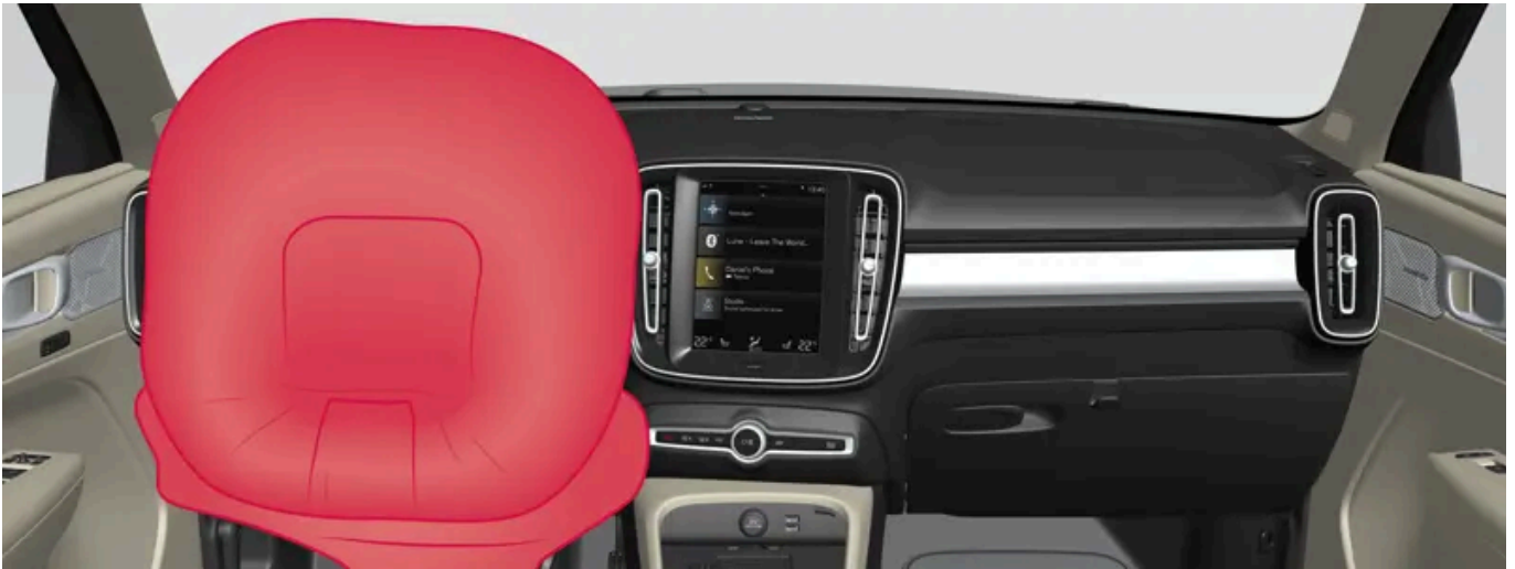
Lenkrad-Airbag und Knie-Airbag [1] am Fahrersitz.
