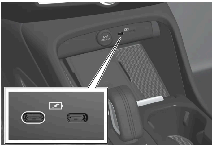
USB-Anschlüsse (Typ C), Vordersitz.
