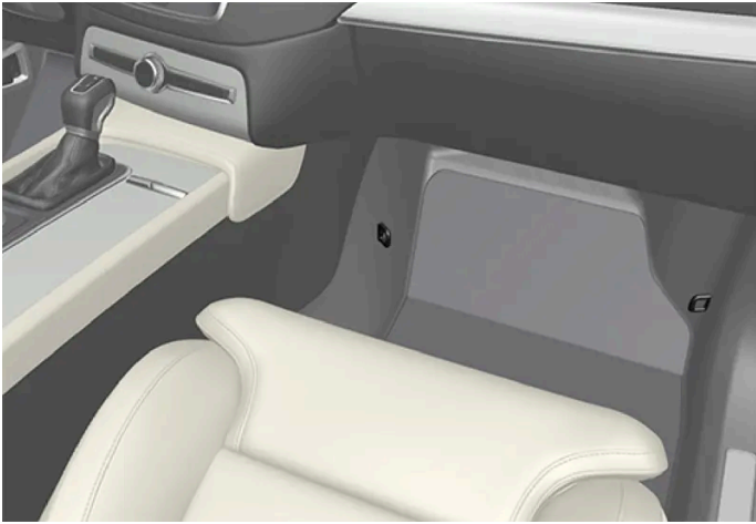
Lage der Befestigungspunkte für den Vordersitz
