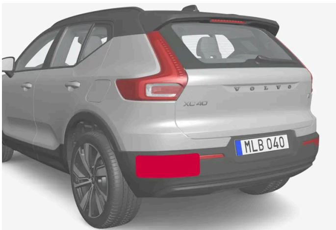
Platzierung der hinteren Radareinheiten
