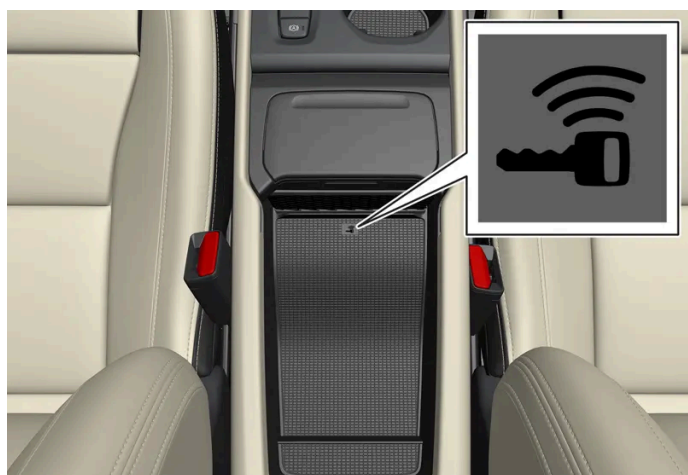
Lage des Schlüssellesegeräts an der Tunnelkonsole.
