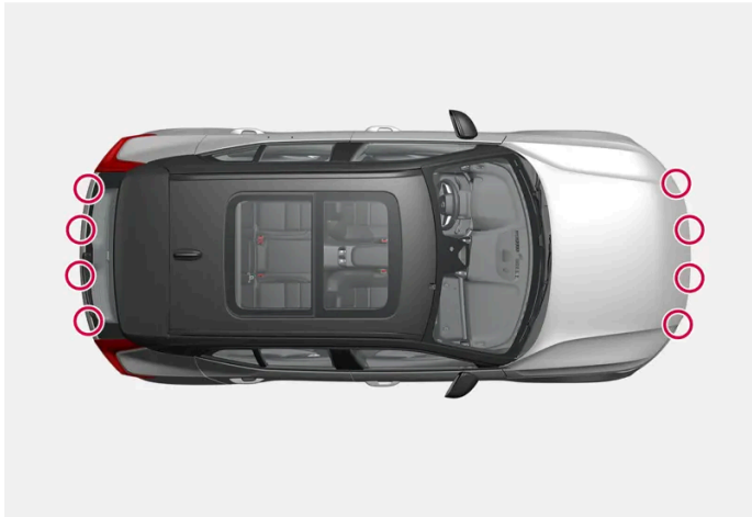
Lage der Einparkhilfesensoren rund um das Fahrzeug
