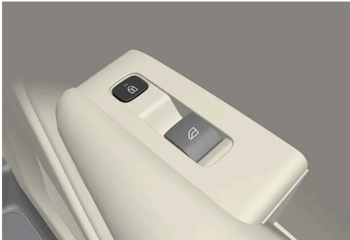
Verriegelungstaste mit Anzeigeleuchte an der Hintertür.
