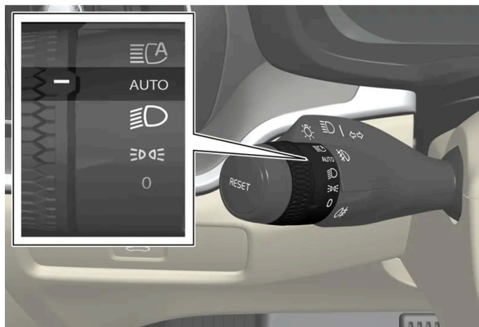
Drehring am Lenkradhebel in Stellung AUTO .
