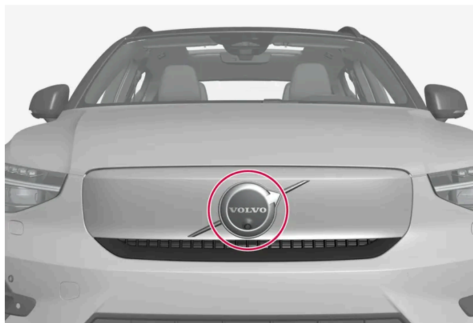
Lage des vorderen Radarmoduls
