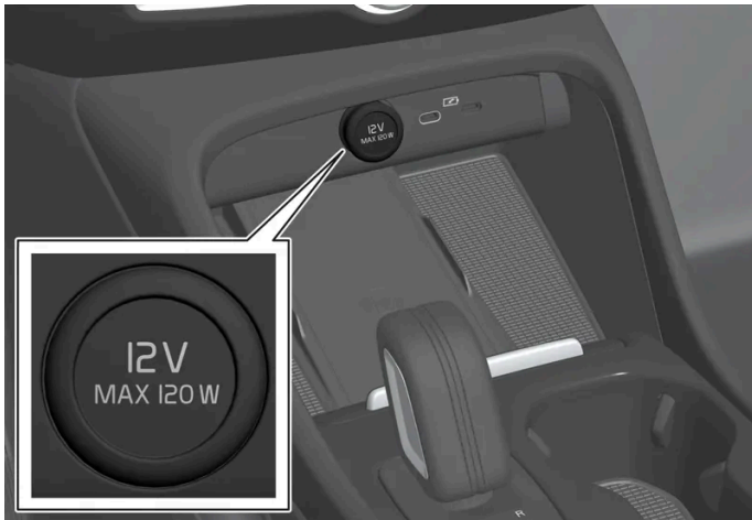
12-V-Steckdose in der Tunnelkonsole, vorn.
