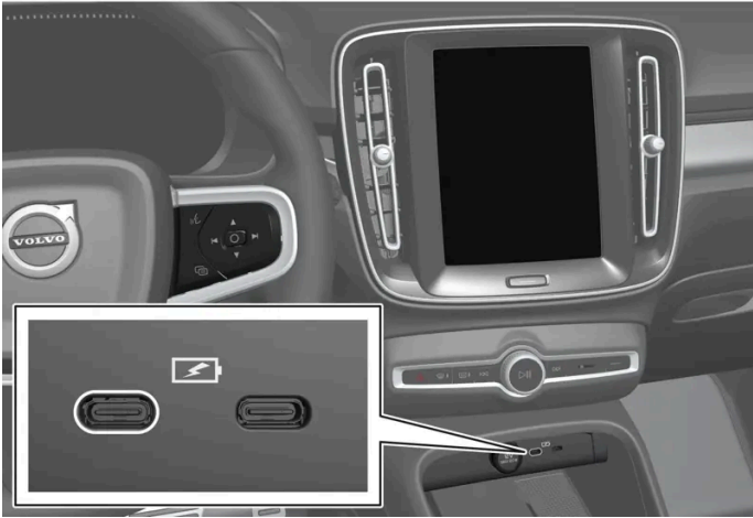
USB-Anschlüsse zum Aufladen von Geräten.
