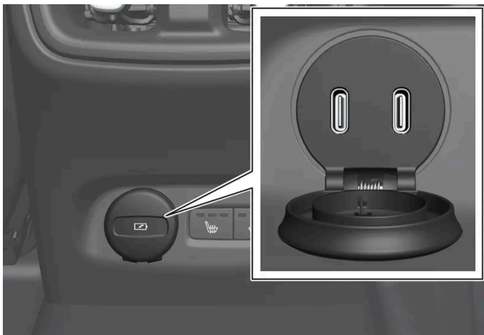
USB-Anschlüsse (Typ C) in der Tunnelkonsole, Fond.
