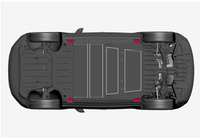
Ansatzpunkte des Fahrzeugs zum Anheben mit einem Wagenheber.
