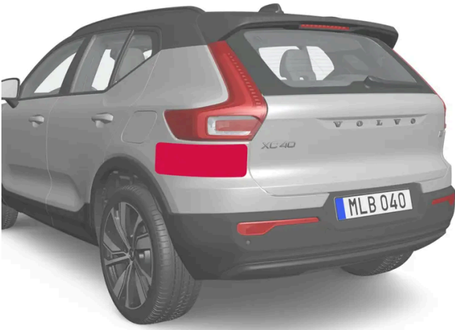
Lage der hinteren Radarmodule
