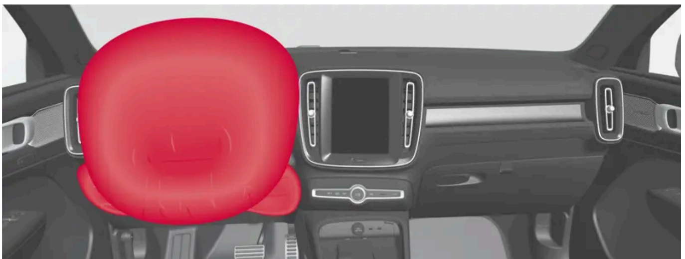
Lenkrad-Airbag und Knie-Airbag [1] am Fahrersitz.
