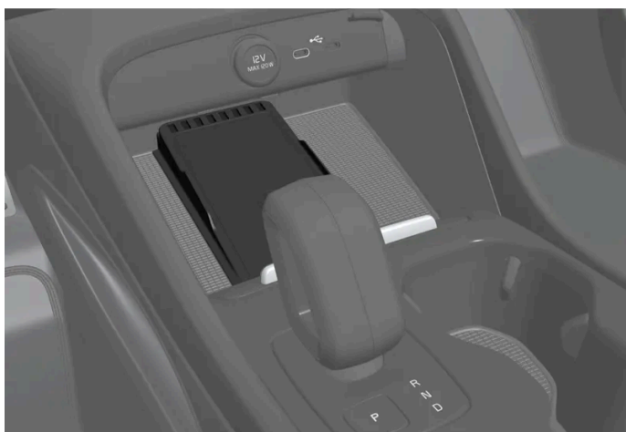
Induktives Ladesystem unter dem Center Display.
