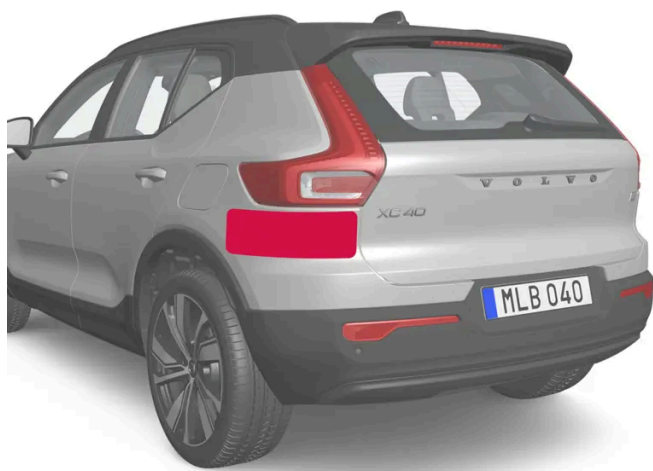
Lage der hinteren Radarmodule
