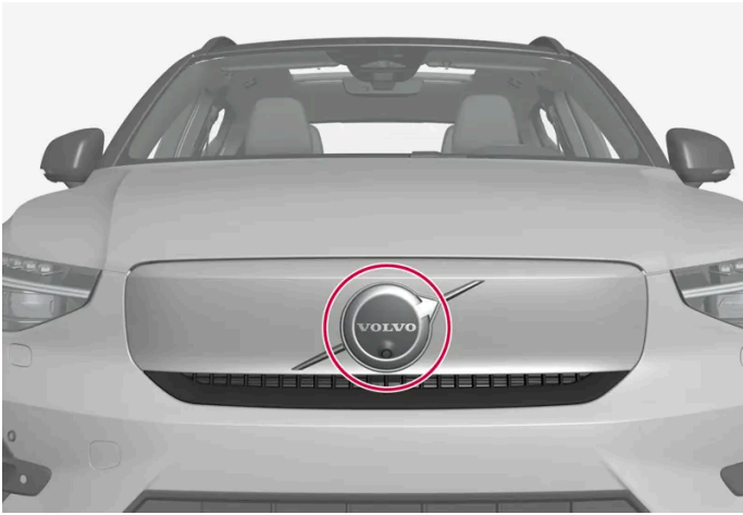
Lage des vorderen Radarmoduls
