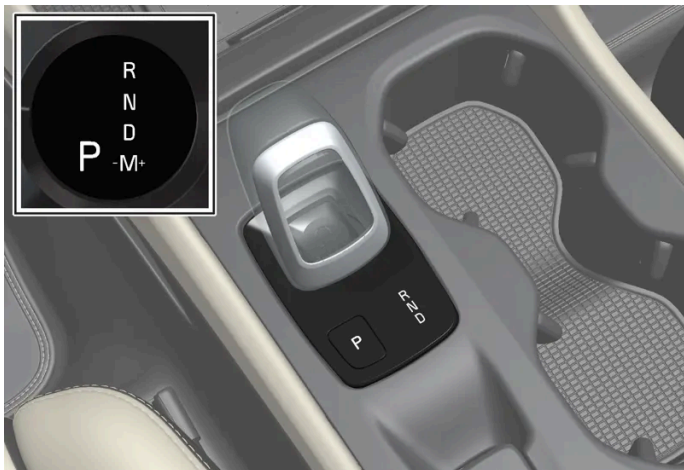
Wählhebel und Schaltmuster auf dem Fahrerdisplay.
