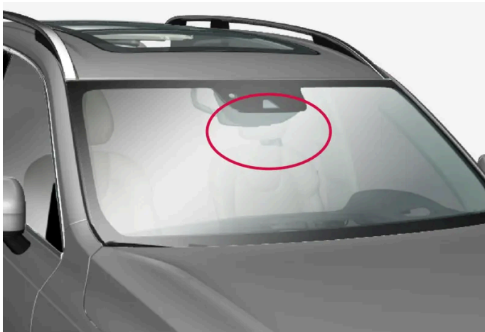
Anordnung der vorderen Kamera- und Radareinheit
