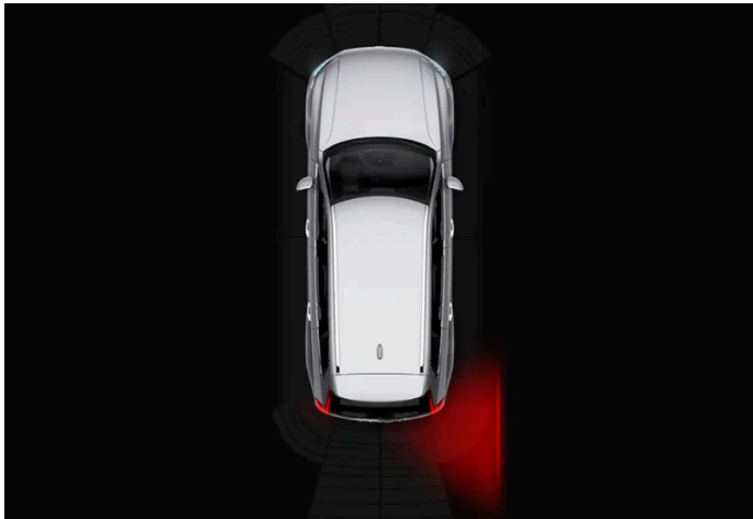
Leuchtendes Cross Traffic Alert-Symbol in der Park-Assistent -Grafik auf dem Display.
