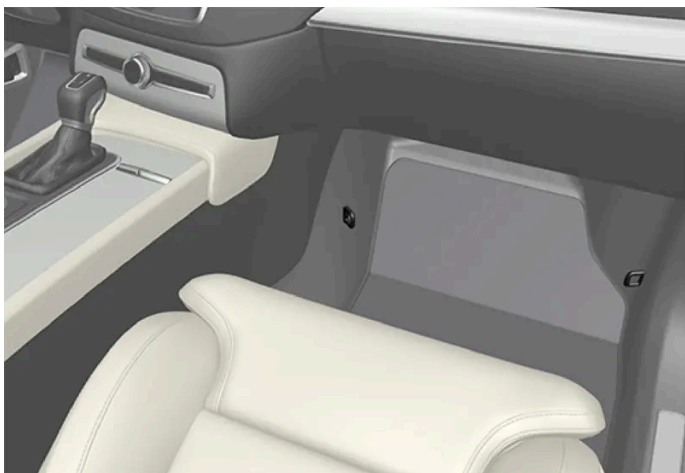
Lage der Befestigungspunkte für den Vordersitz
