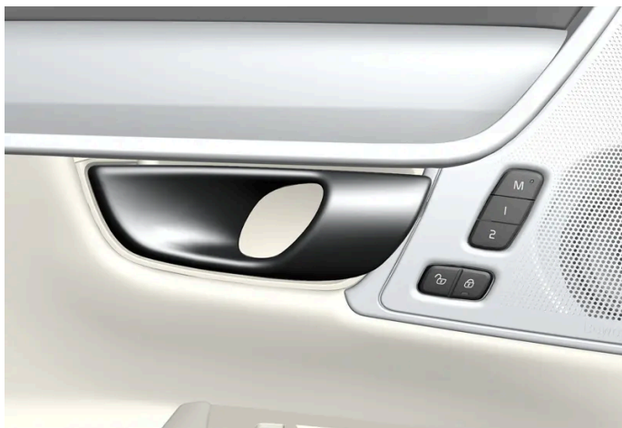
Griff zum alternativen Entriegeln der Tür [1] .
