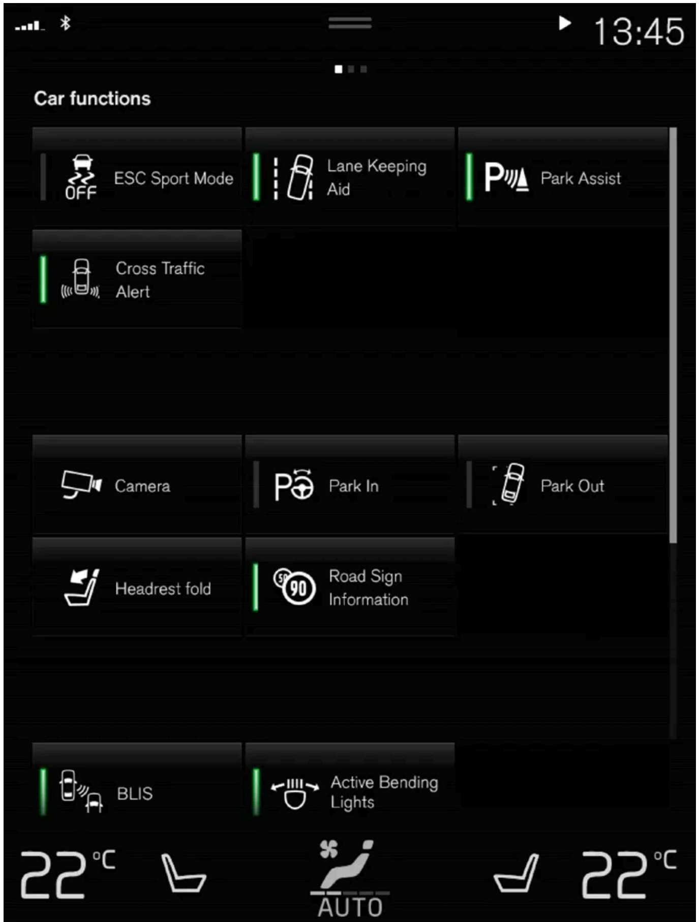
Ansicht Funktionen mit Tasten für verschiedene Fahrzeugfunktionen.
