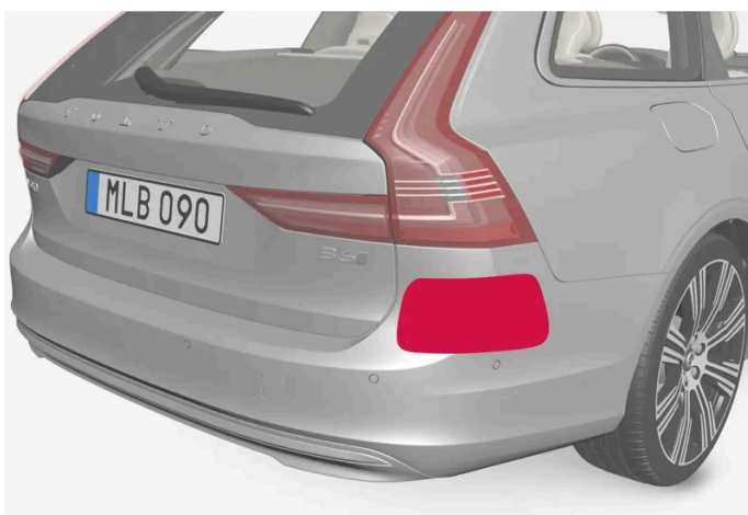
Platzierung der hinteren Radareinheiten
