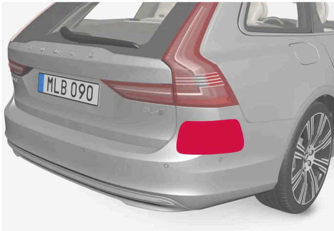
Platzierung der hinteren Radareinheiten
