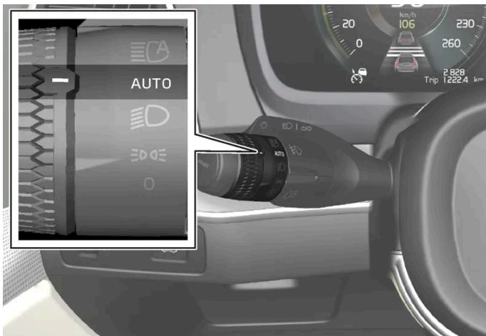
Drehring am Lenkradhebel in Stellung AUTO .
