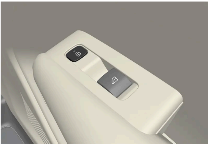
Verriegelungstaste mit Anzeigeleuchte an der Fondtür.
