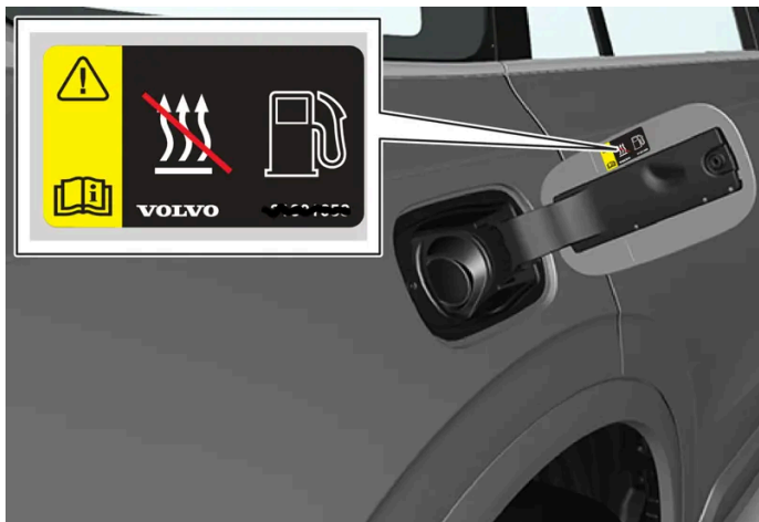
Warnaufkleber auf der Kraftstofftankklappe.
