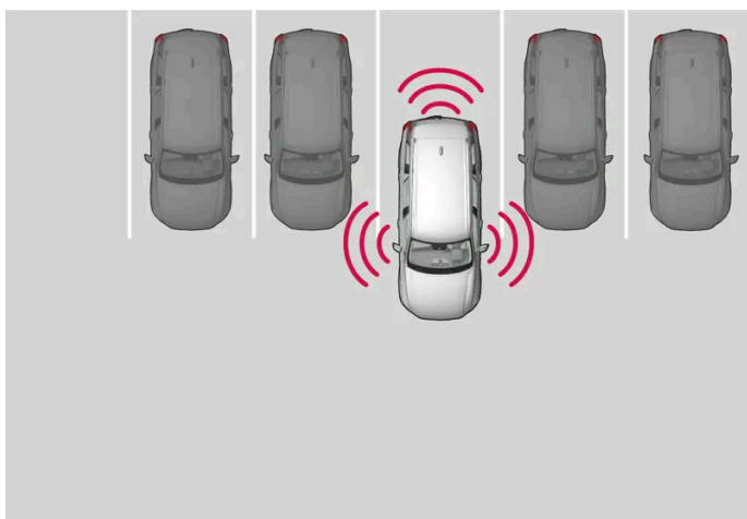
Prinzip zur Positionierung beim Quereinparken.
