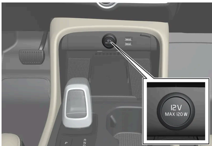
12-V-Steckdose in der Tunnelkonsole, vorn.
