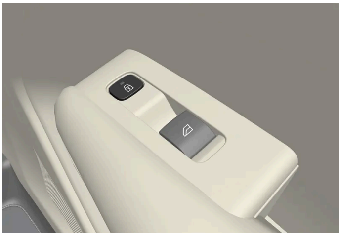
Verriegelungstaste mit Anzeigeleuchte an der Fondtür.
