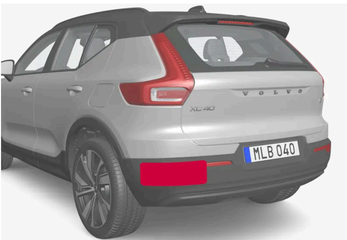
Platzierung der hinteren Radareinheiten
