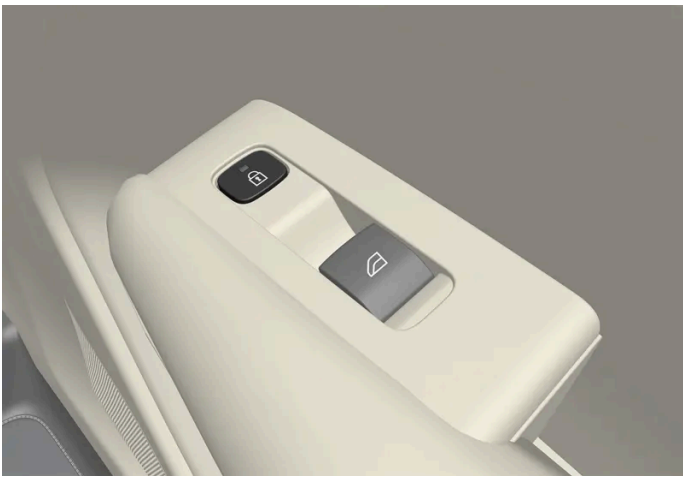
Verriegelungstaste mit Anzeigeleuchte an der Hintertür.
