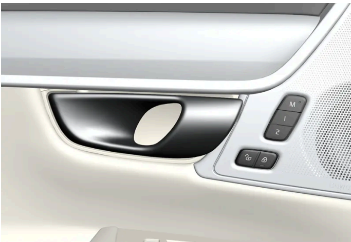
Griff zum alternativen Entriegeln der Tür [1] .
