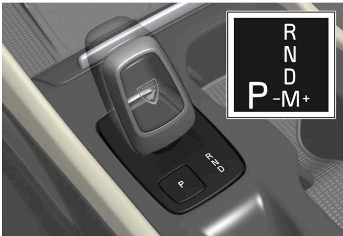
Wählhebel und Schaltmuster auf dem Fahrerdisplay.
