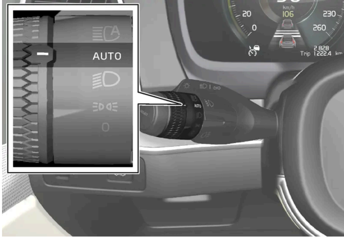
Drehring am Lenkradhebel in Stellung AUTO .
