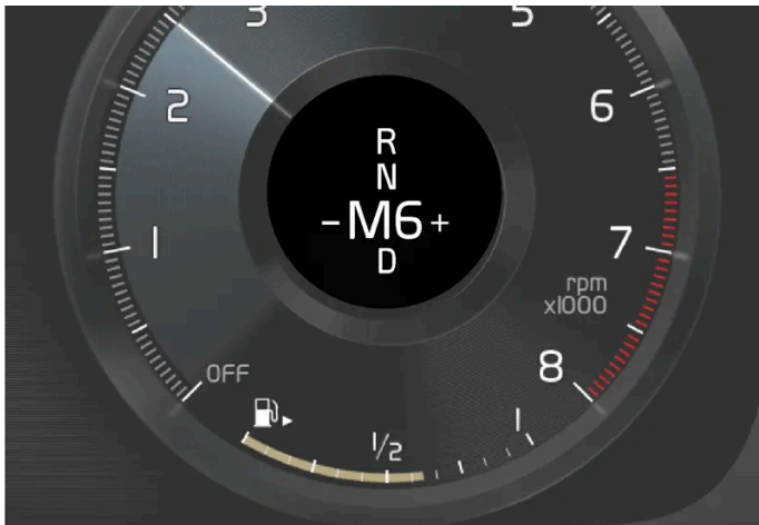
Übersicht über manuellen Schaltmodus auf dem Fahrerdisplay.
