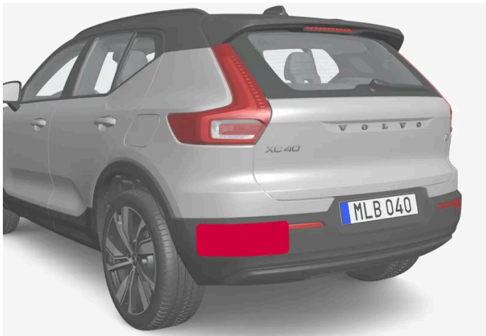
Platzierung der hinteren Radareinheiten
