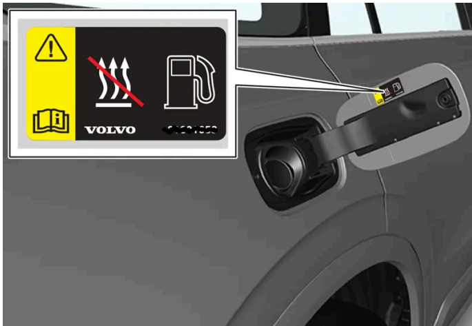
Warnaufkleber auf der Kraftstofftankklappe.
