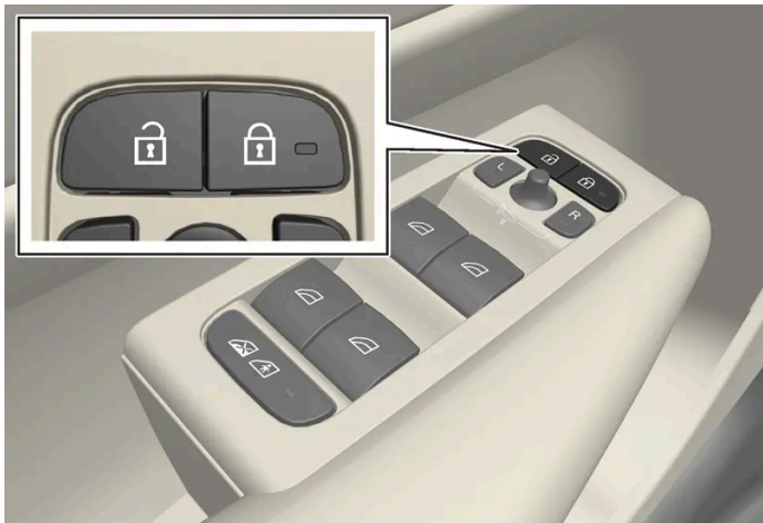
Verriegelungstasten mit Anzeigeleuchte an der Vordertür.
