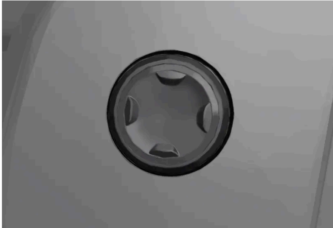
Seitlich am Sitzpolster angebrachter Vierwegeschalter.
