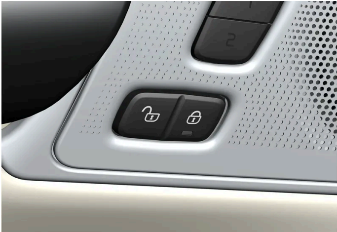
Verriegelungstasten mit Anzeigeleuchte an der Vordertür.
