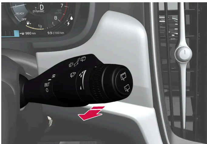
Waschfunktion, rechter Lenkradhebel.
