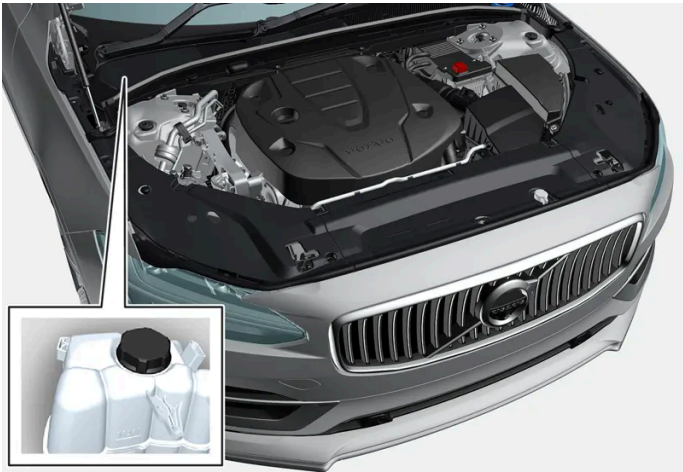
Ausgleichsbehälter der Kühlanlage, Rechtslenker
