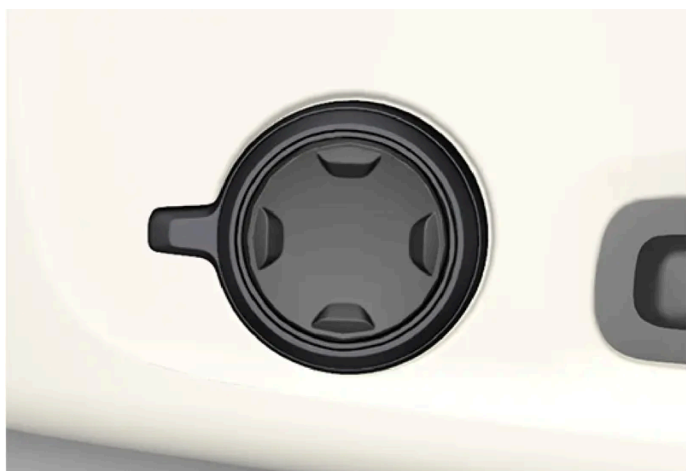
Seitlich am Sitzpolster angebrachter Multifunktionsschalter.
