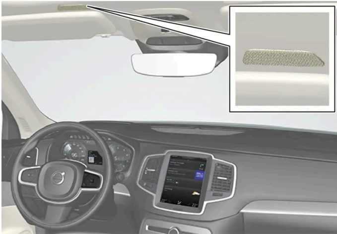
Mikrofon des Sprachsteuerungssystems
