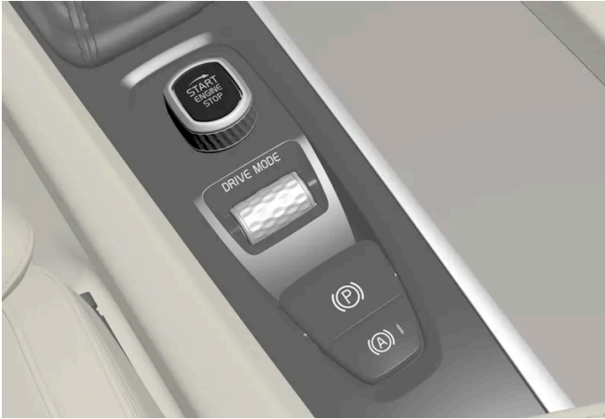
Startschalter auf der Tunnelkonsole.
