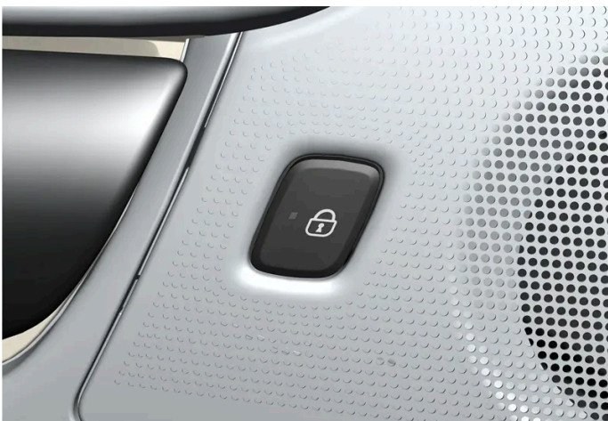
Verriegelungstaste mit Anzeigeleuchte an der Fondtür.
