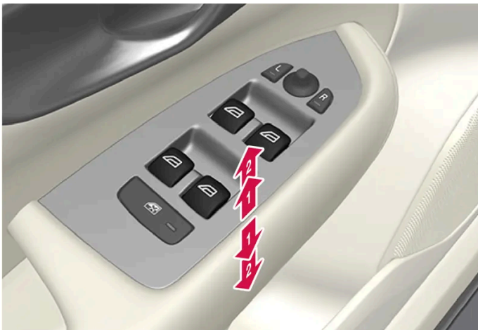
Betätigung der Fensterheber.
