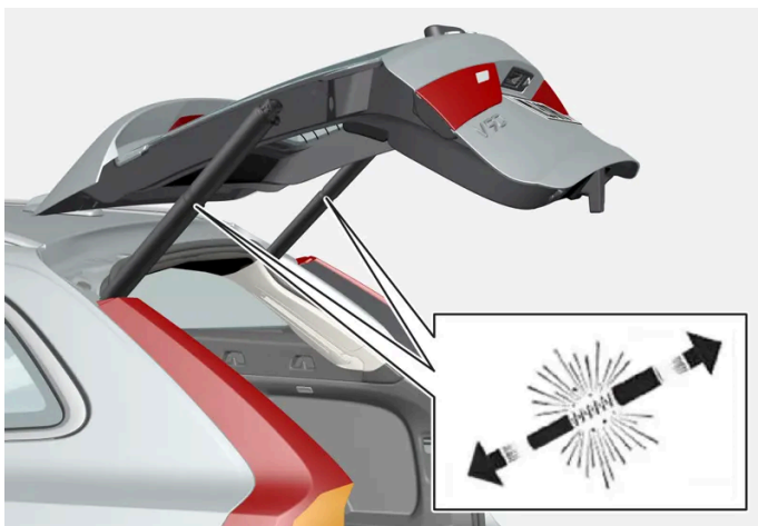
Vorgespannte Federn der elektrisch betätigten Heckklappe.
