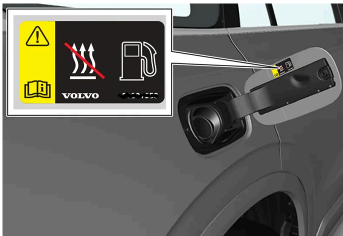
Warnaufkleber auf der Kraftstofftankklappe.
