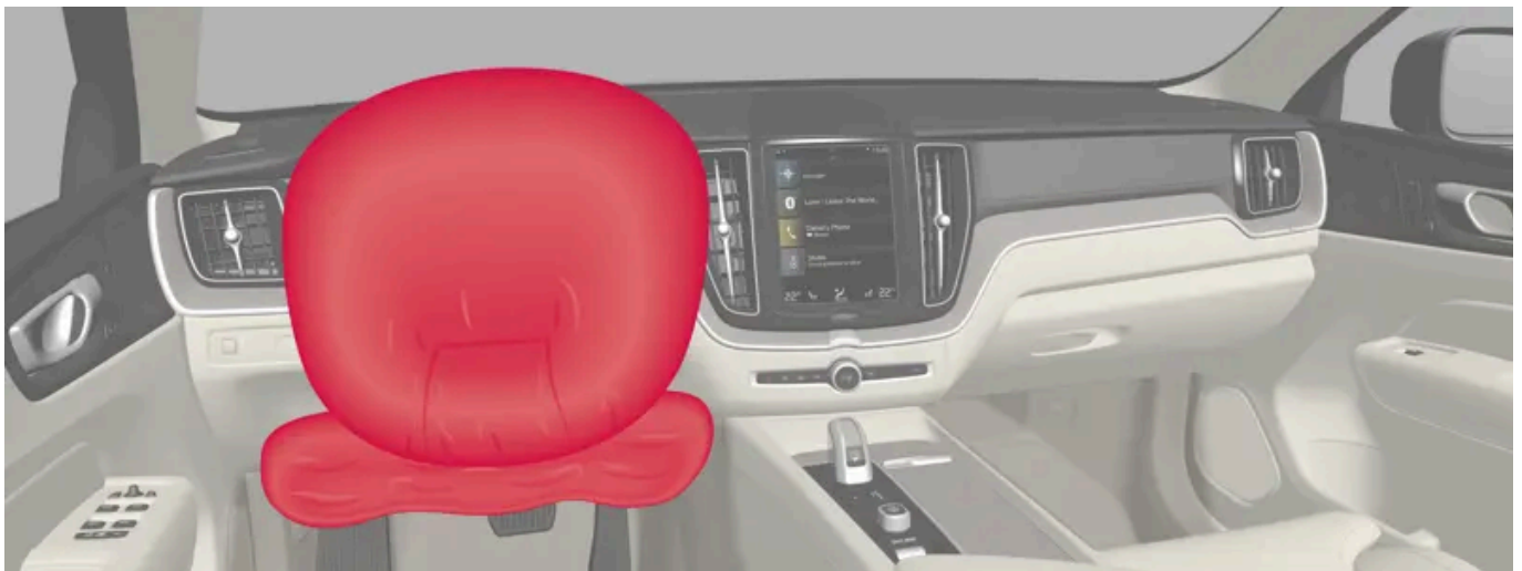
Lenkrad-Airbag und Knie-Airbag [1] am Fahrersitz.
