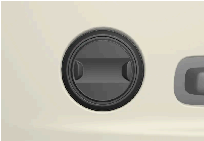
Bedienelement in Fahrzeugen mit Zwei-Wege-Lendenwirbelstütze* .
