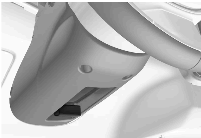
Hebel für die Lenkradverstellung.
