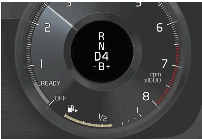
Fahrerdisplay beim Schalten mit den Schaltwippen.
