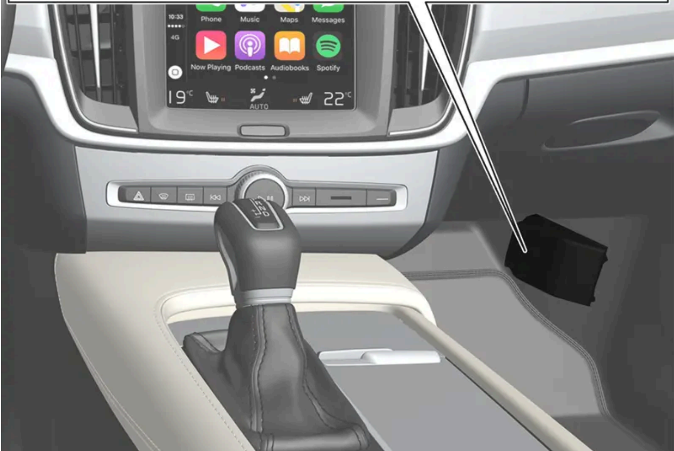
Der Sicherungskasten befindet hinter der Bodenmatte/Seitenverkleidung.
