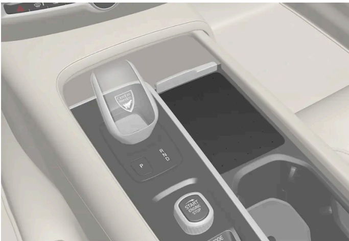
Drahtlos-Telefonladegerät an der Tunnelkonsole.
