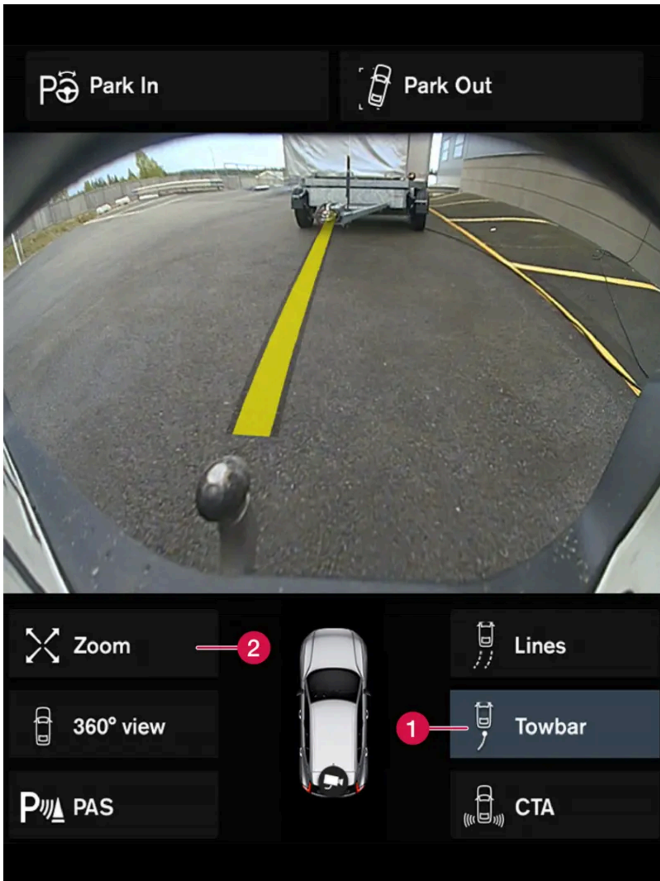
Anhängerkupplung mit Hilfslinie
