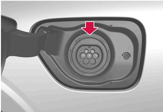
Position der LED-Leuchte am Ladeanschluss des Fahrzeugs.
