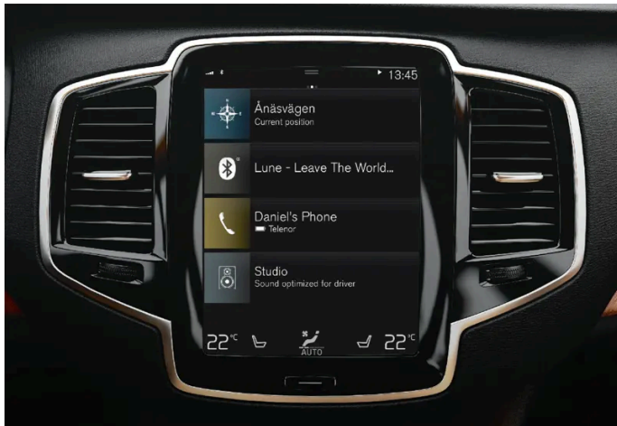
Center Display mit Sensus Connect.
