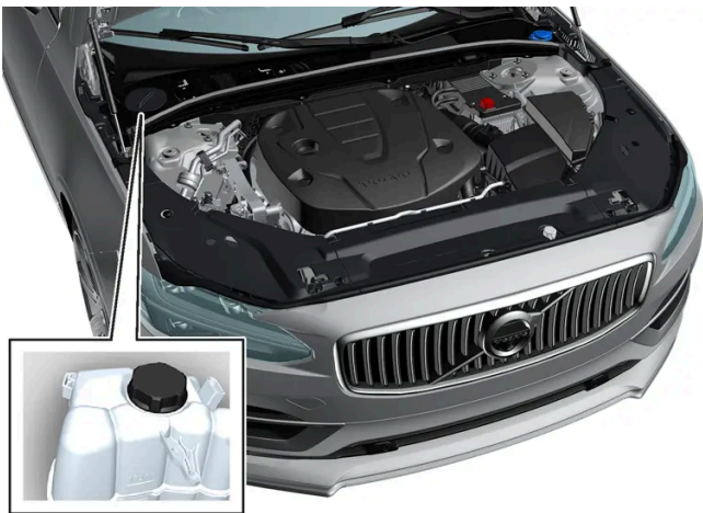
Ausgleichsbehälter der Kühlanlage, Linkslenker
