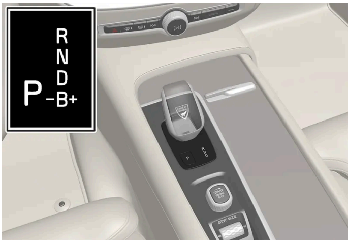
Wählhebel und Schaltmuster auf dem Fahrerdisplay.
