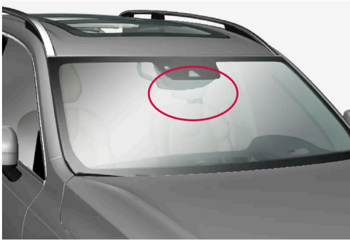
Anordnung der vorderen Radareinheit
