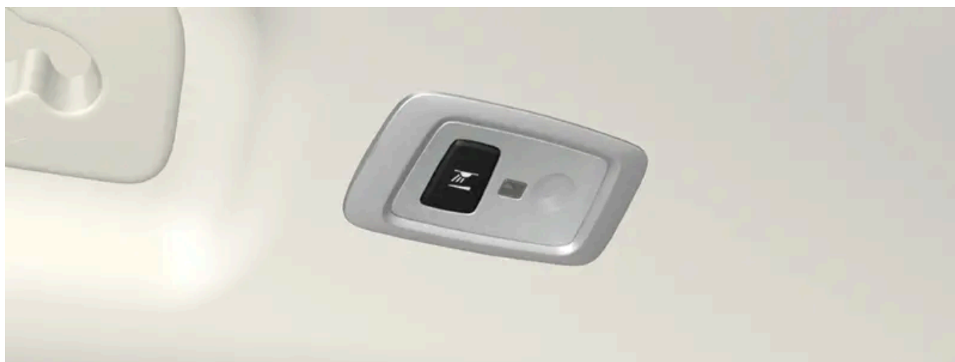
Fahrzeuge mit Panoramadach* verfügen beidseits des Dachs über je ein Leuchtenmodul.
