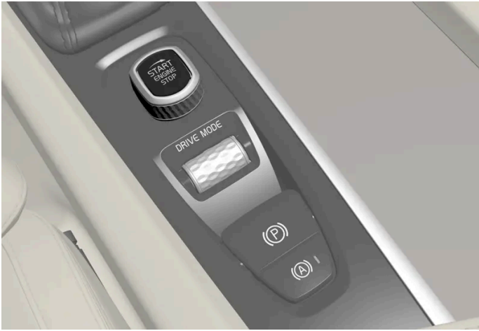
Startschalter auf der Tunnelkonsole.
