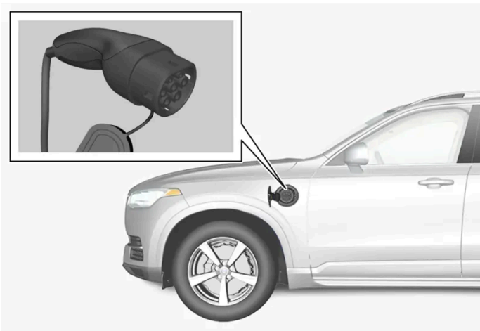
Ladestutzen und Ladebuchse.
