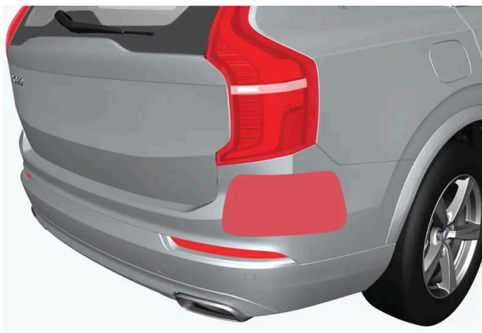
Platzierung der hinteren Radareinheiten
