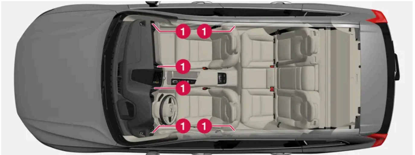
Anordnung der verstellbaren Belüftungsdüsen im Innenraum.
