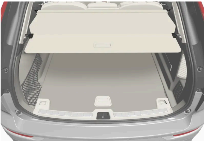
Die Abdeckung in der vollständig ausgezogenen Stellung.
