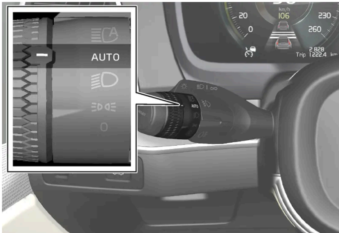
Drehring am Lenkradhebel in Stellung AUTO .
