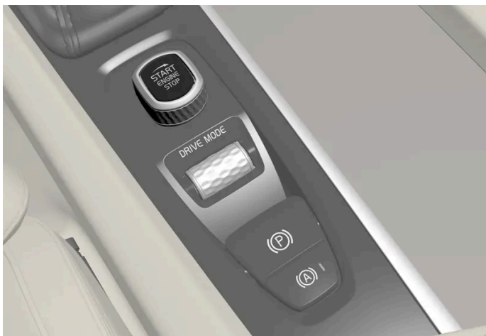
Startschalter auf der Tunnelkonsole.
