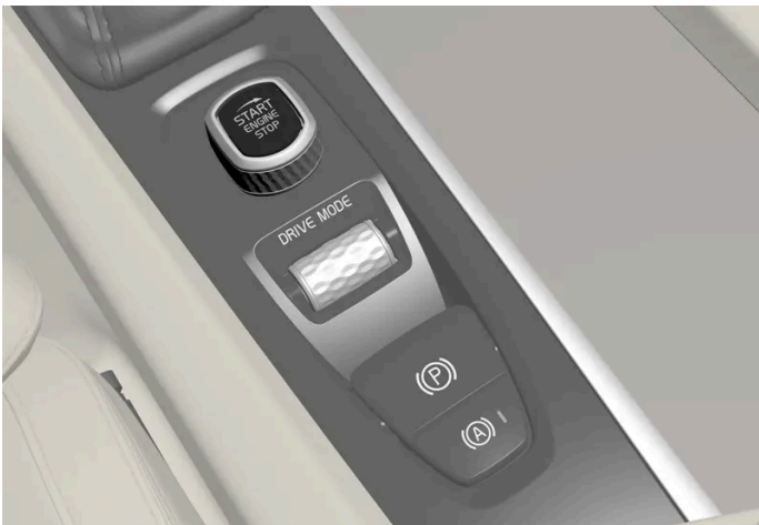
Startschalter auf der Tunnelkonsole.
