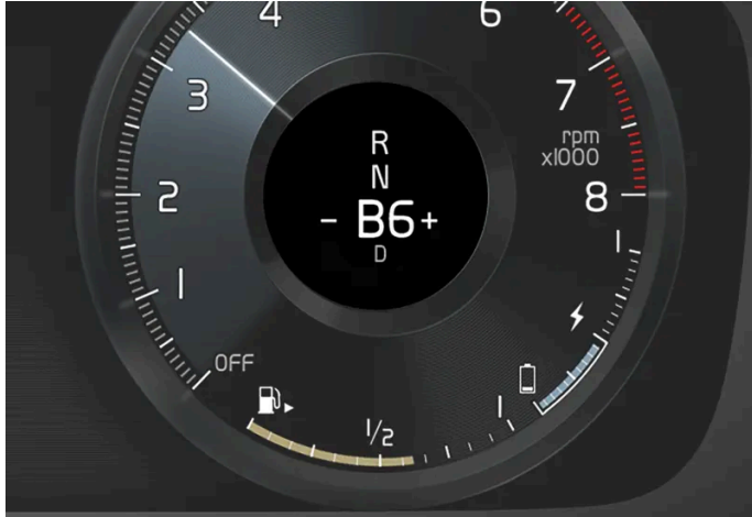
Schaltanzeige im Fahrerdisplay [1] .
