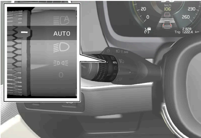
Drehring am Lenkradhebel in Stellung AUTO .
