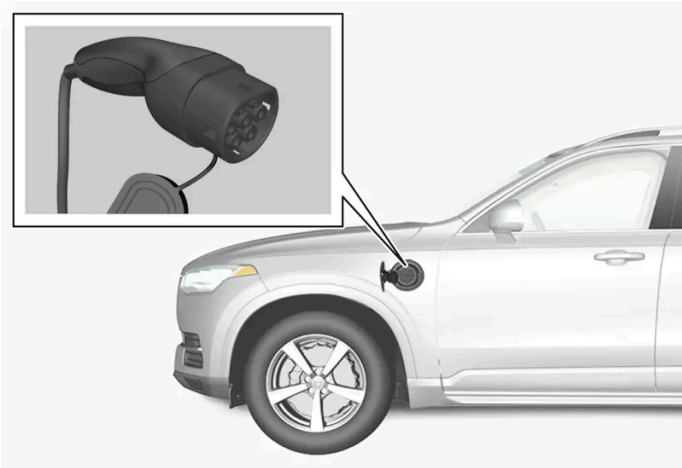
Ladestutzen und Ladebuchse.
