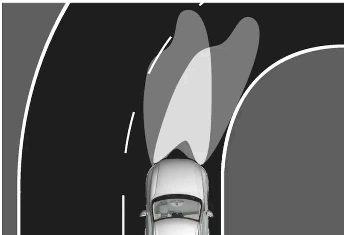
Lichtverteilung ohne (links) bzw. mit (rechts) dynamischem Kurvenlicht.
