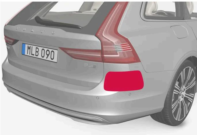
Platzierung der hinteren Radareinheiten
