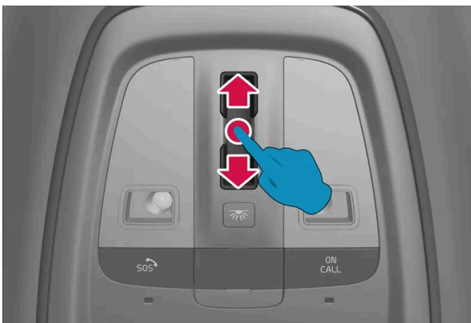
Über den berührungsempfindlichen Regler in einer fließenden Bewegung nach vorn oder hinten wischen, um das Panoramadach vollständig zu öffnen oder zu schließen. Wenn ein Problem auftritt, versuchen Sie, die Bewegung schneller oder langsamer auszuführen.
