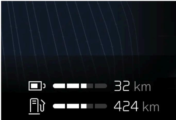
Die geschätzte Reichweite wird im Fahrerdisplay angezeigt.
