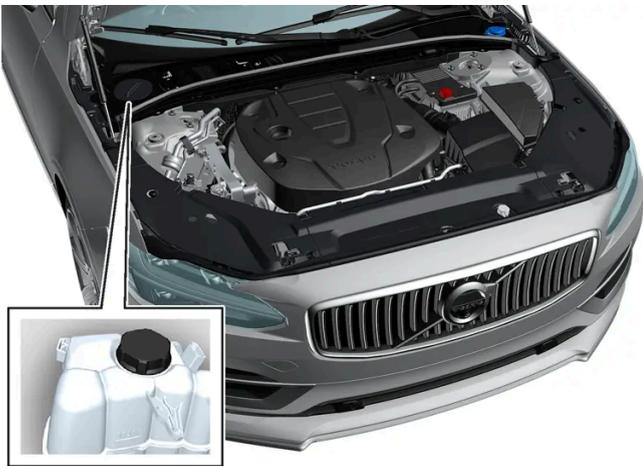
Ausgleichsbehälter der Kühlanlage, Linkslenker.
