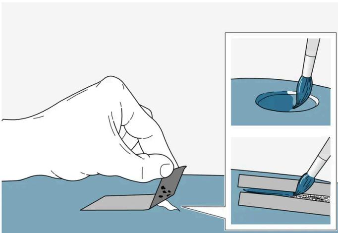
Wenn die Beschädigung nicht so tief ist, dass sie bis zum Metall reicht, kann der Korrekturlack direkt auf die gereinigte Oberfläche aufgebracht werden.
