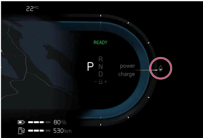
Der aktivierte Fahrmodus wird auf dem Fahrerdisplay angezeigt.
