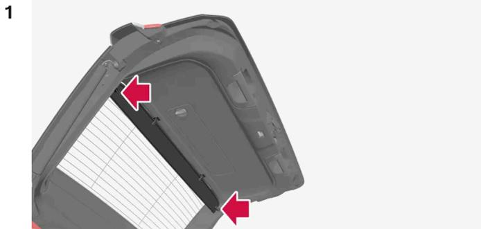
Wenden Sie die Abdeckplatte mit der Schraubenseite nach unten und manövrieren die Stifte in die Befestigung auf einer Seite der Heckklappe.
