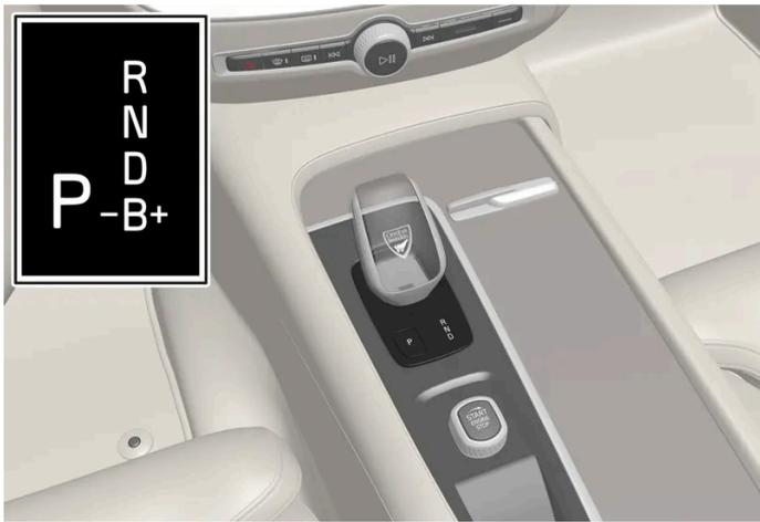
Wählhebel und Schaltmuster auf dem Fahrerdisplay.
