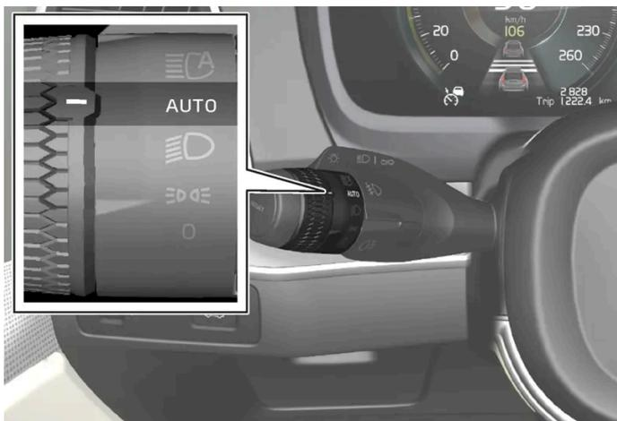
Drehring am Lenkradhebel in Stellung **AUTO**.
