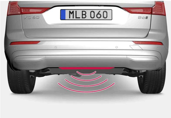
Der Sensor befindet sich in der Mitte des Stoßfängers.
