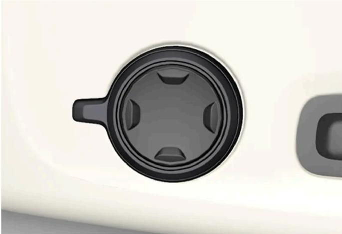
Multifunktionsschalter, in Fahrzeugen mit Vier-Wege-Lendenwirbelstütze\*.
