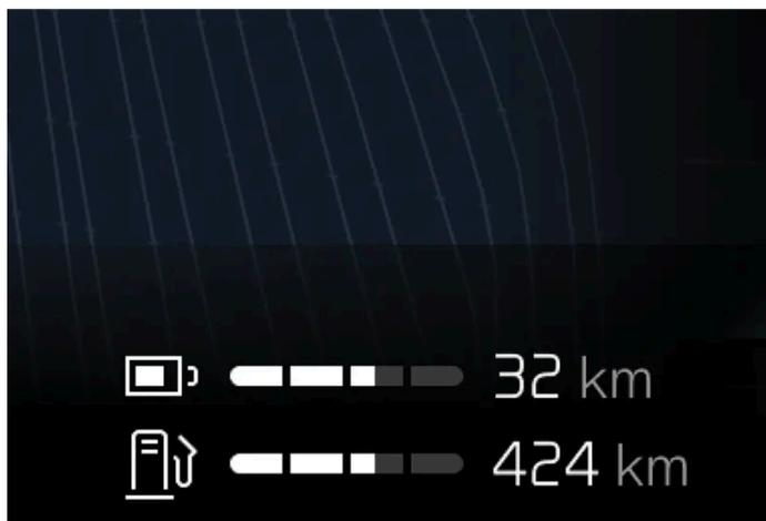
Die geschätzte Reichweite wird im Fahrerdisplay angezeigt.
