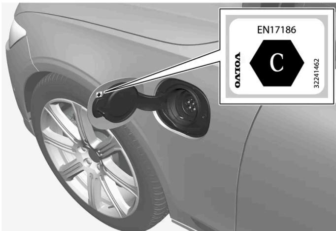
Die Kennzeichnung gemäß CEN Norm EN 17186 befindet sich auf der Innenseite der Abdeckung des Ladeanschlusses.
