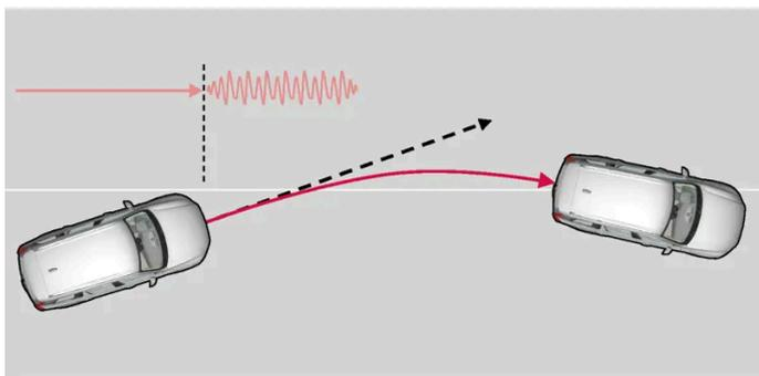
Der Spurassistent warnt den Fahrer mit Lenkradvibrationen.
