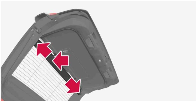
Ziehen Sie die Abdeckplatte vorsichtig von der Befestigung zuerst an einer Seite der Heckklappe los, und dann von der anderen Seite. Abdeckplatte gegebenenfalls etwas ankrümmen, um dadurch flexibler zu sein und die Entfernung zu erleichtern.
