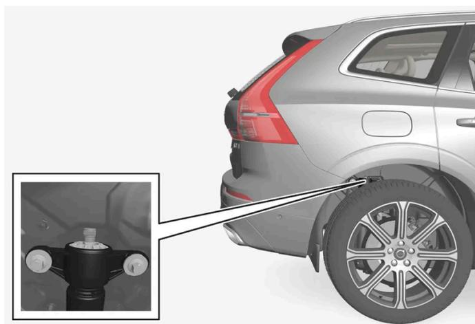
Verstellung eines Einstellrades am Hinterrad.
