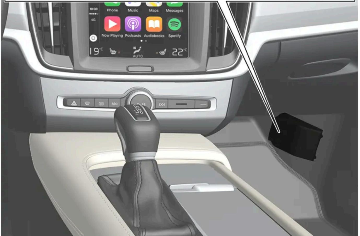
Der Sicherungskasten befindet sich hinter der Bodenmatte/Seitenverkleidung.
