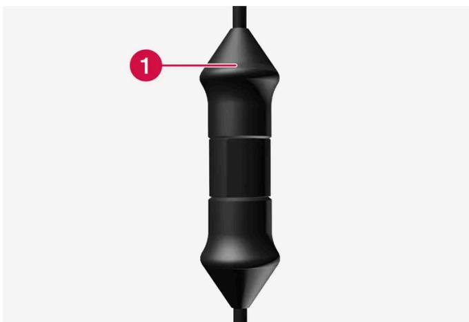
LED<sup>[2]</sup>-Leuchten an der Bedieneinheit.
