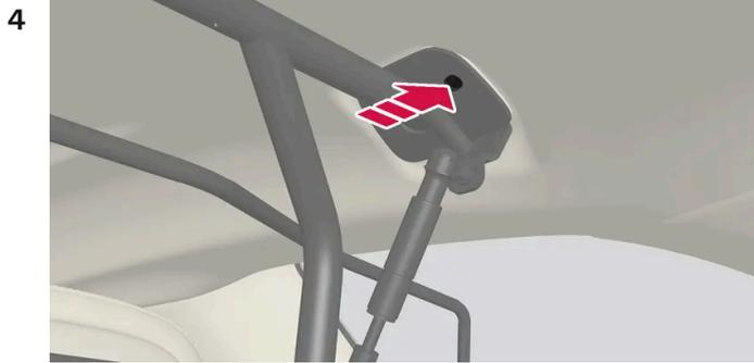
Die mitgelieferte Schraube einsetzen und anziehen. Ein 6-mm-Inbusschlüssel ist im Lieferumfang enthalten. Auf der anderen Seite ebenso vorgehen. Empfohlenes Anzugsmoment: 20 Nm (15 ft-lb).
