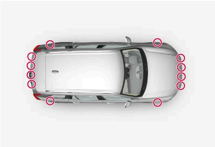
Anordnung der Einparkhilfesensoren rund um das Fahrzeug
