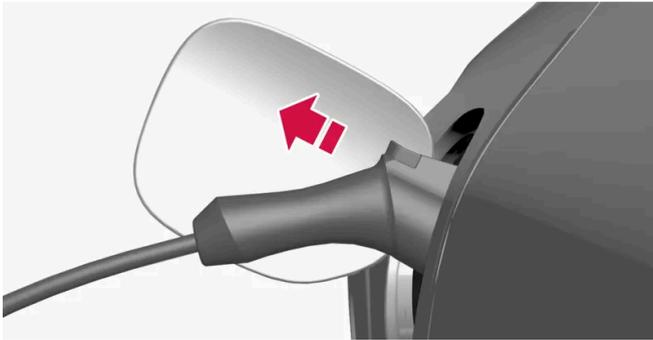
Das Ladekabel aus der Ladebuchse des Fahrzeugs abziehen und den Deckel schließen.
