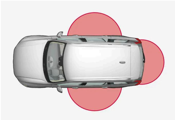
Für die schlüssellose Bedienung muss sich ein Schlüssel in einer Entfernung von ca. 1 bis 1,5 Meter (3 bis 5 Fuß) von den Fahrzeugtüren oder der Heckklappe befinden.
