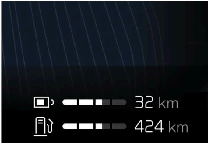
Die geschätzte Reichweite wird im Fahrerdisplay angezeigt.
