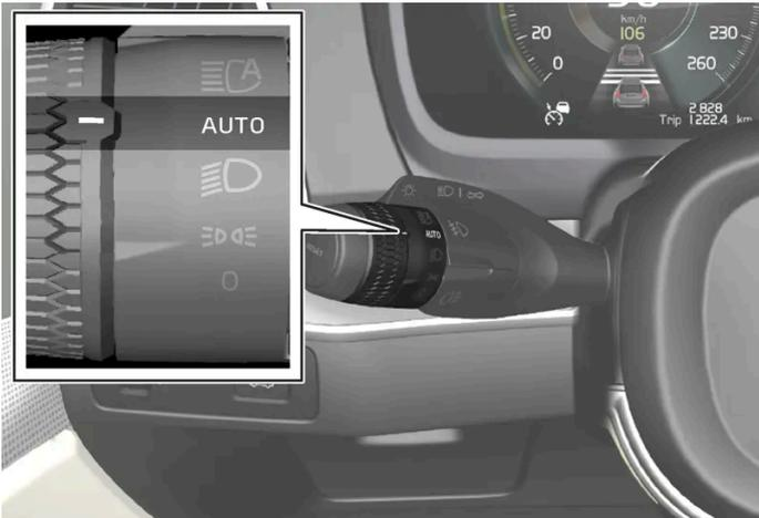
Drehring am Lenkradhebel in Stellung **AUTO**.
