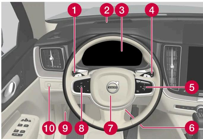
**1** Positionsleuchten, Tagfahrlicht, Abblendlicht, Fernlicht, Blinker, Nebelschlussleuchte, Zurücksetzen des Tageskilometerzählers
