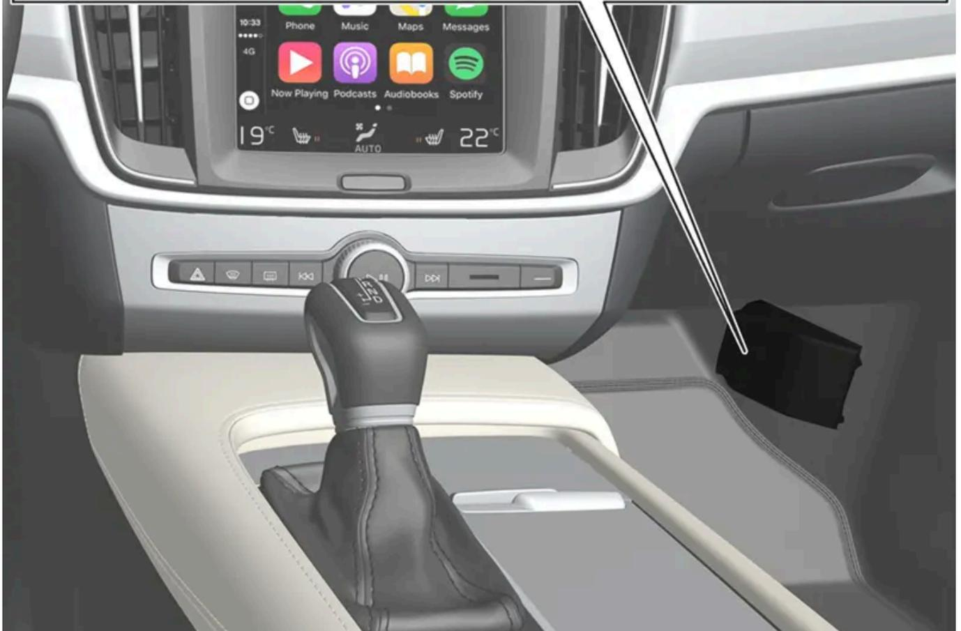
Der Sicherungskasten befindet sich hinter der Bodenmatte/Seitenverkleidung.
