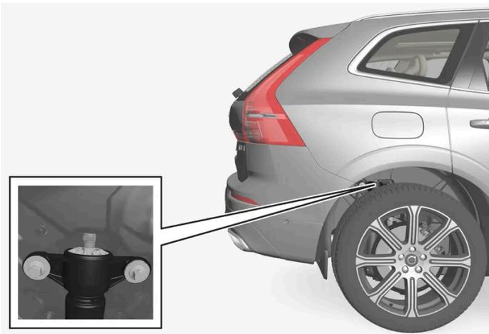
Verstellung eines Einstellrades am Hinterrad.
