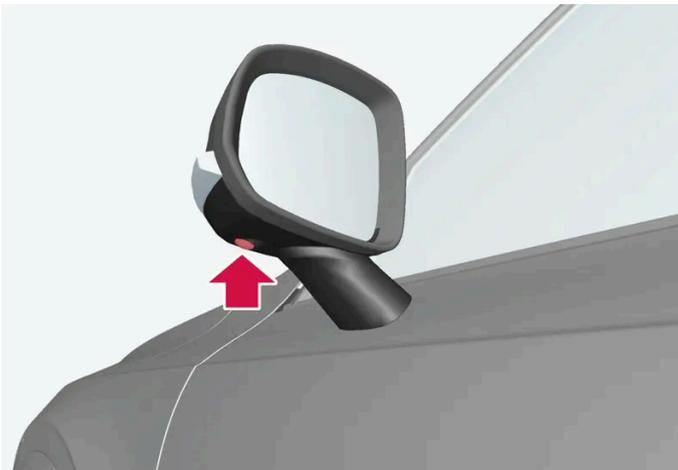
Die Seitenkameras befinden sich in den Seitenspiegeln.
