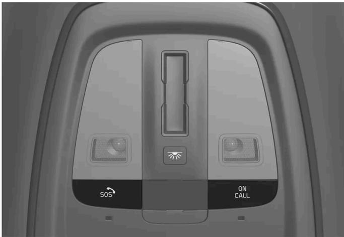
Die Funktionen sind über die ON CALL- und SOS-Tasten am Dachhimmel des Fahrzeugs verfügbar.
