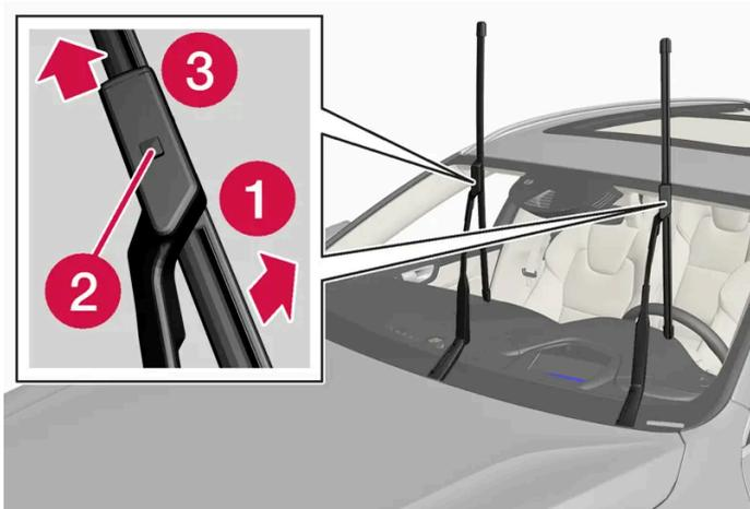
Den Wischerarm hochklappen, wenn er sich in Wartungsstellung befindet. Die Wartungsstellung wird bei stehendem Fahrzeug und ausgeschalteten Scheibenwischern über das Center Display aktiviert bzw. deaktiviert.
