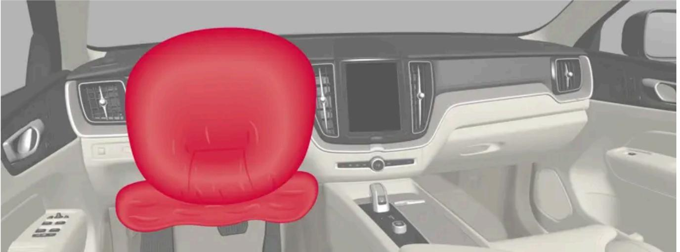
Lenkrad-Airbag und Knie-Airbag<sup>[1]</sup> am Fahrersitz.
