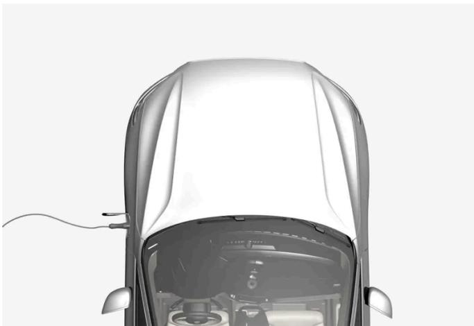
Die Hybridbatterie wird über das Ladekabel aufgeladen. Im Schaltmodus **B** kann die Aufladung bei sanftem Abbremsen und Nutzung der Motorbremse erfolgen. Die Hybridbatterie kann auch mit dem Verbrennungsmotor des Fahrzeugs aufgeladen werden. Die Startbatterie des Fahrzeugs wird aufgeladen, wenn eine Aufladung der Hybridbatterie erfolgt.
