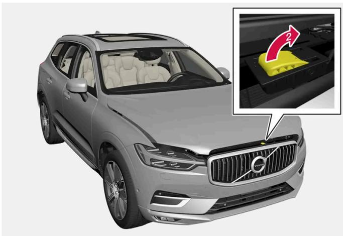
➔ Wenn Sie mit der Hand unter der Frontklappe von links nach rechts fahren, spüren Sie den Entriegelungsgriff. Führen Sie diesen nach oben und zur Seite und heben Sie die Klappe dann an.
