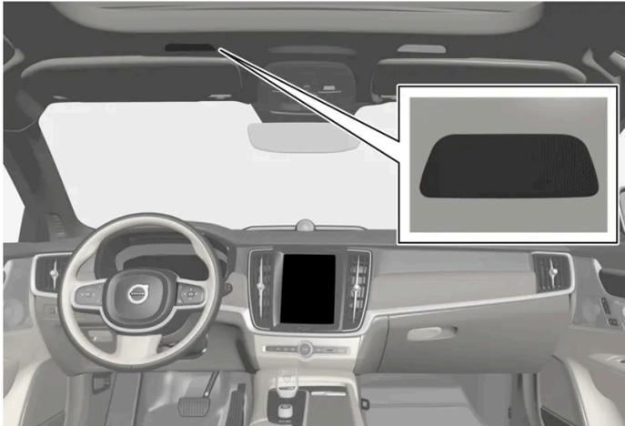
Mikrofon des Sprachsteuerungssystems
