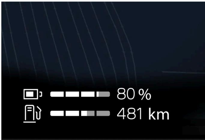
Auf der Batterieanzeige, die sich im unteren Teil des Fahrerdisplays befindet, sehen Sie den Ladezustand der Batterie und die damit noch verbleibende Reichweite.
