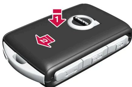
Bringen Sie die obere Abdeckung in der umgekehrten Reihenfolge wieder an. Drücken Sie die Abdeckung herunter, bis ein Klicken zu hören ist, und schieben Sie sie anschließend die letzten Millimeter in die ursprüngliche Position zurück.
