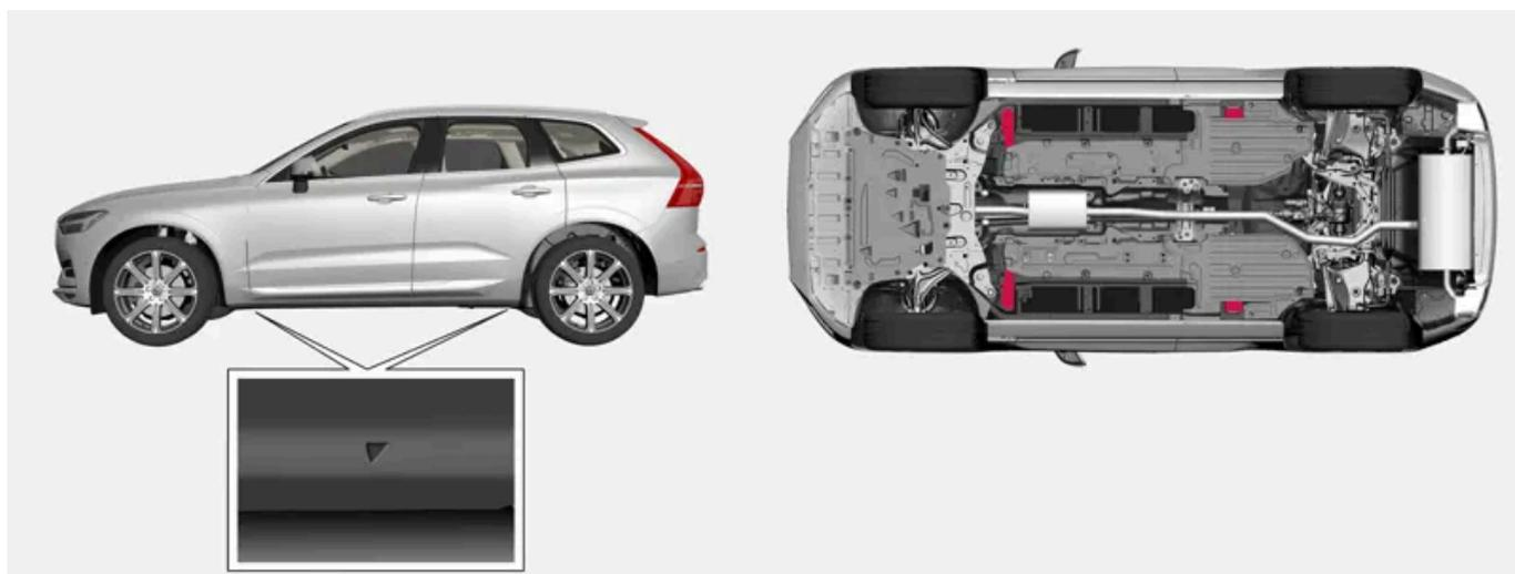
Die Dreiecke an der Kunststoffverkleidung zeigen, wo sich die Wagenheber-Befestigungspunkte/Aufnahmepunkte (rot markiert) befinden.
