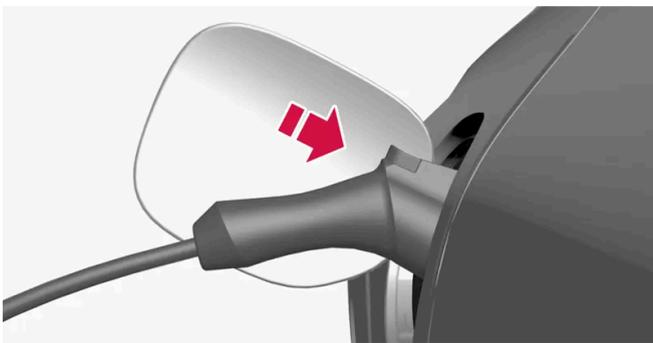
Schutzverschluss des Ladestutzens abziehen und den Ladestutzen ganz in den Anschluss des Fahrzeugs einführen.
