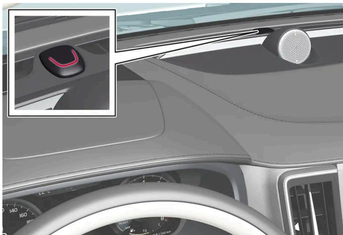
Die Verriegelungs- und Alarmanzeige zeigt den Status des Verriegelungssystems an:
