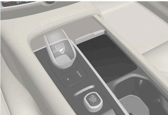
Drahtlos-Telefonladegerät an der Tunnelkonsole.
