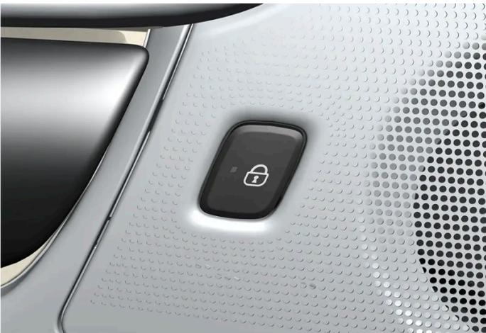
Verriegelungstaste mit Anzeigeleuchte an der Fondtür.
