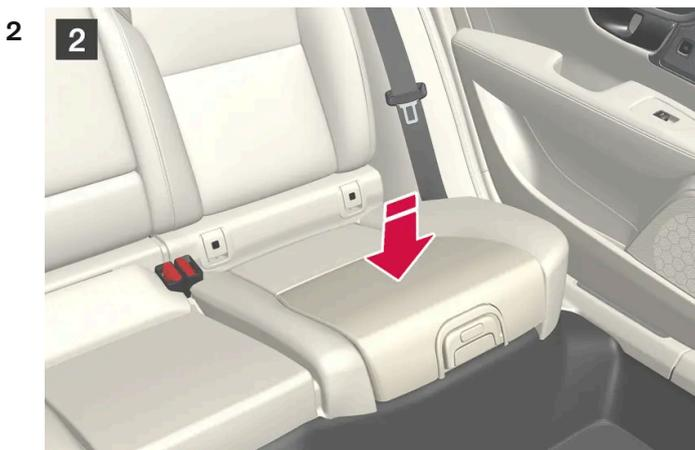
2 Zur Verriegelung der Sitzhöhung deren Mitte mit der Hand nach unten drücken.
