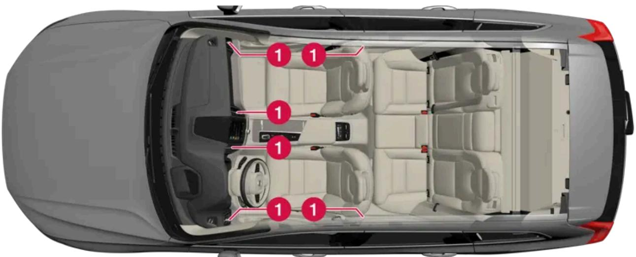
Anordnung der verstellbaren Belüftungsdüsen im Innenraum.
