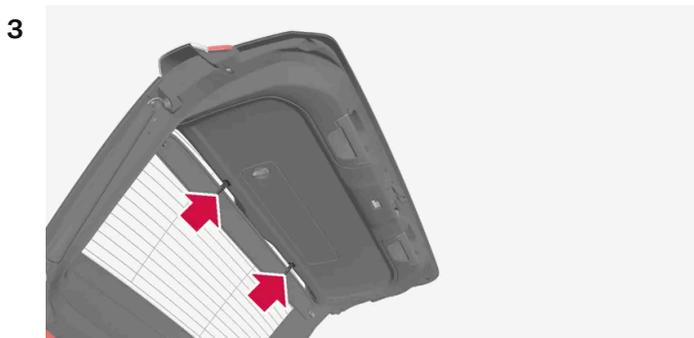
Die beiden oberen Clips in die jeweilige Montagebuchse der Heckklappe drücken, so dass diese einklicken.
