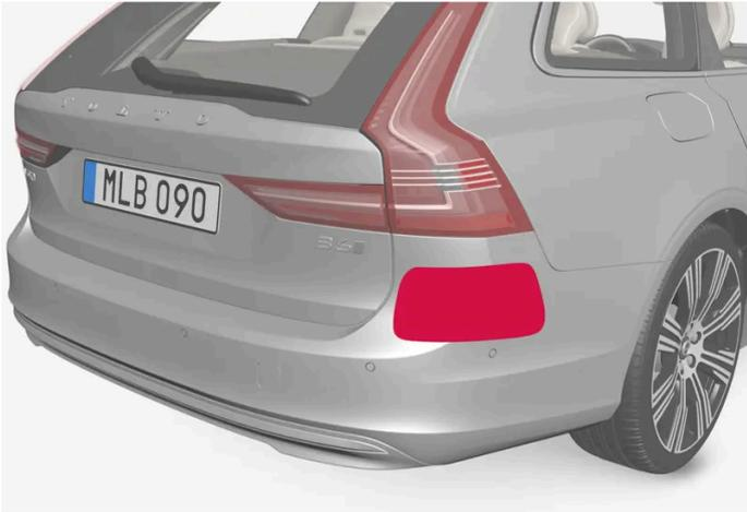
Platzierung der hinteren Radareinheiten
