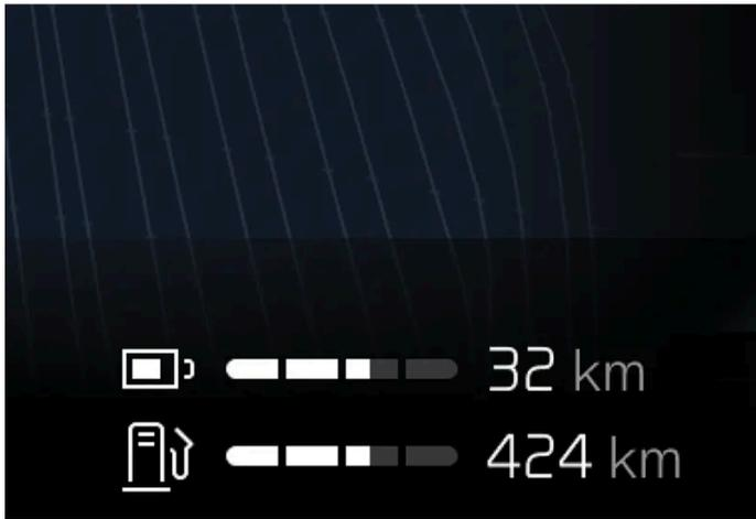
Die geschätzte Reichweite wird im Fahrerdisplay angezeigt.
