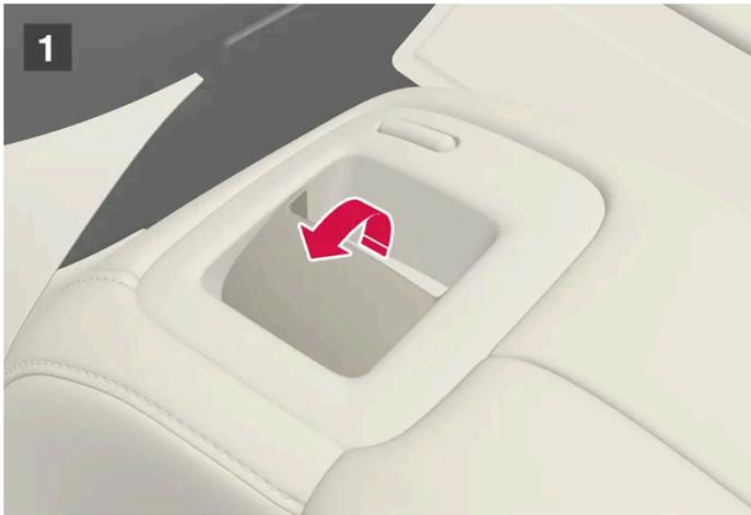
Bei Fahrzeugen mit elektrisch betätigtem \* Umklappen der Kopfstützen im Fond können die Kopfstützen der äußeren Sitze mithilfe der Handgriffe an der Oberseite der Sitze umgeklappt werden, siehe Abbildung **1**. Beachten Sie, dass hierdurch auch die Rückenlehnen umgeklappt werden. Wenn nur eine Kopfstütze umgeklappt werden soll, zum Beispiel um die Sicht zu verbessern, dann verwenden Sie dazu stattdessen das Center Display\*.
