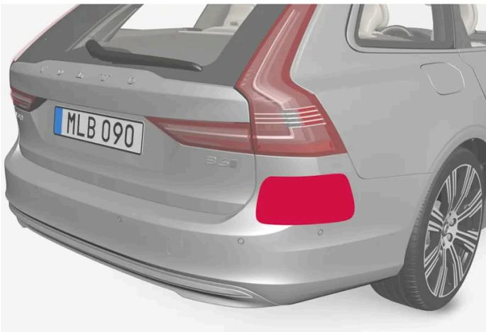
Platzierung der hinteren Radareinheiten
