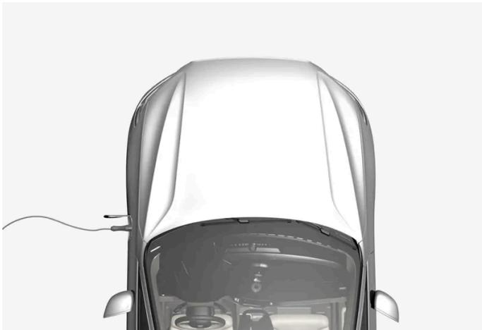
Die Hybridbatterie wird über das Ladekabel aufgeladen. Im Schaltmodus **B** kann die Aufladung bei sanftem Abbremsen und Nutzung der Motorbremse erfolgen. Die Hybridbatterie kann auch mit dem Verbrennungsmotor des Fahrzeugs aufgeladen werden. Die Startbatterie des Fahrzeugs wird aufgeladen, wenn eine Aufladung der Hybridbatterie erfolgt.
