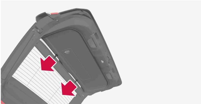
Ziehen Sie die oberen Clips der Abdeckplatte gerade aus der Heckklappe heraus.
