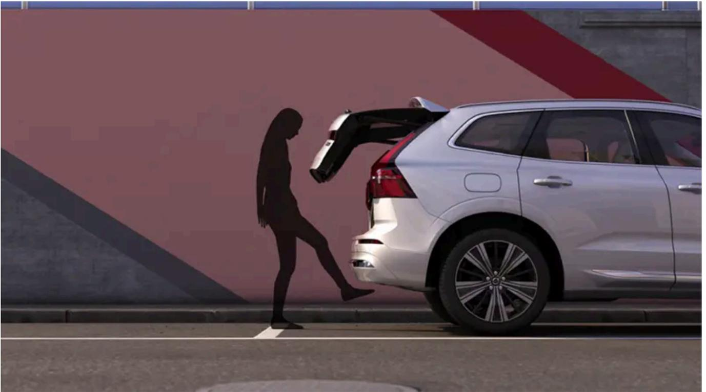
Wenn das Fahrzeug mit der schlüssellosen Verriegelung und Entriegelung\* ausgerüstet ist, kann die Heckklappe durch eine Fußbewegung geöffnet werden.
