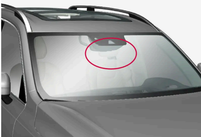
Anordnung der vorderen Kameraeinheit
