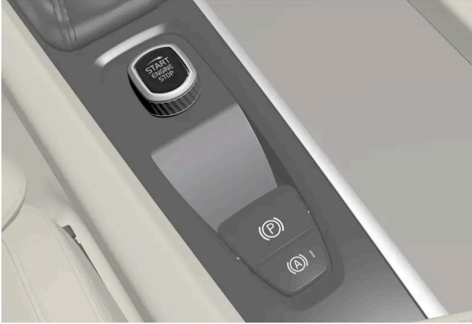
Startschalter auf der Tunnelkonsole.
