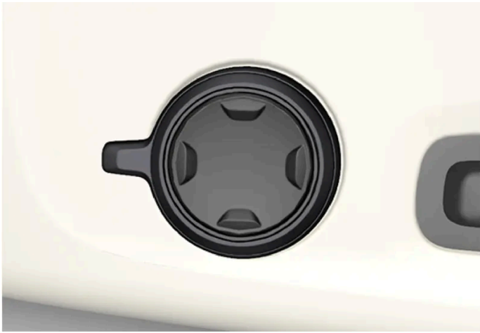
Seitlich am Sitzpolster angebrachter Multifunktionsschalter.
