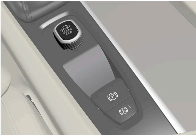
Startschalter auf der Tunnelkonsole.
