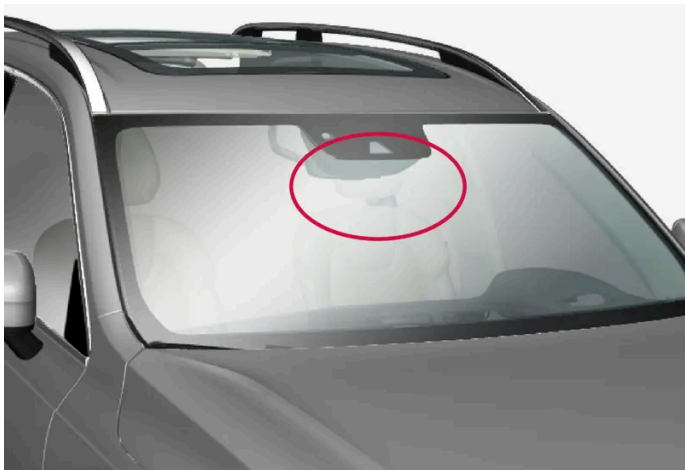
Platzierung der Kameraeinheit
