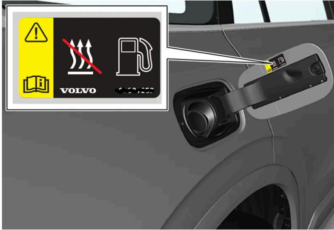
Warnaufkleber auf der Kraftstofftankklappe.
