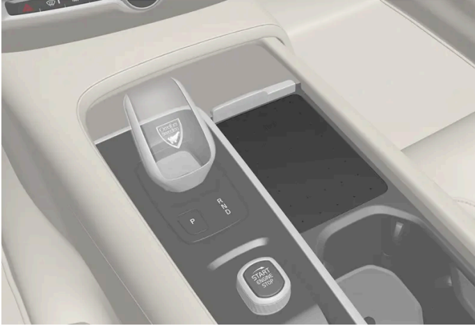
Kabellose Ladeablage an der Tunnelkonsole.
