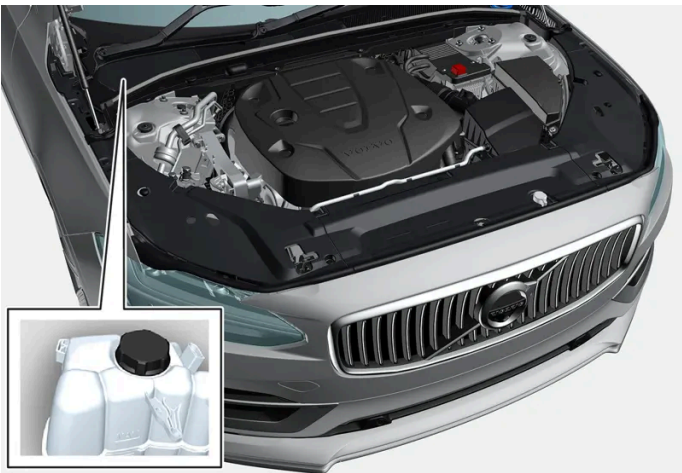
Ausgleichsbehälter der Kühlanlage, Rechtslenker.
