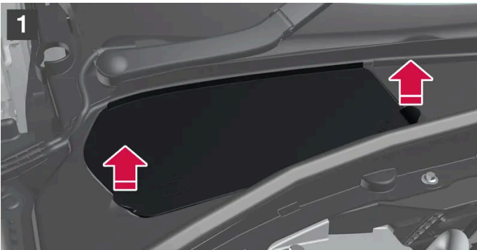
Ausgleichsbehälter der Kühlanlage, Rechtslenker.
