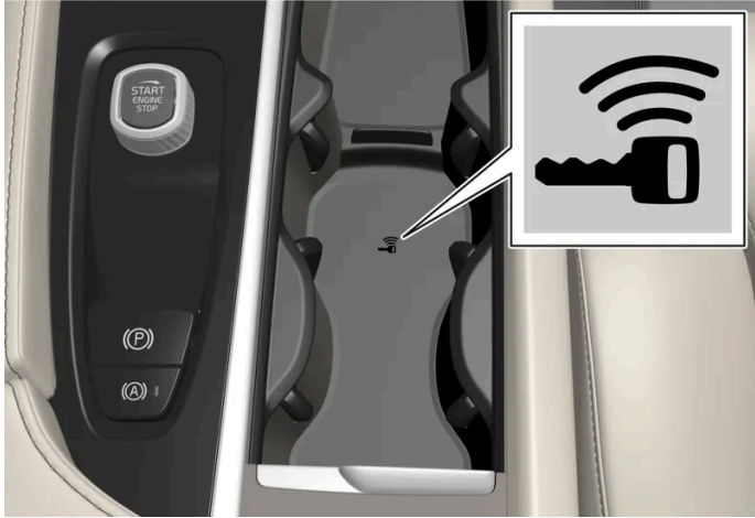
Lage des Schlüssellesegeräts in der Tunnelkonsole.
