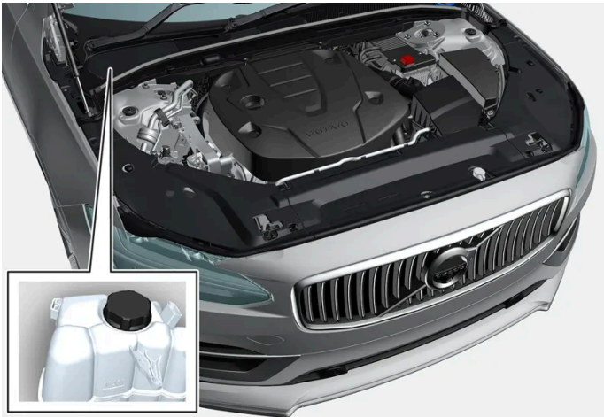
Ausgleichsbehälter der Kühlanlage, Rechtslenker.
