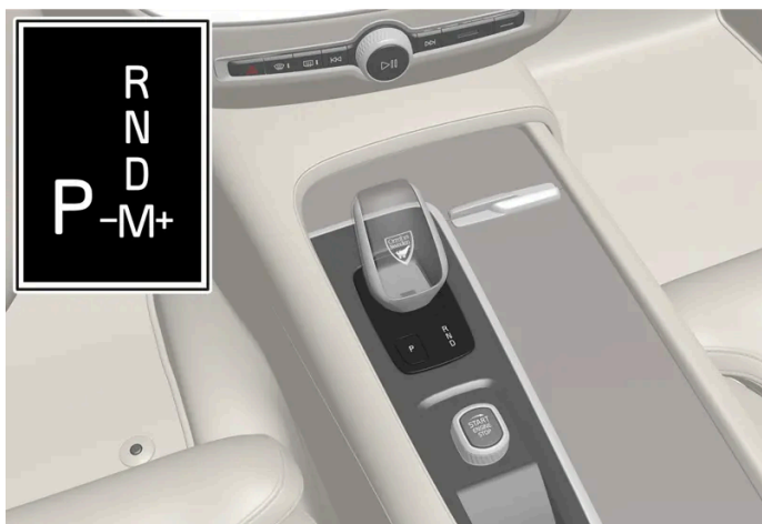
Wählhebel und Schaltmuster auf dem Fahrerdisplay.
