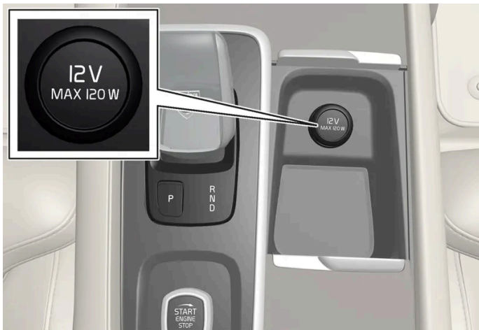
Vordere Steckdose auf der Tunnelkonsole bei Fahrzeugen ohne Drahtlos-Telefonladegerät*.
