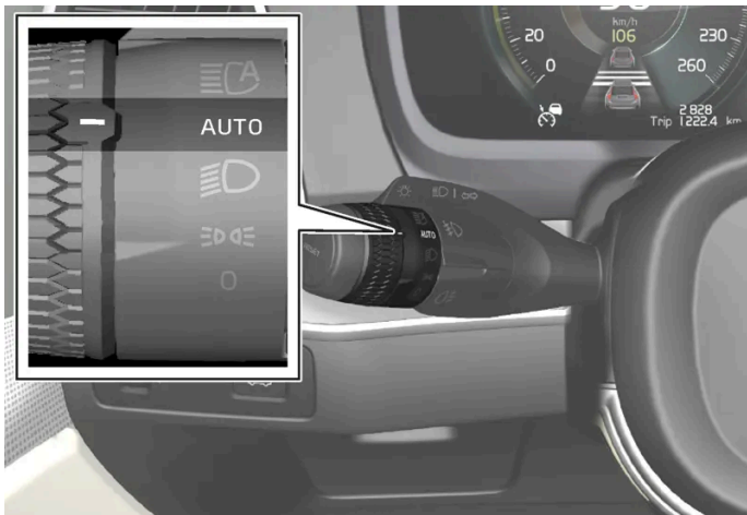
Drehring am Lenkradhebel in Stellung AUTO .
