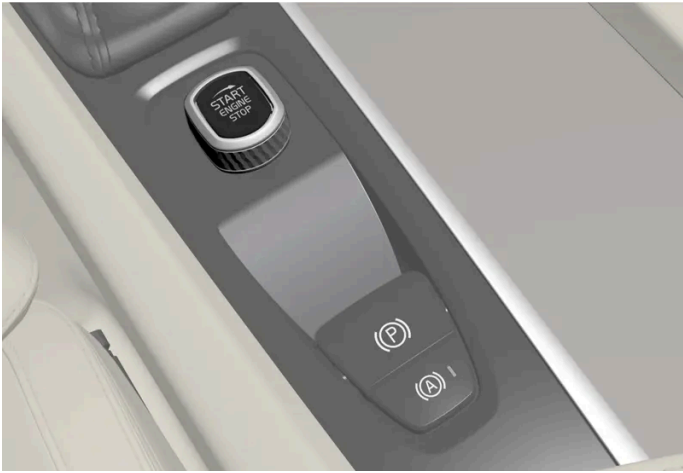
Startschalter auf der Tunnelkonsole.
