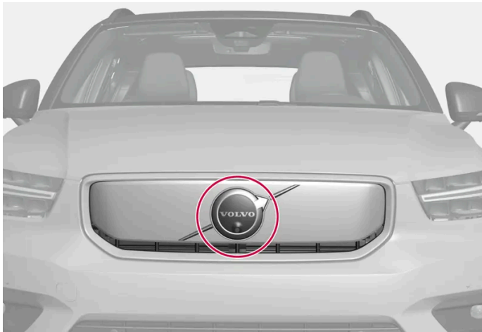
Anordnung der vorderen Radareinheit
