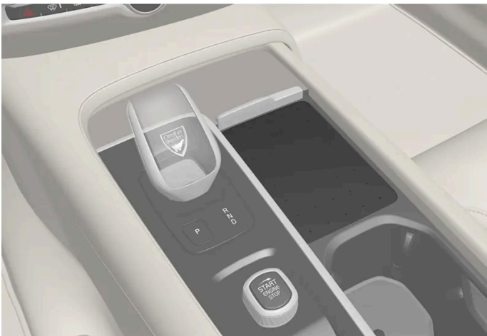
Drahtlos-Telefonladegerät an der Tunnelkonsole.
