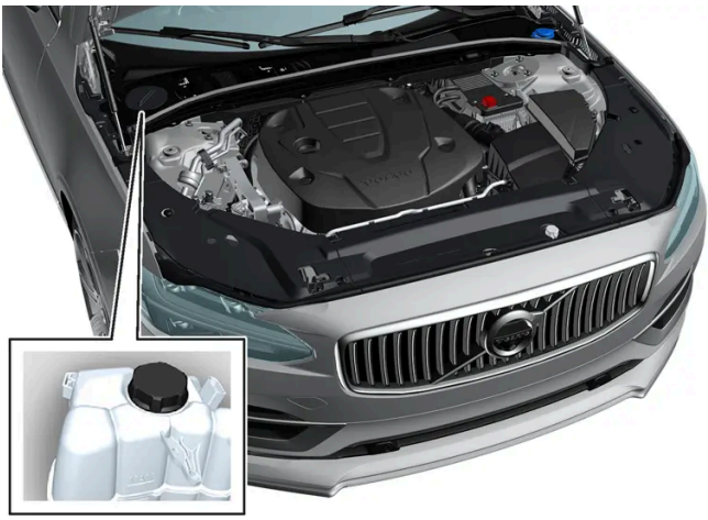
Ausgleichsbehälter der Kühlanlage, Linkslenker.
