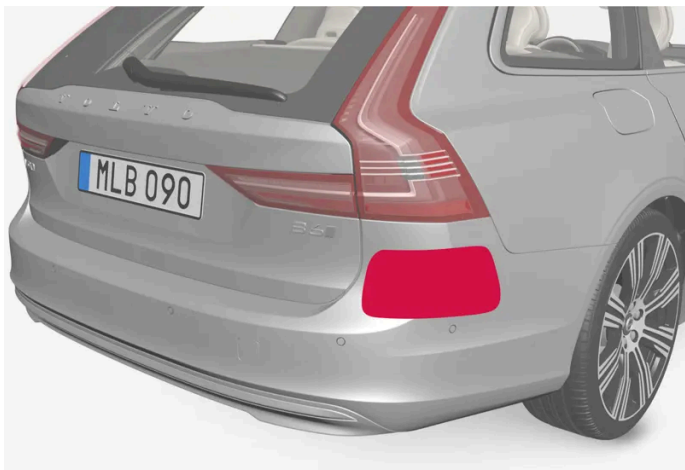
Platzierung der hinteren Radareinheiten
