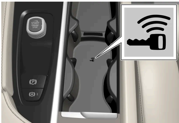
Lage des Schlüssellesegeräts in der Tunnelkonsole.
