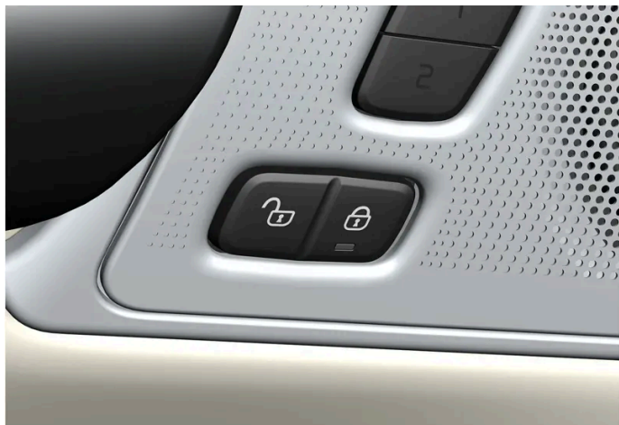
Verriegelungstasten mit Anzeigeleuchte an der Vordertür.
