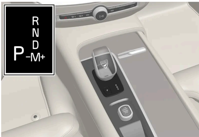
Wählhebel und Schaltmuster auf dem Fahrerdisplay.
