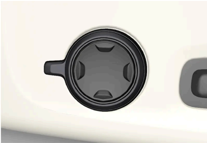
Seitlich am Sitzpolster angebrachter Multifunktionsschalter.
