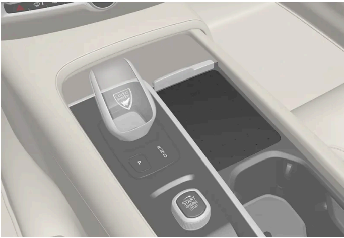
Drahtlos-Telefonladegerät an der Tunnelkonsole.
