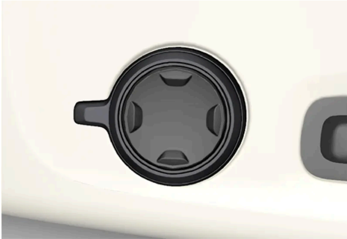
Multifunktionsschalter, in Fahrzeugen mit Vier-Wege-Lendenwirbelstütze*.
