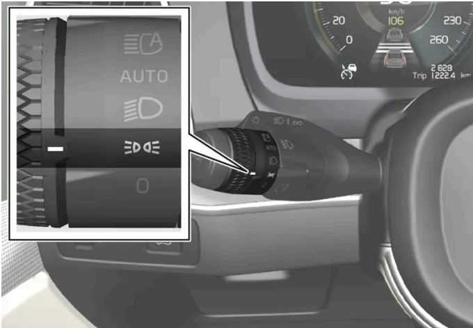
Drehring am Lenkradhebel in der Stellung für die Positionsleuchten.
