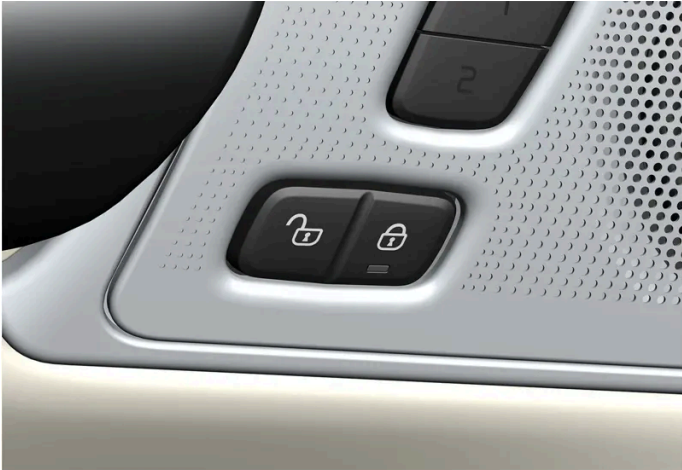
Verriegelungstasten mit Anzeigeleuchte an der Vordertür.
