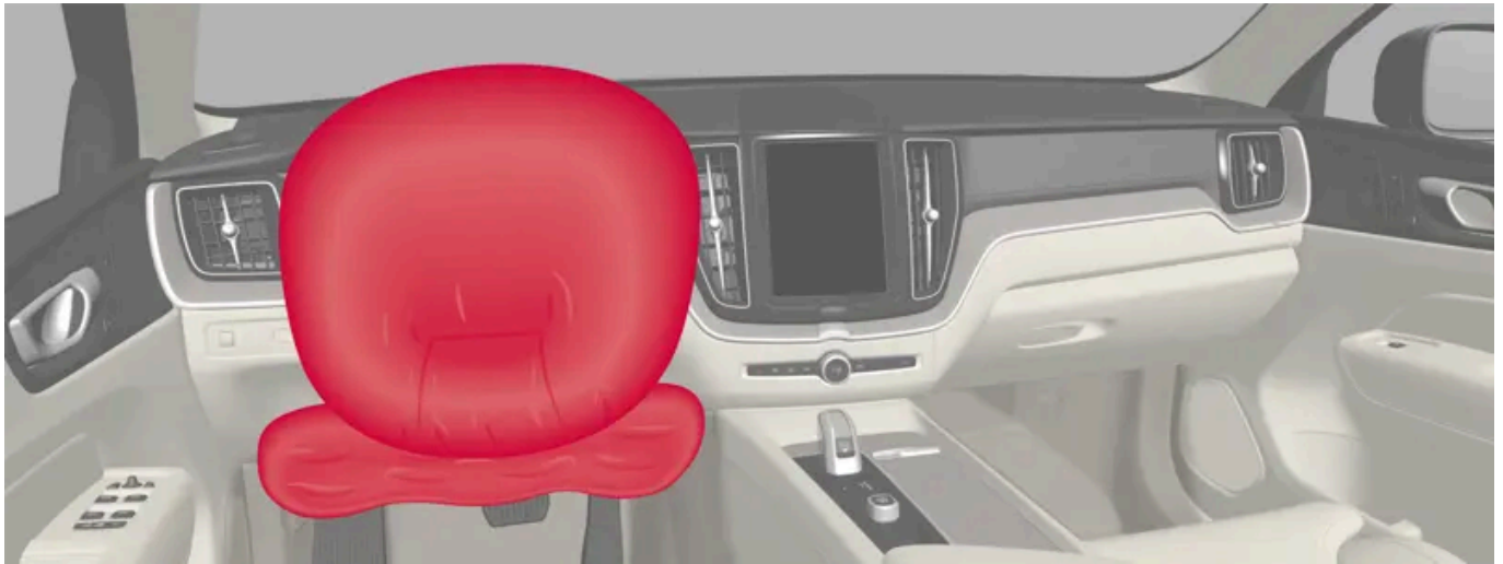
Lenkrad-Airbag und Knie-Airbag [1] am Fahrersitz.
