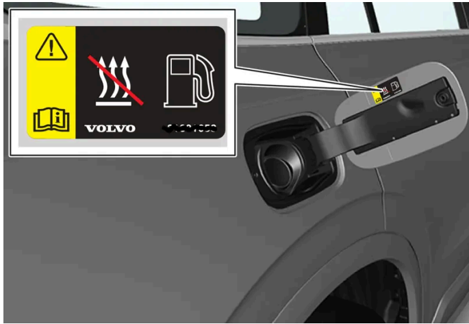
Warnaufkleber auf der Kraftstofftankklappe.
