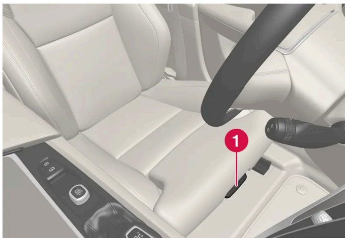
Schalter zur Längenverstellung des Sitzpolsters.
