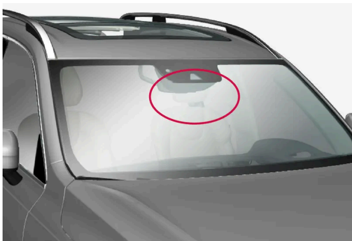
Anordnung der vorderen Kameraeinheit
