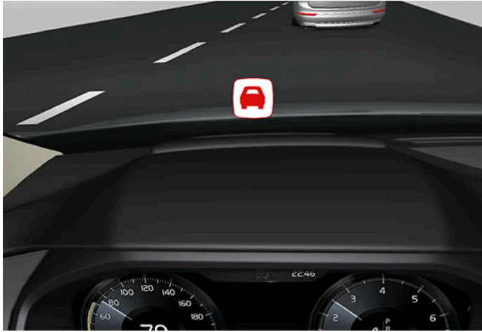
Symbol der Aufprallwarnung auf der Windschutzscheibe
