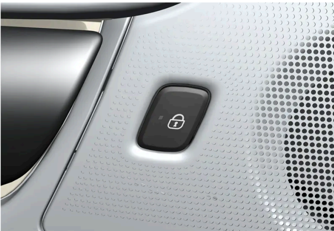
Verriegelungstaste mit Anzeigeleuchte an der Fondtür.
