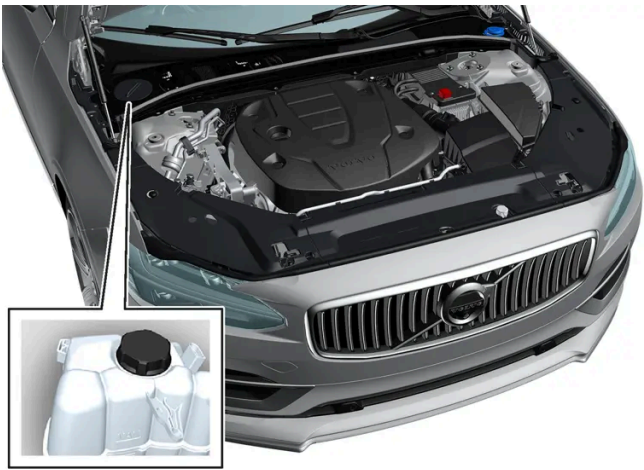
Ausgleichsbehälter der Kühlanlage, Linkslenker.
