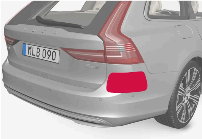
Platzierung der hinteren Radareinheiten
