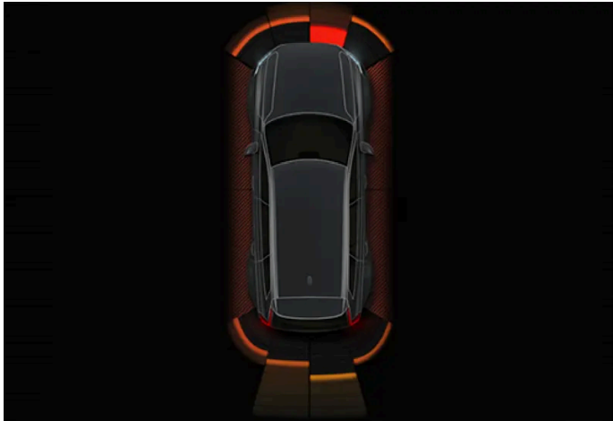
Beispiel zur Displaydarstellung mit Hinderniszonen und Sensorsektoren.
