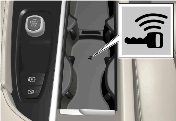
Lage des Schlüssellesegeräts in der Tunnelkonsole.
