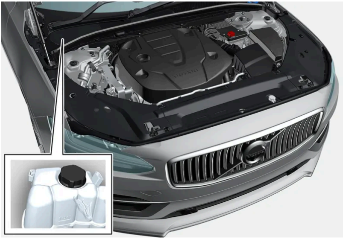
Ausgleichsbehälter der Kühlanlage, Rechtslenker.
