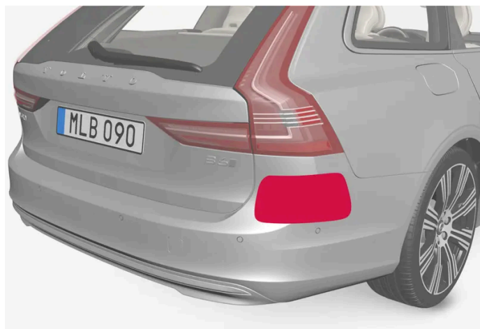
Platzierung der hinteren Radareinheiten
