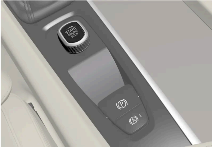
Startschalter auf der Tunnelkonsole.
