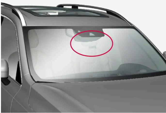
Lage des vorderen Kameramoduls
