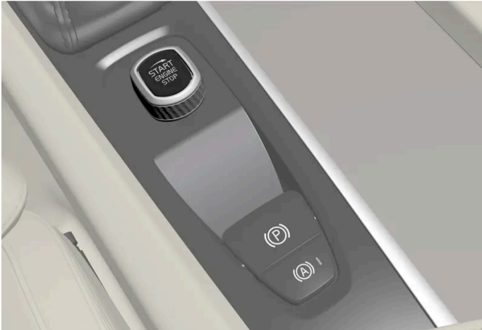
Startschalter auf der Tunnelkonsole.
