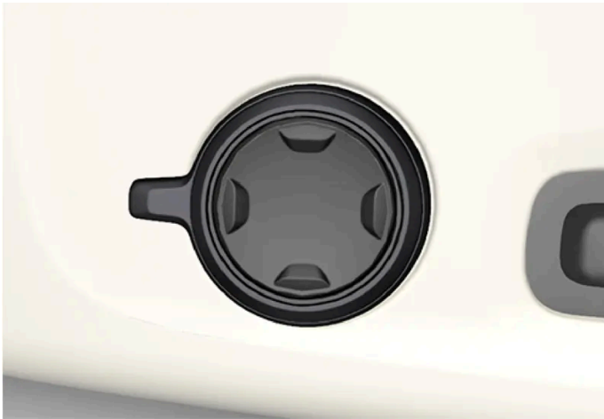
Seitlich am Sitzpolster angebrachter Multifunktionsschalter.
