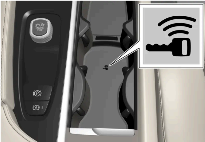
Lage des Schlüssellesegeräts in der Tunnelkonsole.
