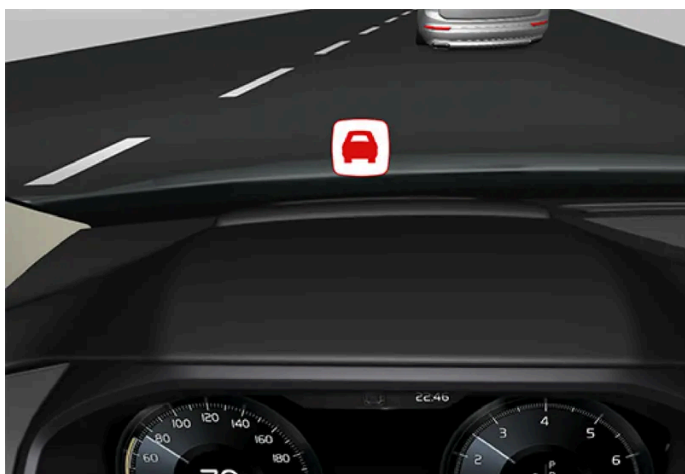
Symbol der Aufprallwarnung auf der Windschutzscheibe
