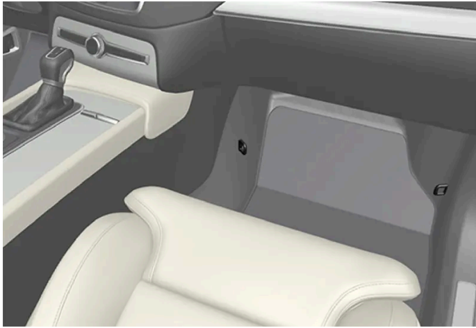
Lage der Befestigungspunkte für den Vordersitz
