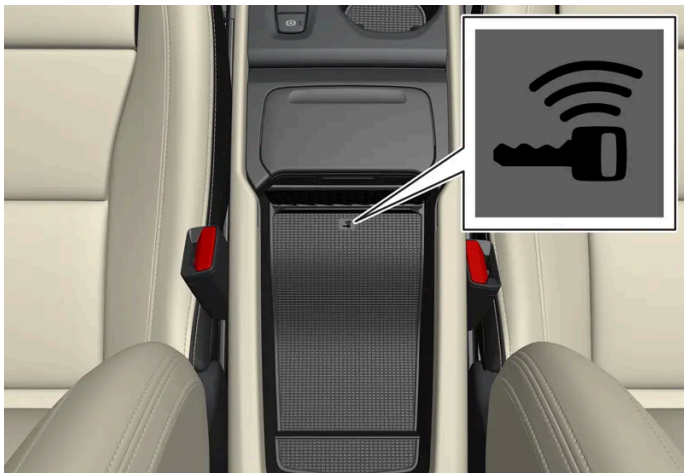
Lage des Schlüssellesegeräts an der Tunnelkonsole.
