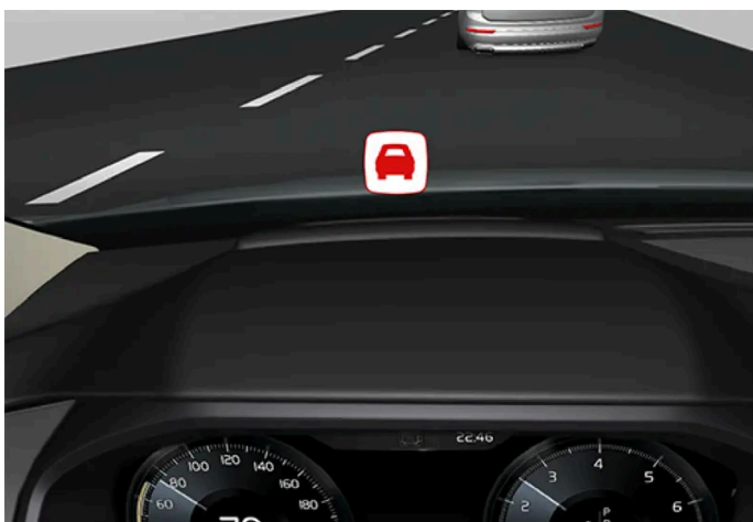
Symbol der Aufprallwarnung auf der Windschutzscheibe
