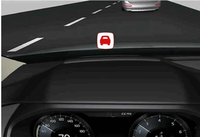
Symbol der Aufprallwarnung auf der Windschutzscheibe
