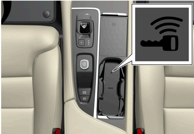
Lage des Schlüssellesegeräts an der Tunnelkonsole.
