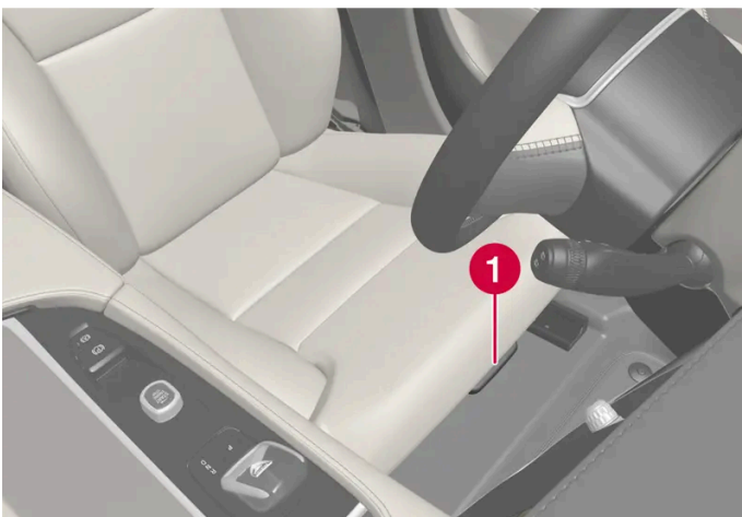
Schalter zur Längenverstellung des Sitzpolsters.
