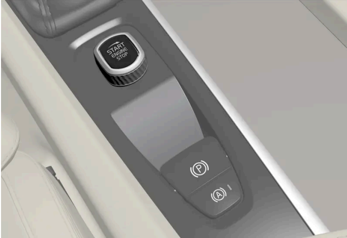
Startschalter auf der Tunnelkonsole.
