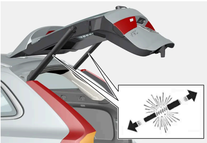
Vorgespannte Federn der elektrisch betätigten Heckklappe.
