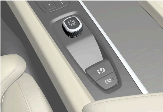
Startschalter auf der Tunnelkonsole.
