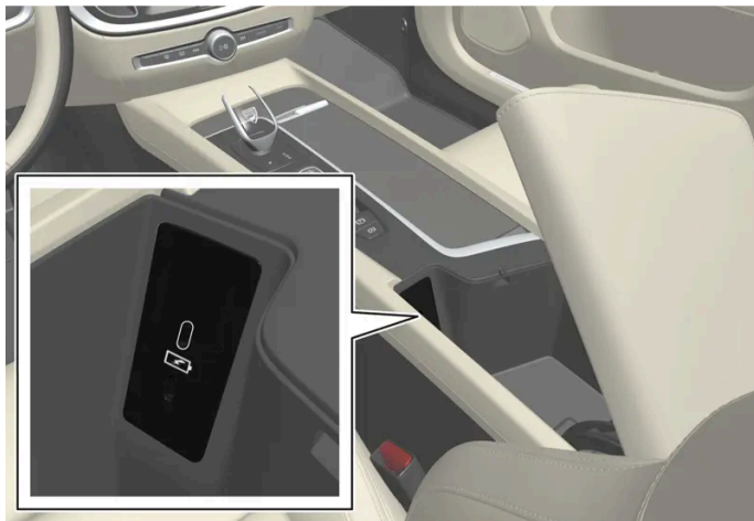
USB-Anschlüsse (Typ C), Vordersitz.
