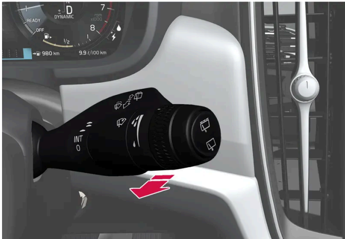
Waschfunktion, rechter Lenkradhebel.
