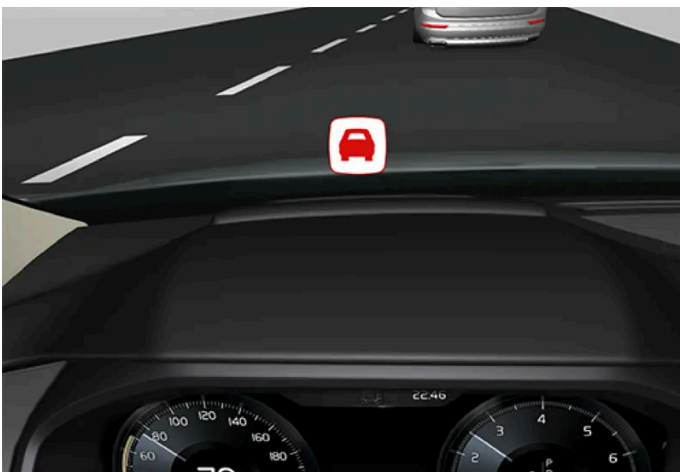
Symbol der Aufprallwarnung auf der Windschutzscheibe
