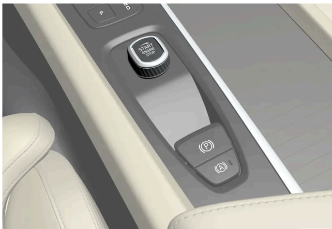
Startschalter auf der Tunnelkonsole.
