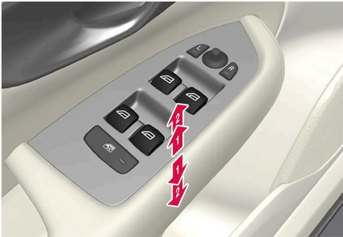
Betätigung der Fensterheber.
