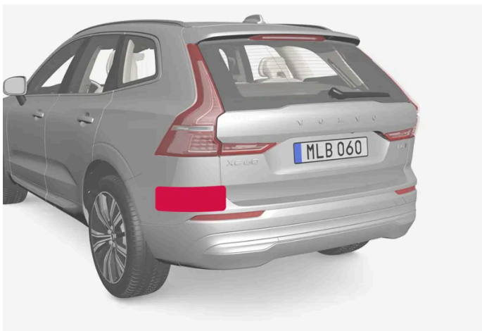
Platzierung der hinteren Radareinheiten
