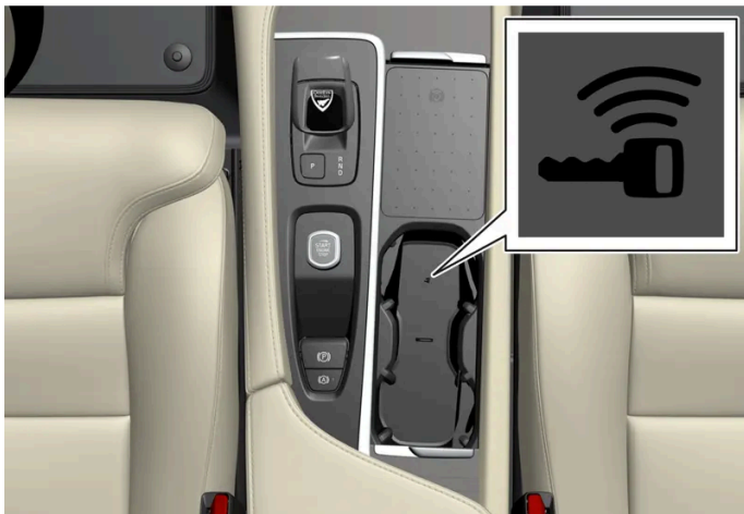
Lage des Schlüssellesegeräts an der Tunnelkonsole.
