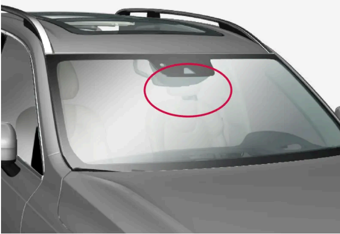
Lage des vorderen Kameramoduls
