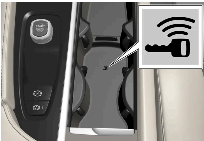
Lage des Schlüssellesegeräts in der Tunnelkonsole.
