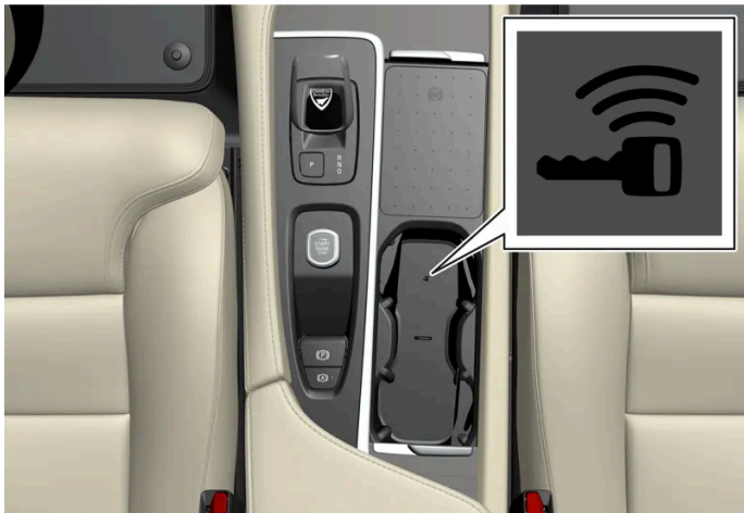
Lage des Schlüssellesegeräts an der Tunnelkonsole.
