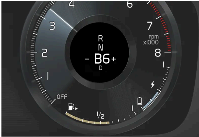
Schaltanzeige im Fahrerdisplay [1] .
