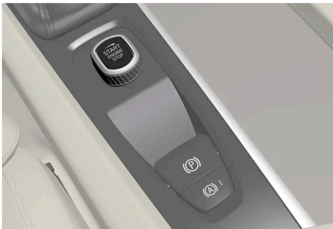
Startschalter auf der Tunnelkonsole.
