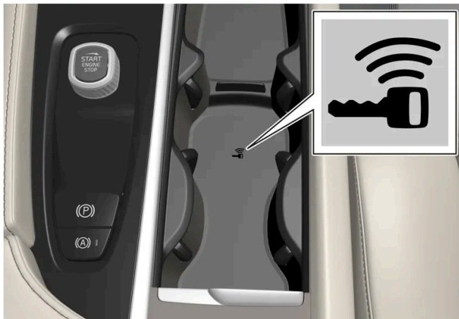
Lage des Schlüssellesegeräts an der Tunnelkonsole.
