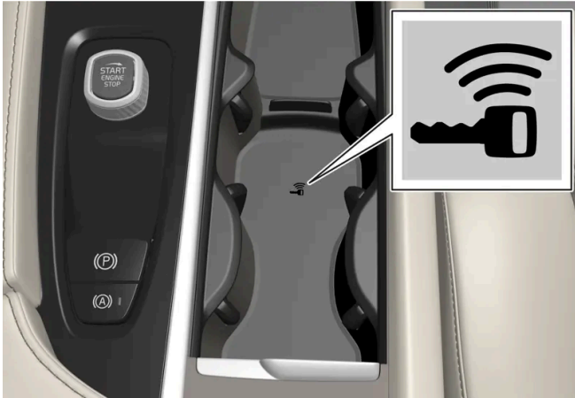
Lage des Schlüssellesegeräts an der Tunnelkonsole.
