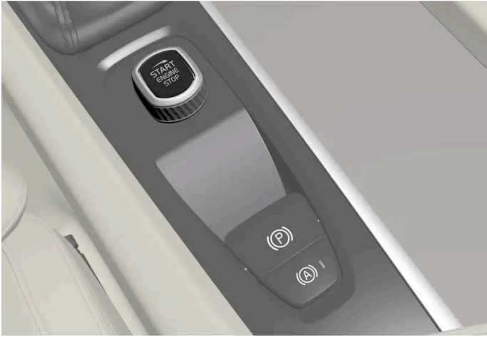
Startschalter auf der Tunnelkonsole.
