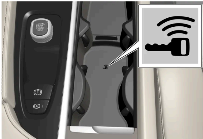
Lage des Schlüssellesegeräts an der Tunnelkonsole.
