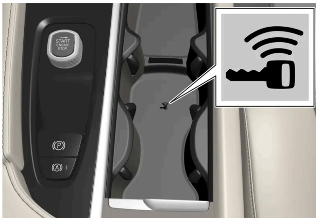
Lage des Schlüssellesegeräts an der Tunnelkonsole.
