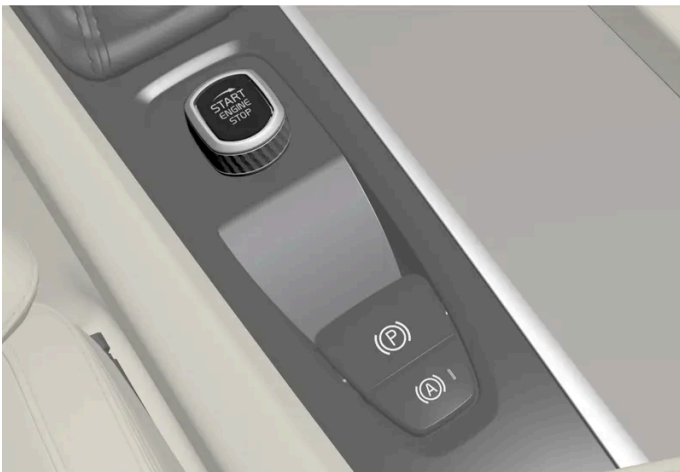
Startschalter auf der Tunnelkonsole.
