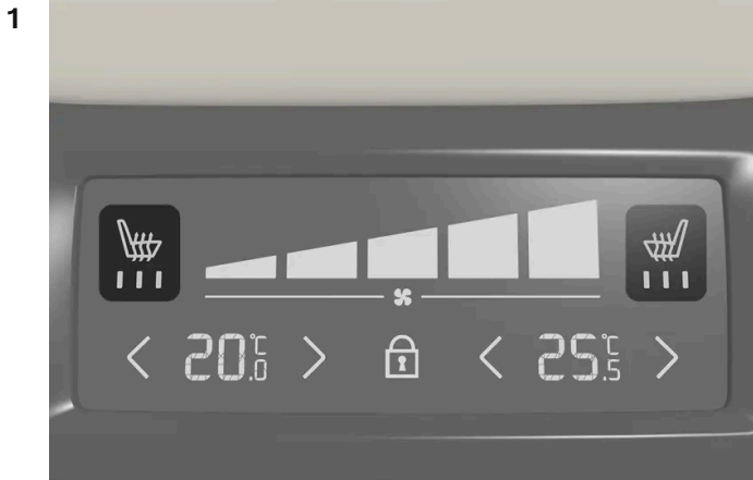
Anzeige und Bedienfeld der Sitzheizung auf dem hinteren Klima-Bedienfeld an der Tunnelkonsole.
