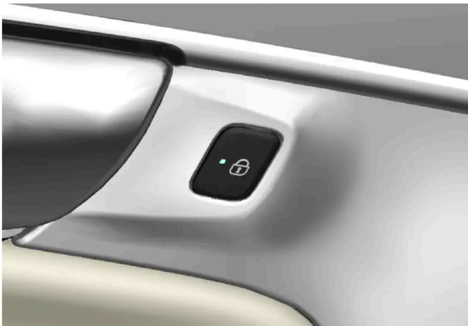
Verriegelungstaste mit Anzeigeleuchte an der Hintertür.
