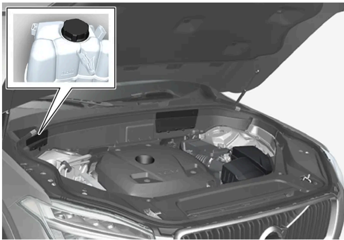
Ausgleichsbehälter für die Kühlanlage
