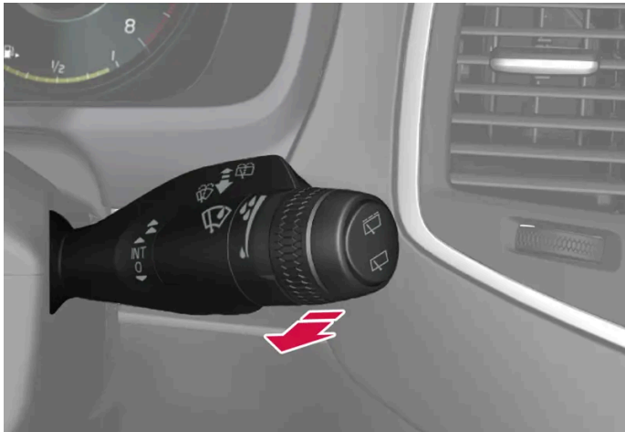
Waschfunktion, rechter Lenkradhebel.
