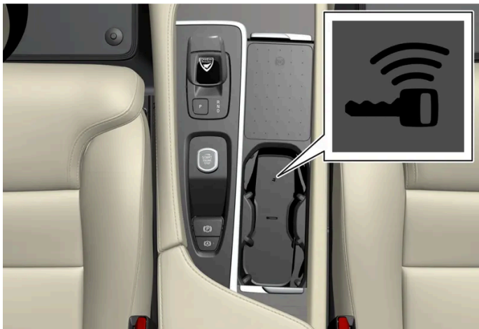
Lage des Schlüssellesegeräts an der Tunnelkonsole.
