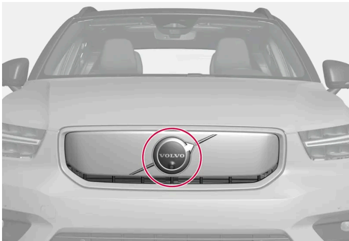
Anordnung der vorderen Radareinheit
