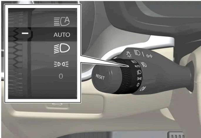
Drehring am Lenkradhebel in Stellung AUTO .
