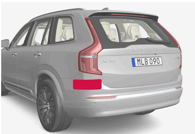
Platzierung der hinteren Radareinheiten
