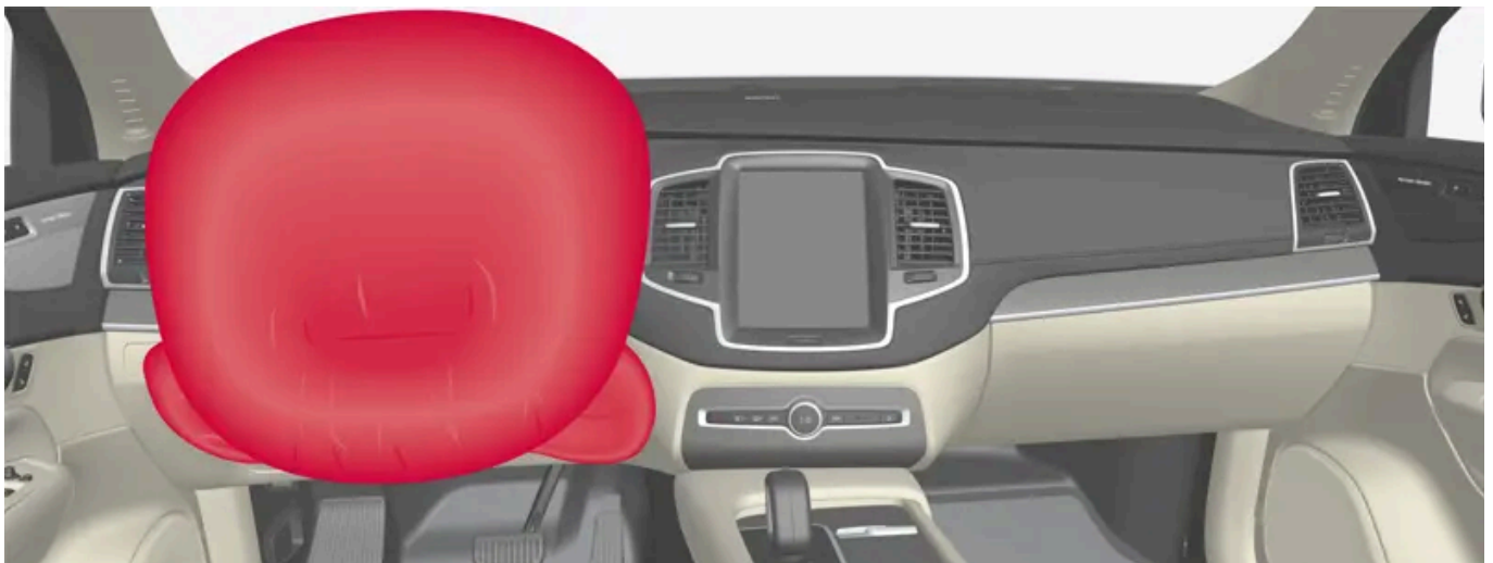
Lenkrad-Airbag und Knie-Airbag am Fahrersitz.
