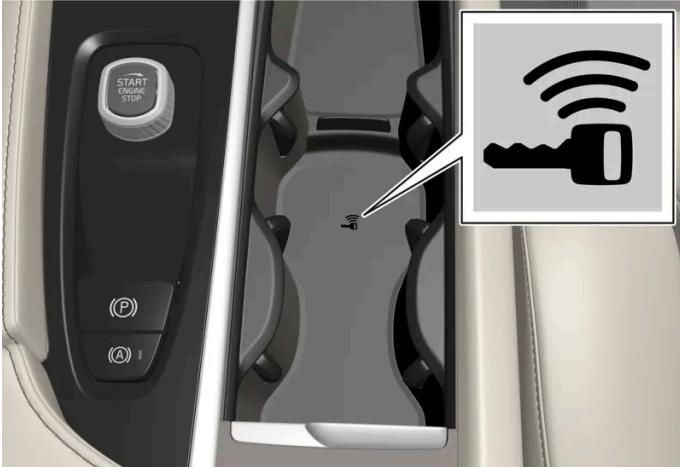
Lage des Schlüssellesegeräts in der Tunnelkonsole.
