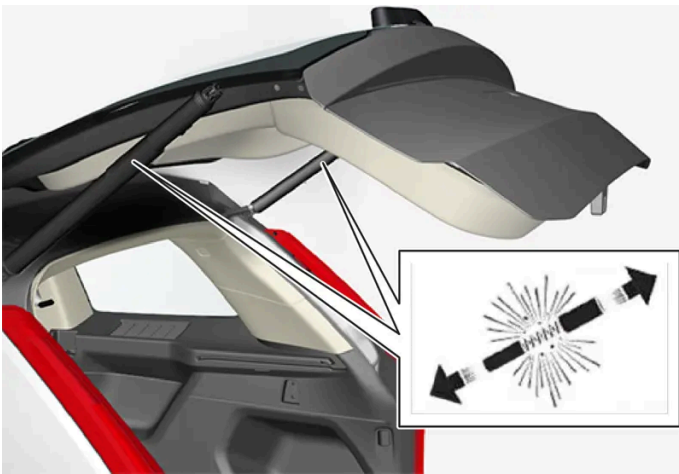
Vorgespannte Federn der elektrisch betätigten Heckklappe.
