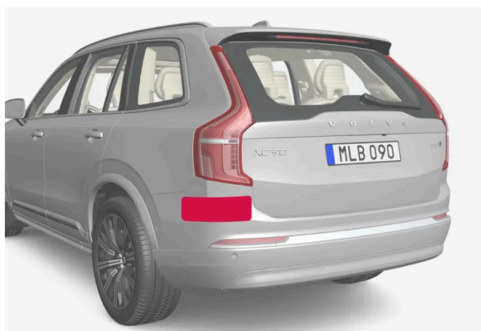
Lage der hinteren Radarmodule
