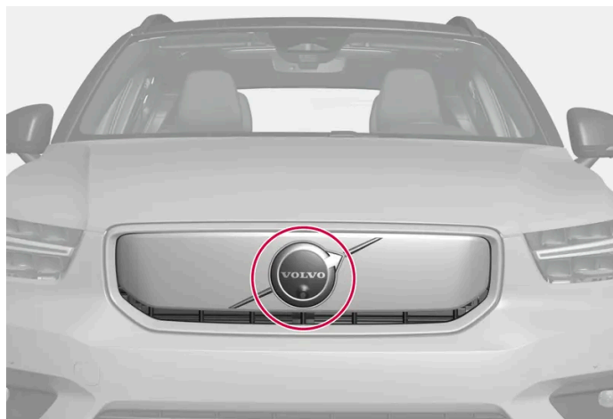
Lage des vorderen Radarmoduls
