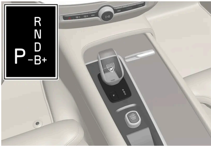
Wählhebel und Schaltmuster auf dem Fahrerdisplay.
