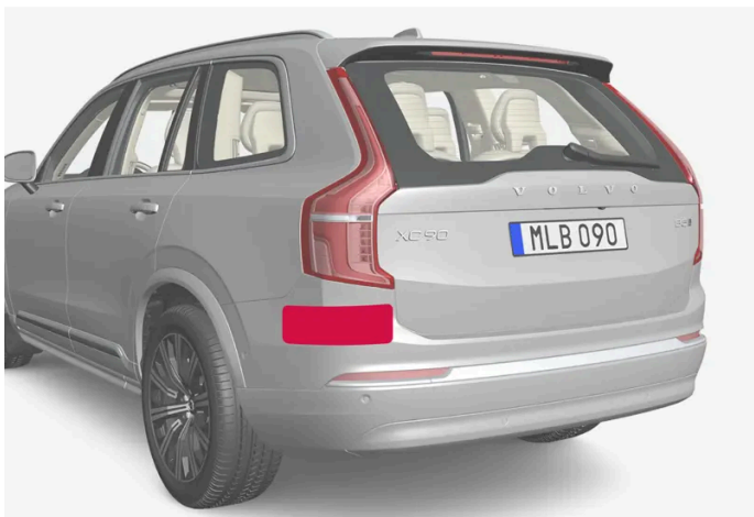
Platzierung der hinteren Radareinheiten
