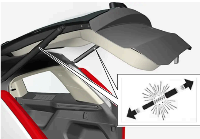
Vorgespannte Federn der elektrisch betätigten Heckklappe.
