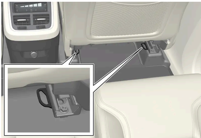
Lage der Befestigungspunkte in der zweiten Sitzreihe.
