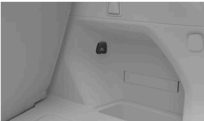
Die 12-V-Steckdose an der rechten Kofferraumwand
