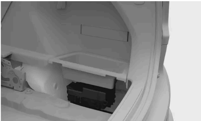
Lage des Sicherungskastens
