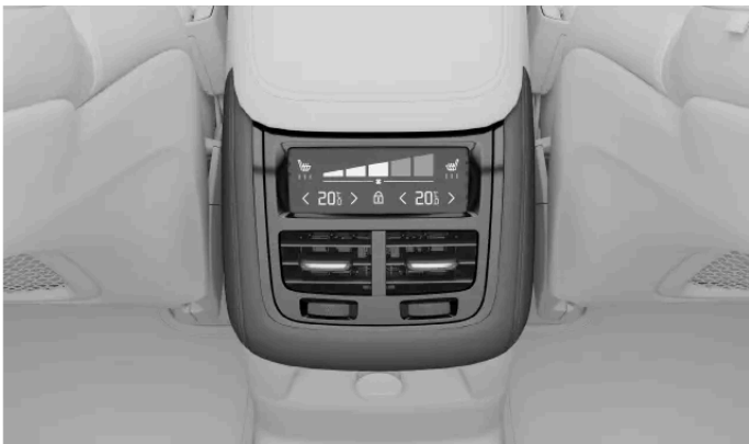
Bedienelemente der Klimaanlage an der Tunnelkonsole
