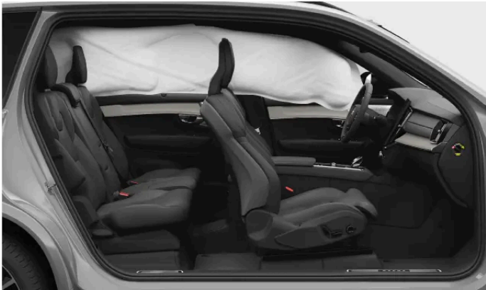
Auf einer Seite des Fahrzeugs ausgelöster Kopf-/Schulterairbag.
