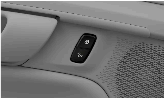
Zentralverriegelungstaste an der Vordertür
