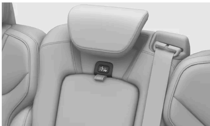
Verriegelungstaste an der mittleren Kopfstütze
