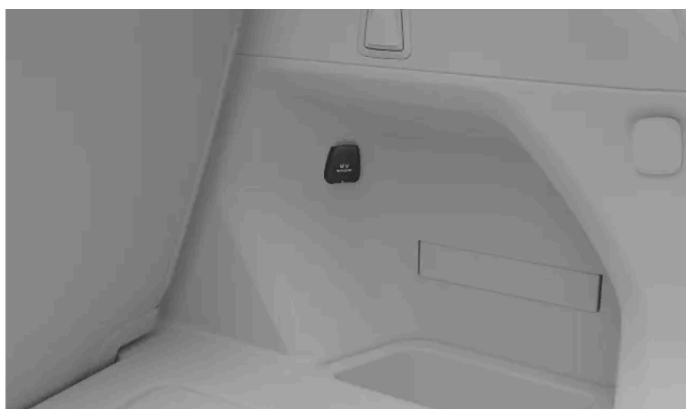
Die 12-V-Steckdose an der rechten Kofferraumwand
