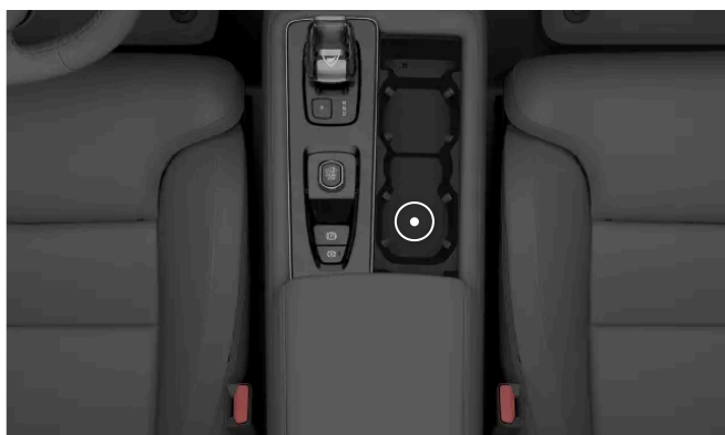
Position des Backup-Lesegeräts im Becherhalter der Tunnelkonsole
