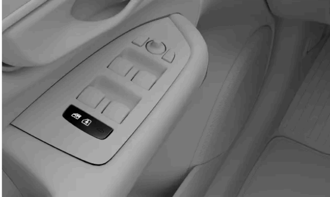
Position der Kindersicherungstaste in der Türverkleidung
