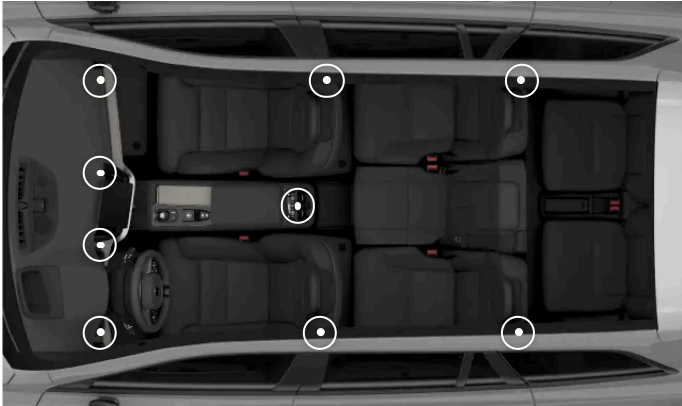
Lage der verstellbaren Lüftungsdüsen
