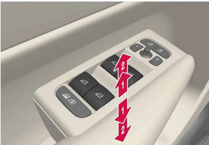
Accionamiento de los elevallas electricos.
