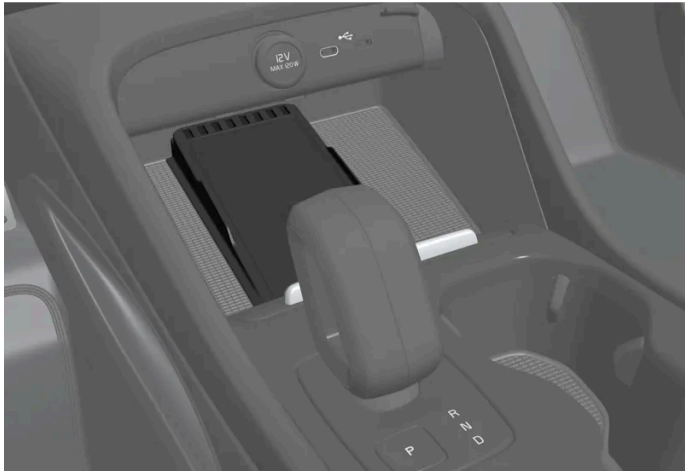
Cargador de teléfono inalámbrico delante de la palanca de cambios
