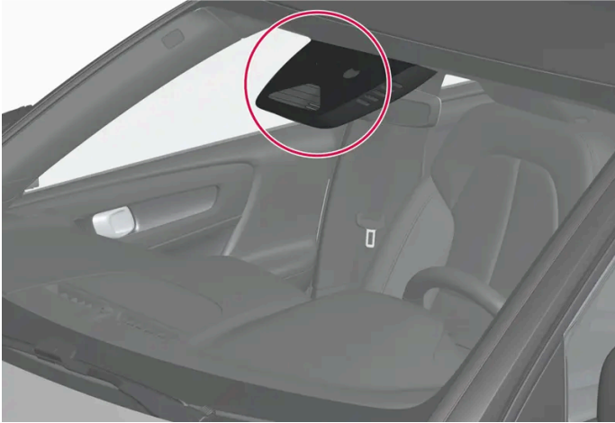
Ubicación de la unidad de cámara
