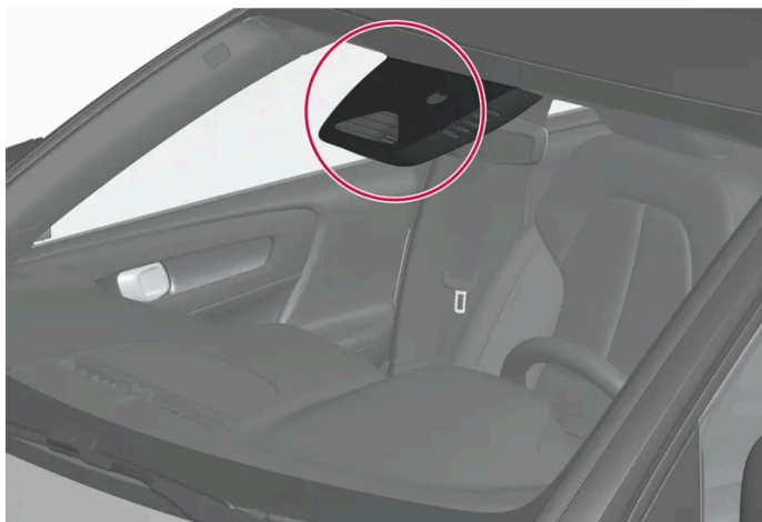
Ubicación de la unidad de cámara
