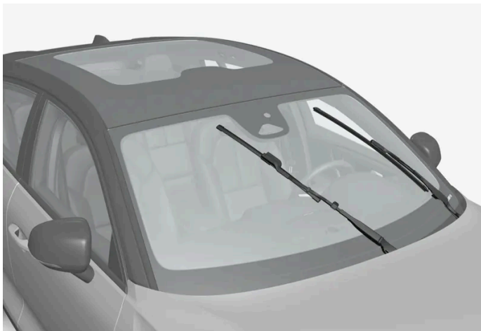
Escobillas de limpiaparabrisas en posición de servicio.
