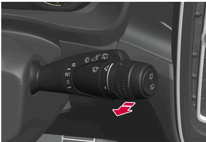
Función de lavado, palanca derecha del volante.
