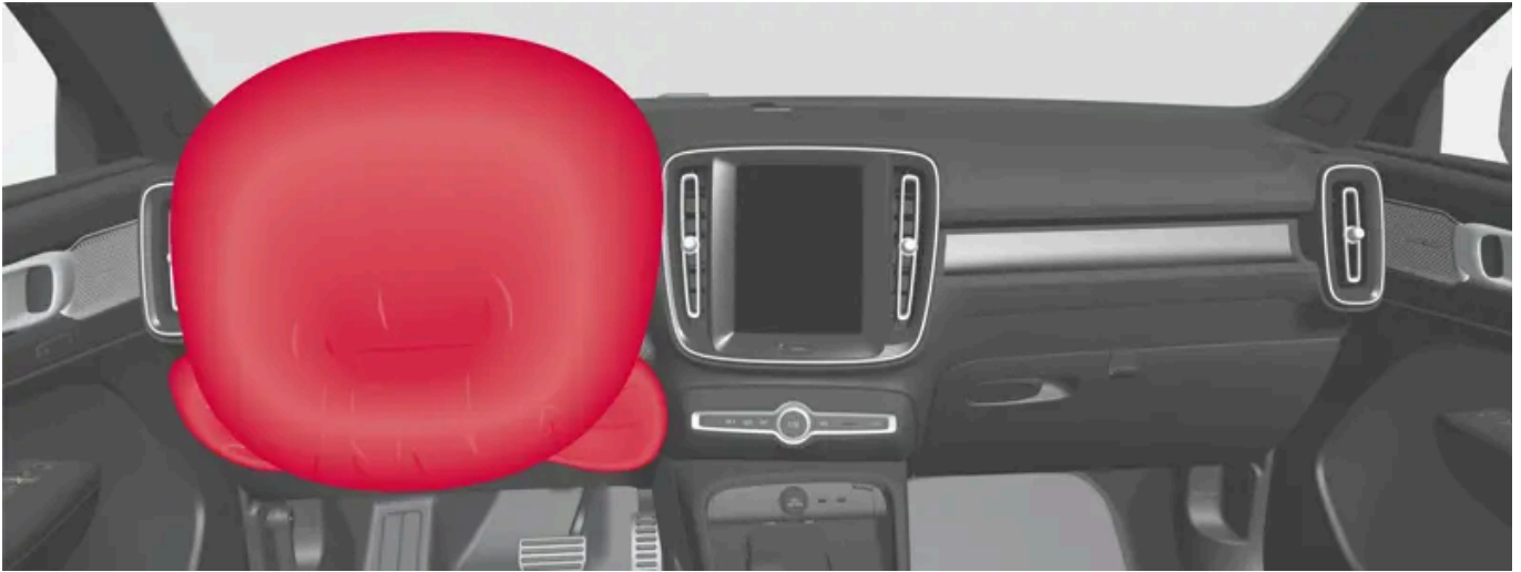
Airbag del volante y airbag de rodillas [1] en el lado del conductor del asiento delantero.
