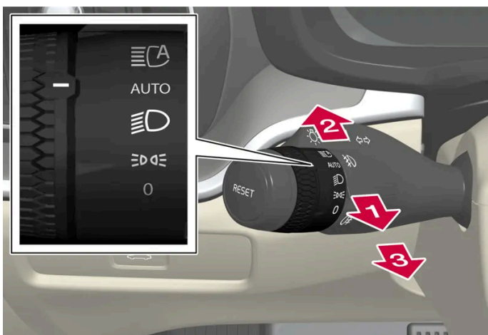
Palanca del volante con mando giratorio.
