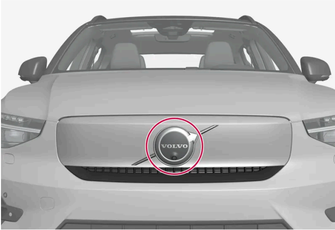
Ubicación de la unidad delantera de radar
