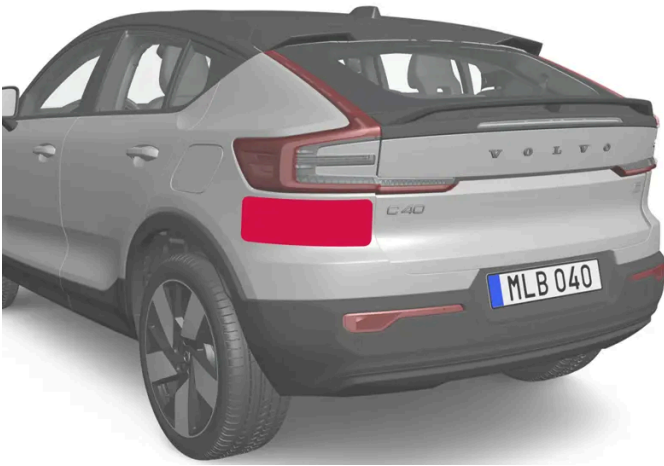
Ubicación de unidades de radar traseras
