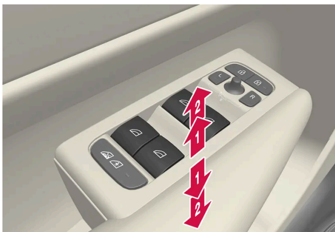
Accionamiento de los elevavinas eléctricos.
