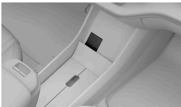
El lector de tarjetas situado entre los asientos delanteros también es un cargador inalámbrico.
