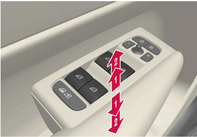
Accionamiento de los elevallas eléctricos.
