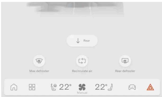
Posición del botón de las luces de emergencia en la pantalla central
