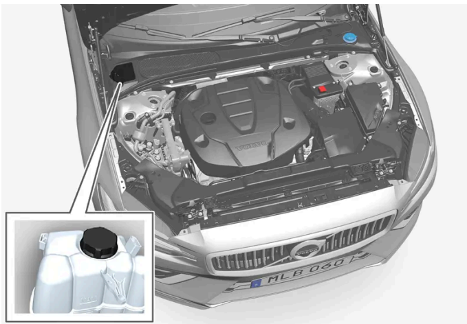
Deposito de expansión del sistema de refrigeración
