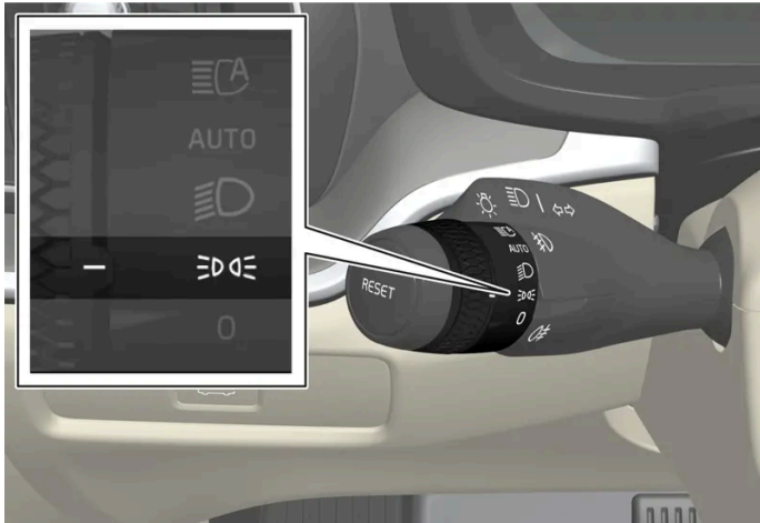
Control giratorio del volante en la posición de las luces de posición
