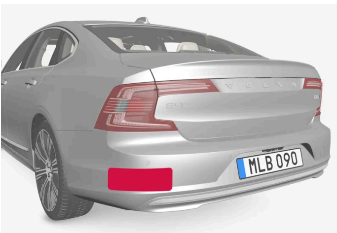
Ubicación de unidades de radar traseras
