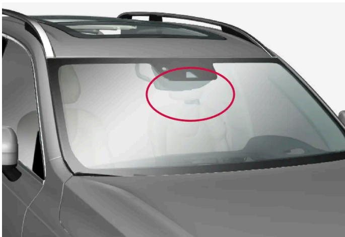
Ubicación de la unidad de cámara delantera
