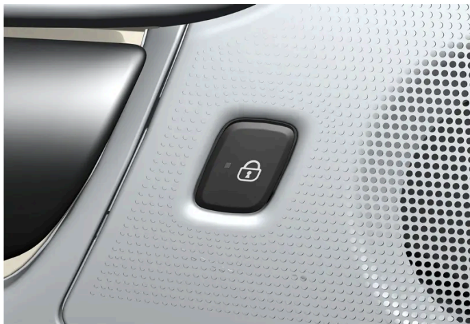
Botón de bloqueo en la puerta trasera con luz de indicación.
