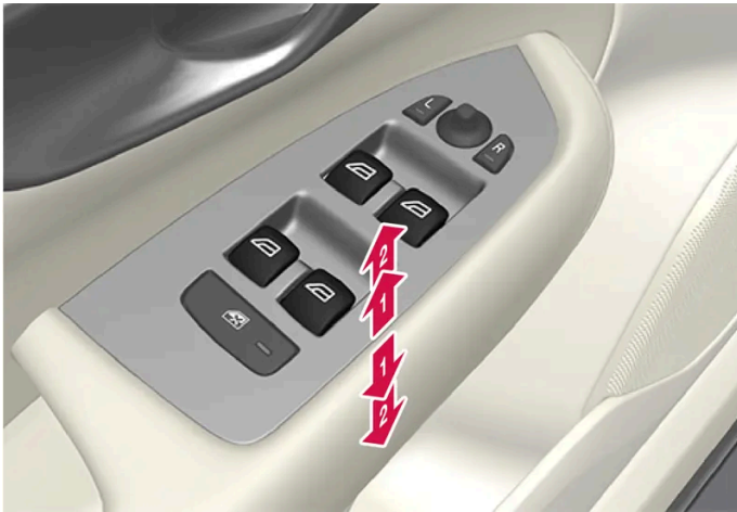
Accionamiento de los elevalunas eléctricos.
