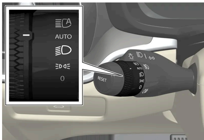
Mando giratorio de palanca izquierda del volante.
