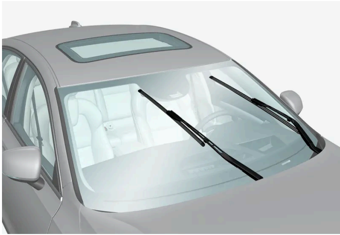
Escobillas de limpiaparabrisas en posición de servicio.
