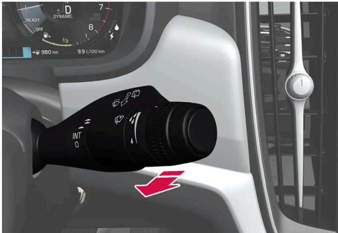
Función de lavado, palanca derecha del volante.
