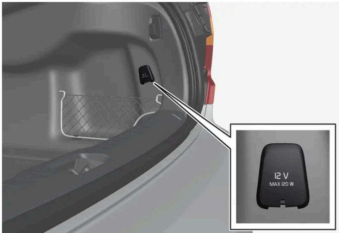
Toma eléctrica de 12 V en el maletero o el compartimento de carga*.
