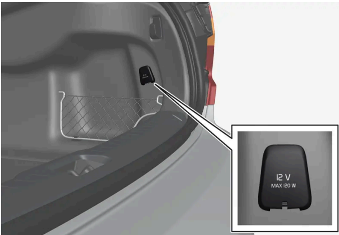
Toma eléctrica de 12 V en el maletero o el compartimento de carga*.
