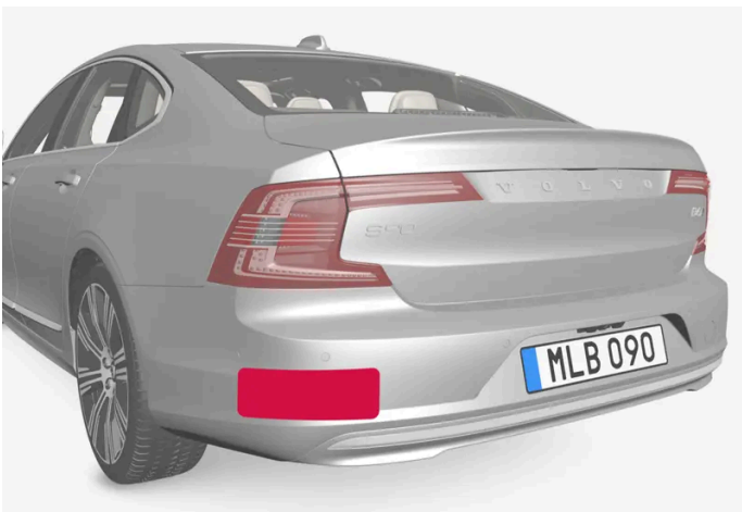
Ubicación de unidades de radar traseras
