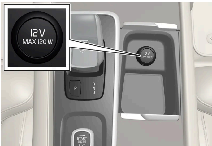
Toma eléctrica delantera de la consola del túnel en vehículos sin cargador de teléfono inalámbrico*.
