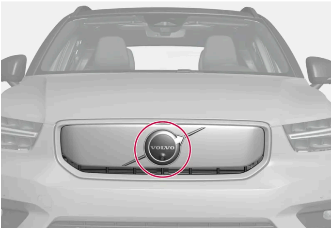
Ubicación de la unidad delantera de radar
