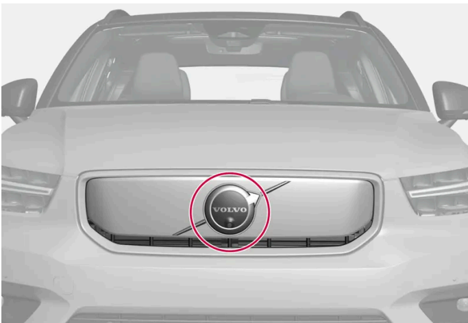
Ubicación de la unidad delantera de radar
