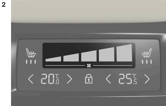
Control de ventilación en el panel de climatización de la consola del túnel.
