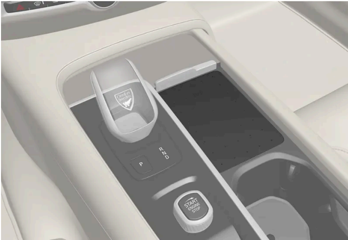
Cargador inalámbrico en la consola del túnel.
