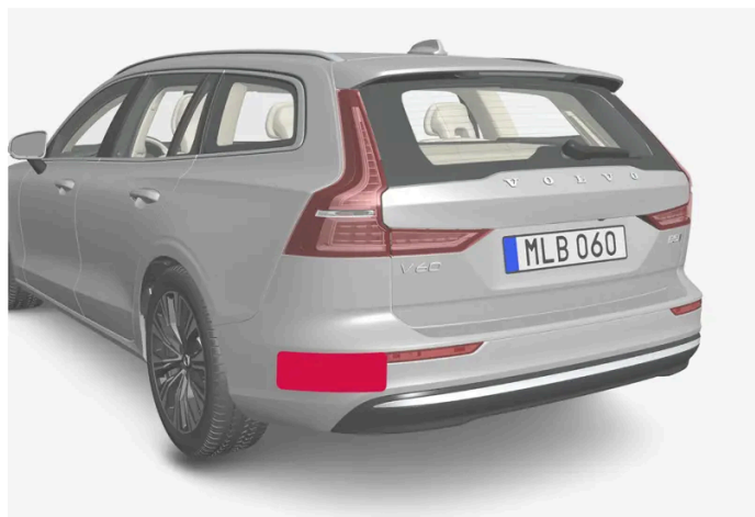
Ubicación de unidades de radar traseras
