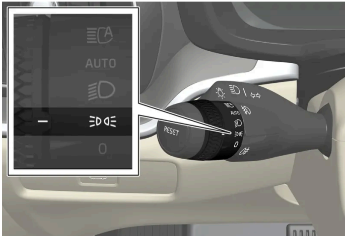
Control giratorio del volante en la posición de las luces de posición
