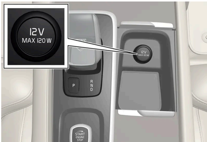
Toma eléctrica delantera de la consola del túnel en vehículos sin cargador de teléfono inalámbrico*.
