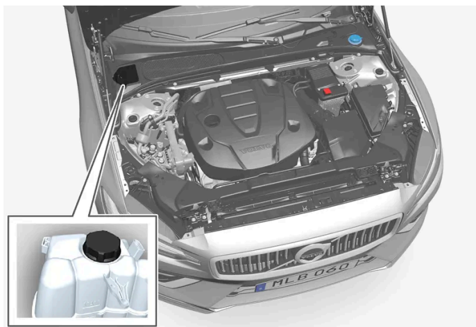
Deposito de expansión del sistema de refrigeración
