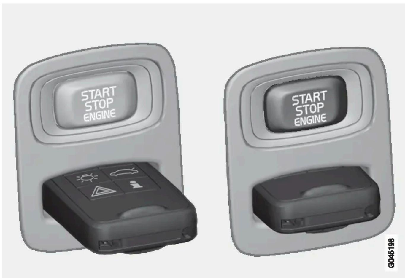
Cerradura de contacto con llave extraída o apretada y botón START/STOP ENGINE.
