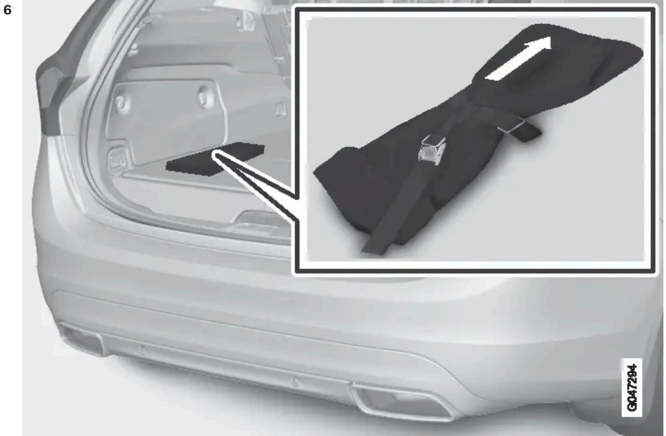
La flecha blanca debe señalar hacia la parte delantera del vehículo.
