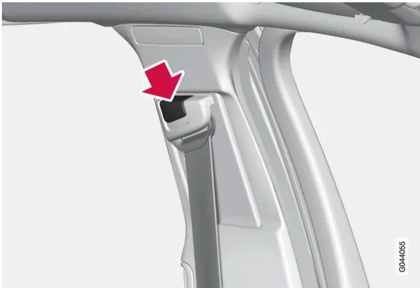
Ajuste vertical del cinturón de seguridad. Pulse el botón para desplazar el cinturón verticalmente. Coloque el cinturón lo más alto posible sin que roce con el cuello.
