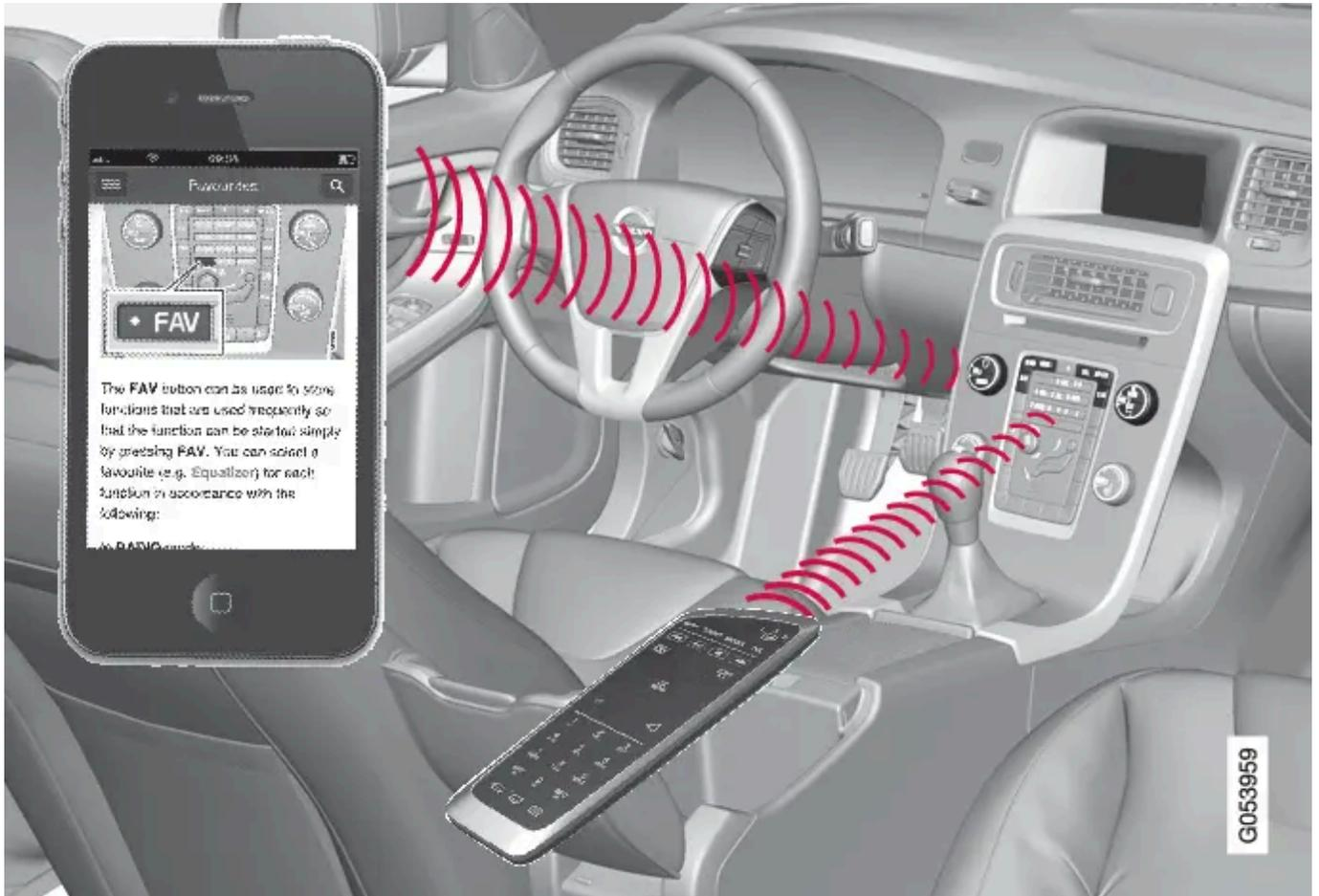
Si el sistema audiovisual está conectado cuando se apaga el motor, se conectará automáticamente cuando la llave vuelve a colocarse en la posición I o superior y seguirá emitiendo la fuente (por ejemplo, radio) que estaba activa cuando se apagó el motor (la puerta del conductor debe estar cerrada en automóviles con sistema Keyless\*).
