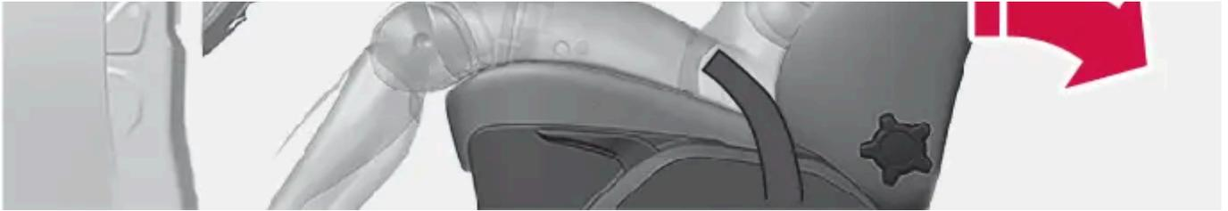
El sistema WHIPS se activa durante una colisión por alcance en función del ángulo de incidencia, la velocidad y las características del vehículo con el que se choca.
