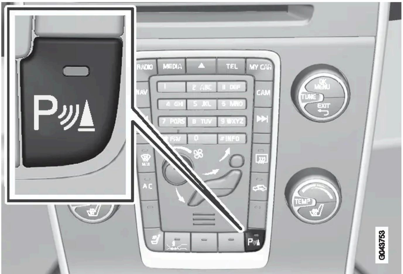
Conexión y desconexión del aparcamiento asistido y el CTA\*.
