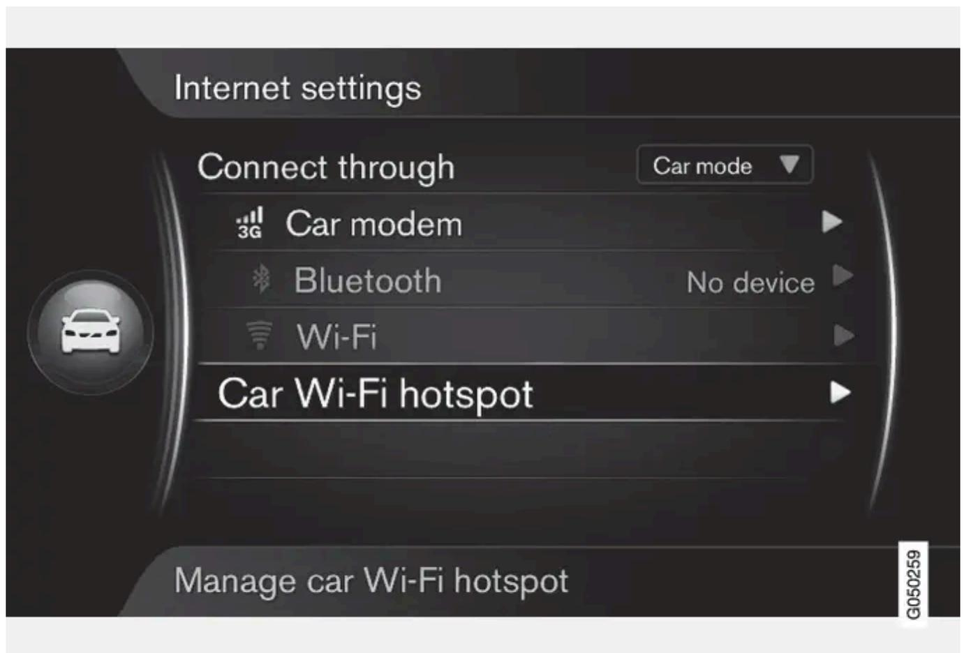
Cuando el automóvil está conectado a Internet a través del módem de vehículo, podrá compartirse la conexión a Internet (punto de acceso Wi-Fi) para que otras unidades usen del módem.
