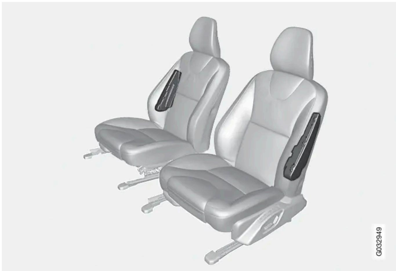
El sistema SIPS-bag consta de dos componentes principales, airbag lateral y sensores. El airbag lateral va colocado en el bastidor del respaldo del asiento delantero.
