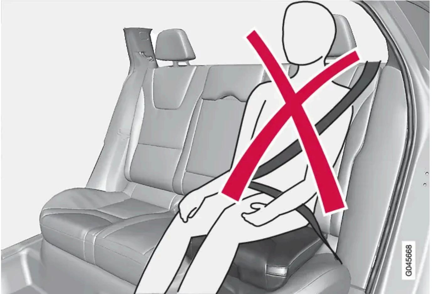
Posición incorrecta, el reposacabezas debe estar ajustado a la misma altura de la cabeza y el cinturón no debe ir debajo del hombro.
