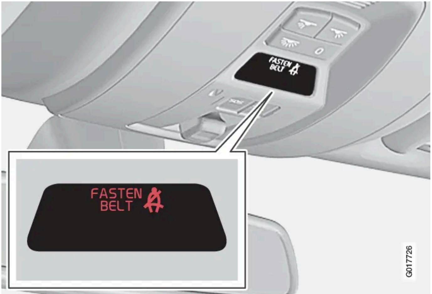
El aviso acústico depende de la velocidad y, en algunos casos, del tiempo. La señal luminosa se puede ver en la consola del techo y en el [cuadro de instrumentos](#).
