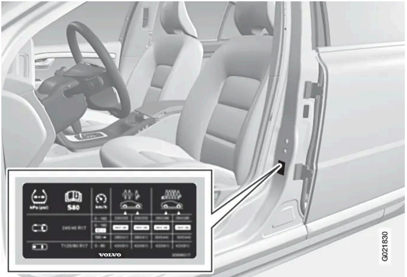
La placa de presión de inflado en el pilar de la puerta del conductor (entre la puerta delantera y la trasera) indica la presión de inflado para las dimensiones de neumáticos recomendadas para el vehículo. Estos datos se indican también en la tabla de presiones de neumáticos, véase [Neumáticos - presiones de inflado aprobadas](#).
