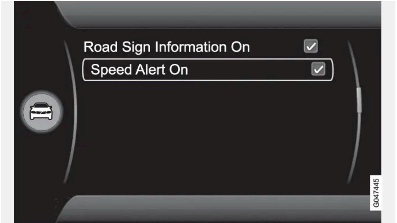
El conductor puede optar por recibir una advertencia en caso de rebasar el límite de velocidad vigente en 5 km/h o más. La advertencia se presenta a través del parpadeo temporal del símbolo con el límite de velocidad aplicable al superarse ésta. El sistema puede conectarse y desconectarse en el sistema de menús MY CAR. Para una descripción del sistema de menús, véase [MY CAR](#).
