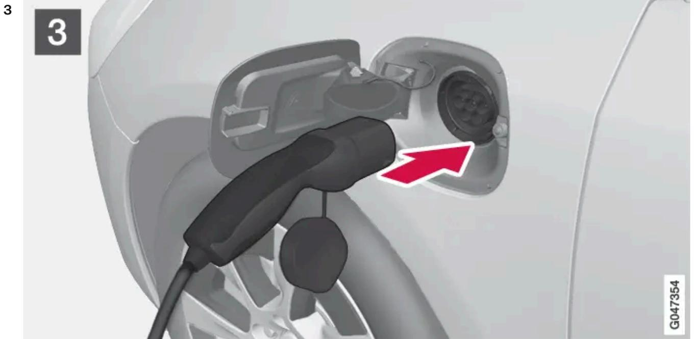
3 Retire la tapa de protección del terminal y conecte después el terminal al automóvil.
