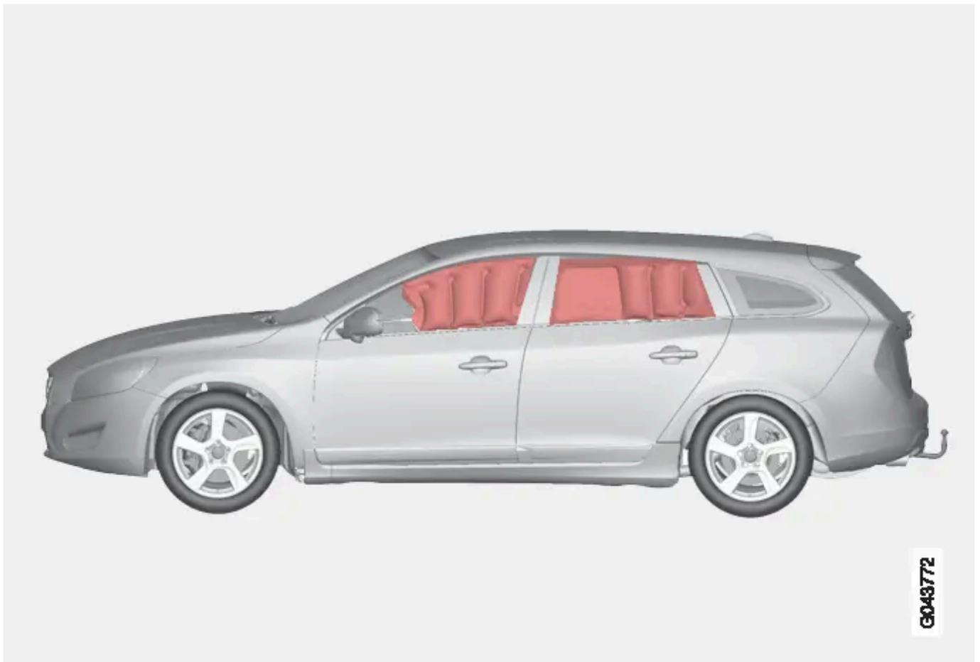
La cortina inflable IC (Inflatable Curtain) forma parte del [sistema SIPS](#) y el [sistema de airbags](#). Va montado a lo largo de ambos lados del techo interior y contribuye a proteger al conductor y a los pasajeros situados en los asientos exteriores del vehículo. En caso de una colisión de suficiente intensidad, los sensores reaccionan y el airbag de techo lateral se infla.
