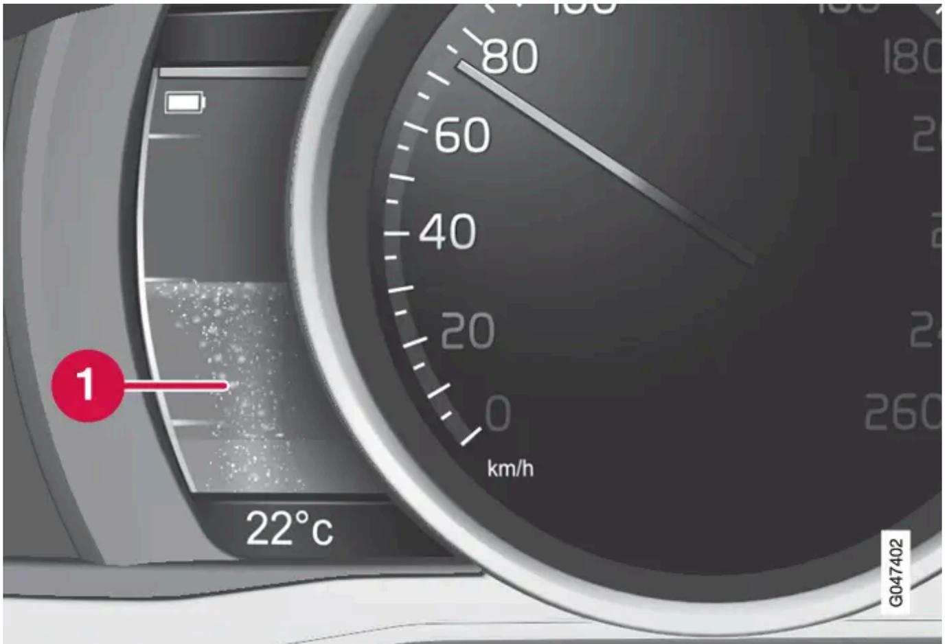
1 Cuando el motor eléctrico carga la batería híbrida, aparecen burbujas en el indicador de la batería, véase [Freno de servicio](#).
