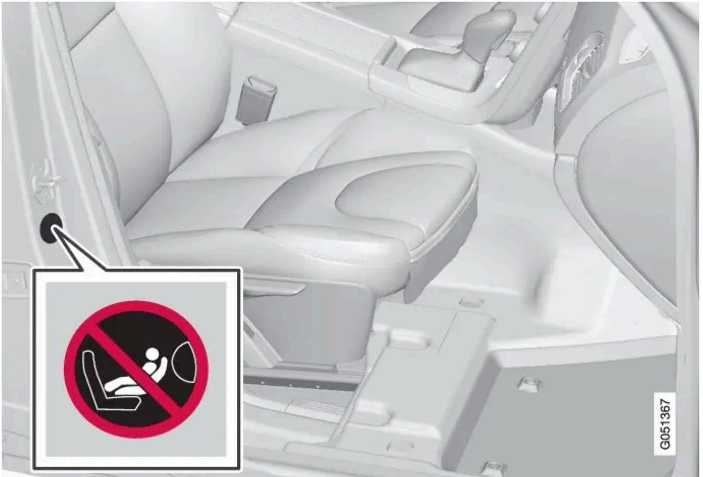
Opción 2: Placa de airbag situada en el montante de la puerta en el lado del acompañante. La placa se ve al abrir la puerta del acompañante.
