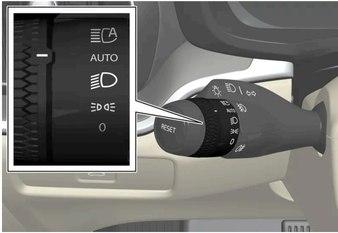
Mando giratorio de palanca izquierda del volante.
