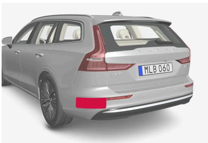
Ubicación de unidades de radar traseras
