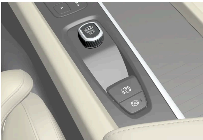
Control de arranque en la consola del túnel.
