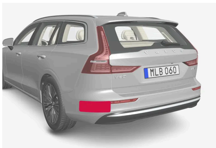
Ubicación de unidades de radar traseras
