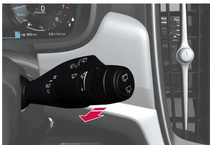
Función de lavado, palanca derecha del volante.
