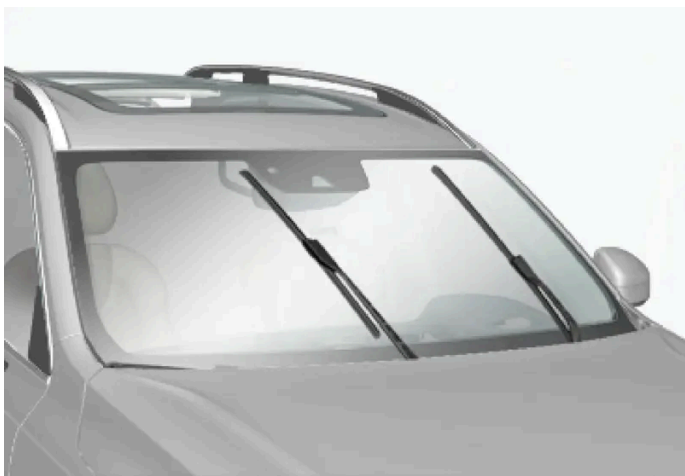
Escobillas de limpiaparabrisas en posición de servicio.
