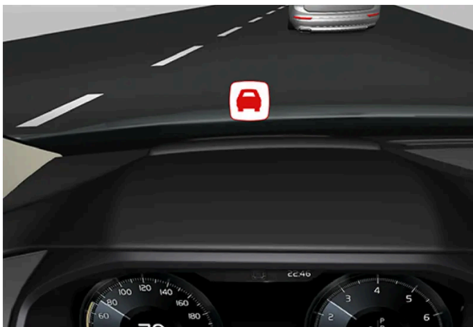
Símbolo de advertencia de colisión en el parabrisas
