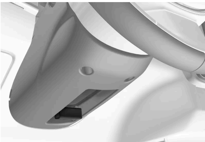
Palanca de regulación del volante.
