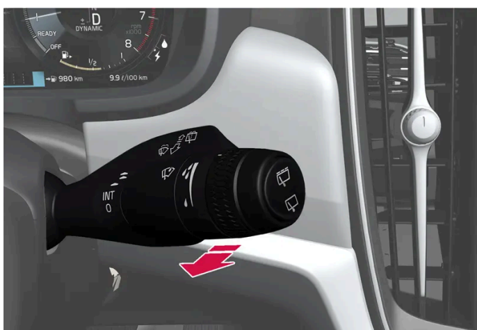
Función de lavado, palanca derecha del volante.
