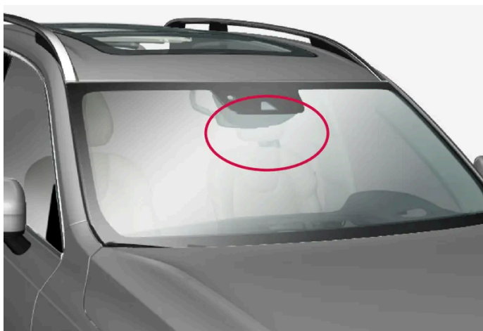
Ubicación de la unidad de cámara delantera
