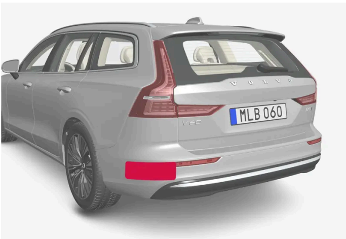
Ubicación de unidades de radar traseras
