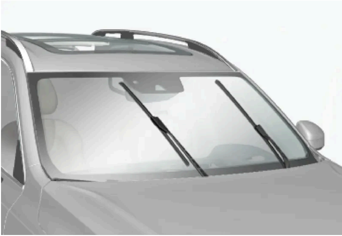
Escobillas de limpiaparabrisas en posición de servicio.
