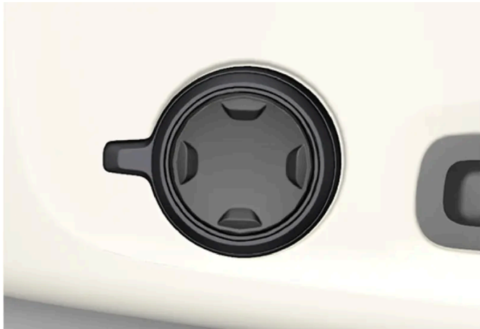
Control multifuncional, en automóviles con apoyo lumbar de cuatro direcciones*.
