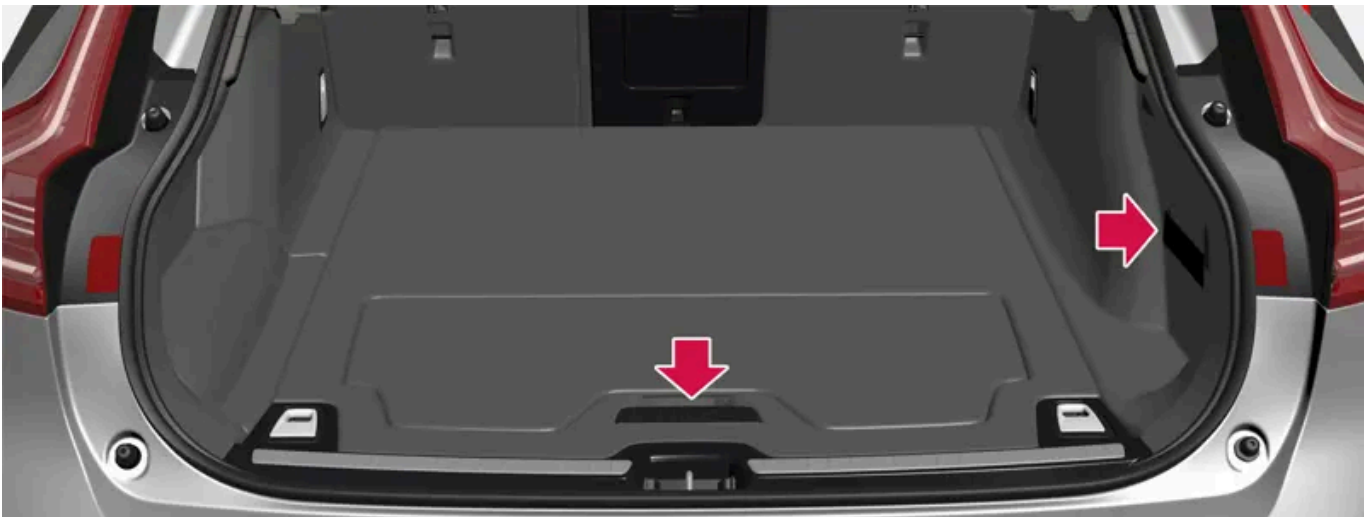
Compartimento de carga con cinta elástica y compartimento guardaobjetos bajo el piso de carga.
