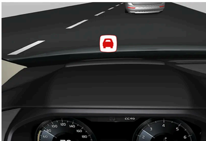
Símbolo de advertencia de colisión en el parabrisas
