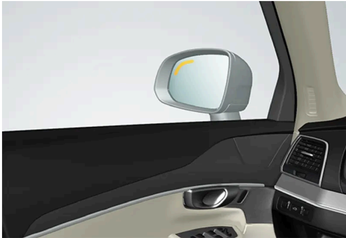
Ubicación del testigo de BLIS
