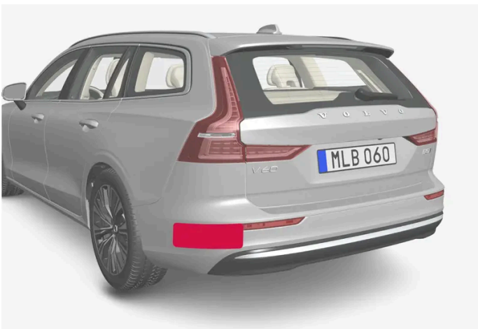
Ubicación de unidades de radar traseras
