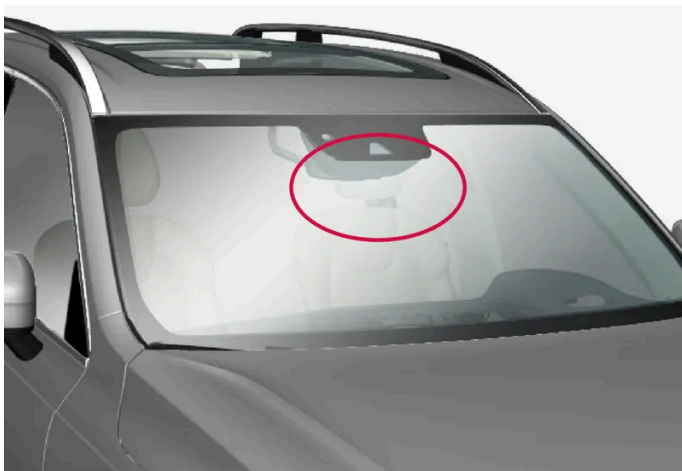
Ubicación de la unidad de cámara delantera
