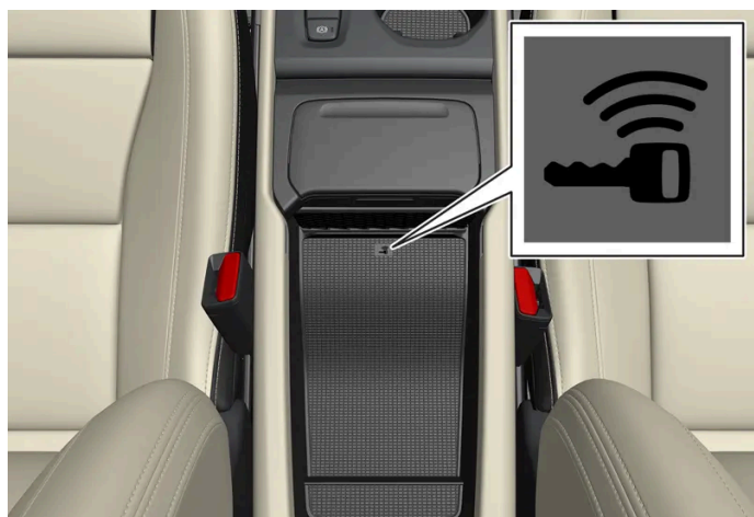
Ubicación del lector de seguridad en la consola del túnel.
