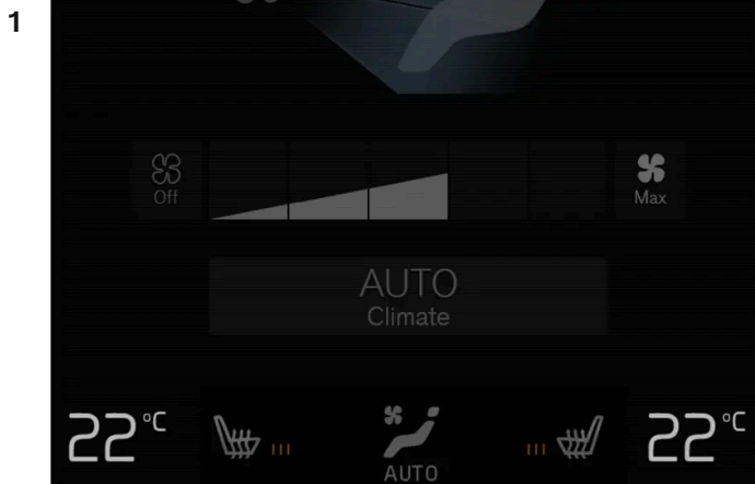
Botones de temperatura en el área de climatización.
