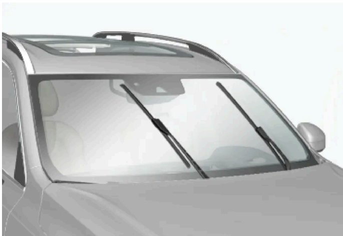
Escobillas de limpiaparabrisas en posición de servicio.
